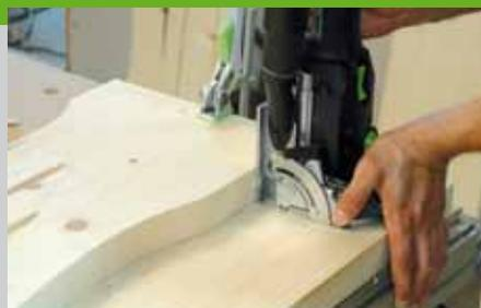
das Dübelloch mit exakter Breite (Frästiefe 25 mm) in die Mittelseite. Stellen Sie dann die Dübelfräse senkrecht auf die Seite und fräsen Sie das Gegenloch. Markieren Sie weiter oben an der Mittelseite die Position des zweiten Verbinders und fräsen Sie die beiden Löcher mit der zweiten Breiten-einstellung. Fräsen Sie nun die Verbindungslöcher auf der anderen Seite.
