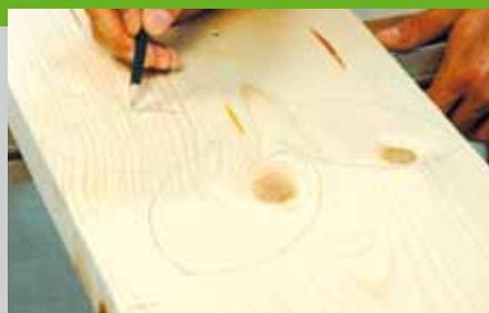
Zeichnen Sie auch die Höhe der Plattenunterkante auf der Mittelseite (Pos. 1) an. Skizzieren Sie nun auf den Seiten (Pos. 2) die spätere Position der Mittelseite und der Bodens (Pos. 3) an. Mit der Stichsäge und einem Kurvensägeblatt werden die Konturen der Blume ausgeschnitten.
