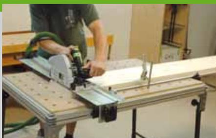
Schneiden Sie die einzelnen Bretter z. B. mit einer Tauchsäge und Führungsschiene zu. Markieren Sie sich auf den einzelnen Brettern die Vorderkante und schreiben Sie auf die Außenfläche die Nummer aus der Materialliste. Mit einem weichen Bleistift wird die Form der Blume auf das Brett aufgezeichnet.
