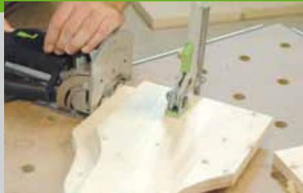
zufrieden sind, übertragen Sie die Form auf die Seiten der Box. Schneiden Sie hier die Negativform der Erdbeere aus und stecken Sie die beiden Teile zusammen. Falls es noch nicht genau passen sollte, schleifen Sie einfach noch etwas nach. Alle sichtbaren Kanten werden gefast oder gerundet. Bohren Sie die beiden Löcher für die Griffstange.
