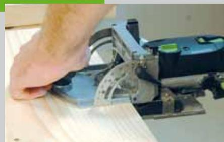
Der Boden wird mit den Seiten durch drei Domino Dübel verbunden. Die Arbeitsweise ist die gleiche wie zuvor. Fräsen Sie in die beiden Hälften der Platte vier Verbindungslöcher. Alternativ können Sie zum Domino Dübel natürlich auch Runddübel 10 mm mit Dübelspitzen oder einer Dübelschablone verwenden.
