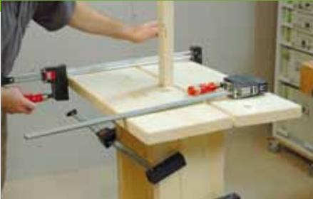
Geben Sie Kleber auf die Dübel oder in die Dübellöcher, schlagen Sie die Dübel ein und stecken Sie die Plattenhälften um den Stiel der Blume zusammen. Legen Sie unter die Blume ein Brett, das in etwa der Länge der Platte entspricht, und spannen Sie dann die Platte mit Zwingen nach unten. Alternativ können sie auch oben auf die Platte schwere
