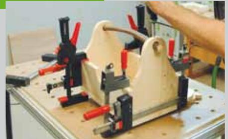
Fräsen Sie die Verbindungslöcher (Domino 5 x 30 mm oder Runddübel 6 mm) in die Einzelteile, stecken Sie die Dübel ein und verkleben Sie die vier Seiten, ähnlich wie beim Pflanztisch, miteinander. Der Boden wird von unten einfach aufgeklebt. Die Griffstange wird in die Löcher eingesteckt und mit zwei eingepöhrten Ästchen fixiert.
