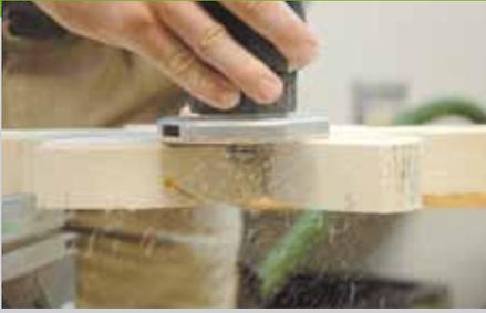
Stecken Sie die Plattenhälften zusammen und zeichnen Sie die Position des Untergestells an der Platte an. Die beiden Seiten werden nacheinander auf der Unterseite der Platte festgespannt und die Verbindungslöcher gefräst. Zeichnen Sie den Ausschnitt für den Stiel der Blume an und schneiden Sie die Öffnung mit der Stichsäge aus. Nach dem Ausschneiden werden alle sichtbaren
