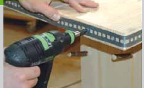
Löcher (D=10 mm) einkleben. Um die Standfläche und um die Platte schrauben Sie verzinktes Lochband fest. Dies erhöht die Stabilität und beugt gegen größere Rissbildung vor.
