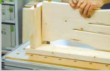
Kanten mit einer Kantenfräse oder einem Handschleifklotz gerundet oder gefast. An den Stellen, an denen der Anlauftring ein vollständiges Fräsen verhindert, können Sie den Rest mit einem scharfen Stemmeisen profilieren. Schleifen Sie rauhe Stellen mit einem Schleifpapier nach. Mit wasserfestem PU-Kleber werden die Dübel eingeklebt und die Teile zusammengesteckt.
