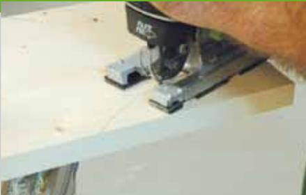
Schneiden Sie die Einzelteile der Pflanzbox mit einer Tauchsäge oder Tischkreissäge zu. Zeichnen Sie die Form der Seiten auf und schneiden Sie den Schwung mit einer Stichsäge aus. Die Form der Erdbeere wird auf ein Brett aufgezeichnet und mit der Stichsäge und einem feinem Kurvensägeblatt ausgeschnitten. Wenn sie mit der Erdbeere
