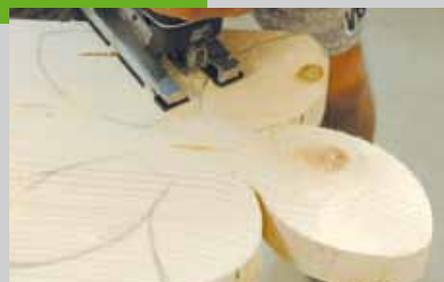
Ein Kurvensägeblatt ist schmäler als ein normales Sägeblatt. Dadurch lassen sich auch enge Radien gut sägen. Sägt man enge Kurven mit einem normalen Blatt, glüht dieses wegen der stärkeren Reibung sehr schnell durch und wird unbrauchbar.
