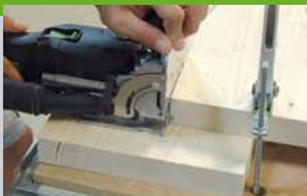
Stellen Sie die Mittelseite genau an der Stelle auf ein Seitenteil auf, an der sie später miteinander verbunden werden. Die Mittelseite wird am Strich nach hinten gekippt und festgespannt. Wenn Sie eine Dominofräse haben, nehmen Sie den 10 mm Fräser, da Domino Dübel Größe 10 x 50 mm verwendet werden. Legen Sie die Fräse am unteren Querholz der Mittelseite an und fräsen Sie
