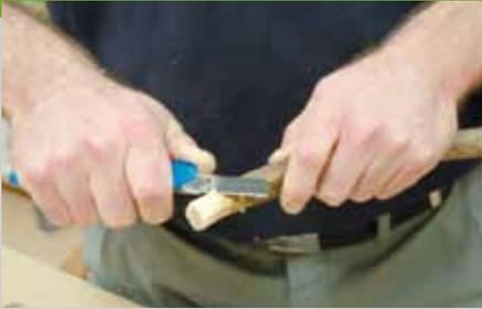
6. Bohren Sie ein Loch in das Brett, das etwa dem Durchmesser des Stockes entspricht. Mit einem Messer wird der Stock von der Schräge und im Durchmesser angepasst. Legen Sie den Griff von oben auf den Deckel auf, richten Sie ihn ungefähr in der Mitte aus und zeichnen Sie die Außenkonturen und die Bohrlöcher an.
