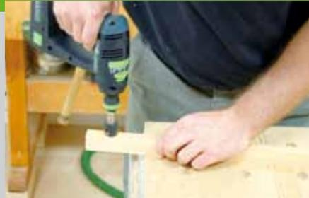
und zeichnen Sie auf beiden Seiten die Position der unteren Leisten an. In den unteren Leisten (Pos. 5) werden 4 mm Löcher vorgebohrt. Jede Leiste der Sitzfläche wird mit zwei Schrauben von unten befestigt. Schrauben Sie zunächst die erste Leiste bündig mit den beiden unteren Leisten fest.
