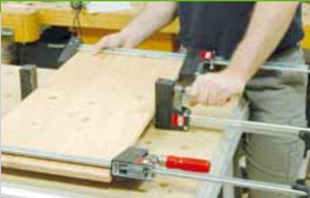
5. Für den Deckel werden mehrere Bretter mit wasserfestem Leim zu einem großen Brett (Pos. 7) verleimt. Suchen Sie gerade Bretter ohne Löcher aus, um einen gut aufliegenden, dichten Deckel zu bekommen. Nachdem der Leim getrocknet ist, werden überschüssige Leimreste mit einem scharfen Stemmei-
