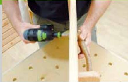
Bohren Sie die Löcher (3,5 mm) von oben durch den Deckel. Der untere Rand der Bohrlöcher wird mit einem Senker entgratet. Halten Sie den Griff an der richtigen Position an den Deckel und schrauben Sie ihn fest. Den Deckel dabei senkrecht einspannen oder diesen Arbeitsschritt mit einem Helfer machen.
