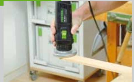
Dadurch sparen Sie sich das Anzeichnen der Löcher. Die Kanten der Unterkonstruktion werden gerundet oder gefast. Im besten Fall benutzen Sie dazu eine Fräse, mit etwas Übung können Sie aber auch einen Handhobel benutzen.
