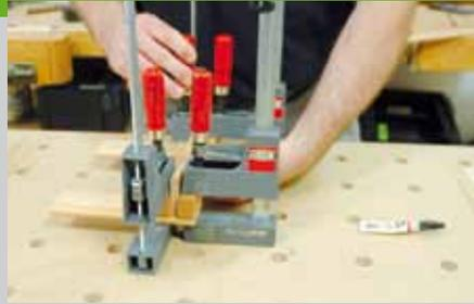
Die beiden Querleisten (Pos. 3) werden mit den Auflageleisten im rechten Winkel verklebt. Geben Sie dazu Kleber auf der hinteren Querleiste an und spannen Sie die Auflagen hinten und seitlich bündig darauf fest. Legen Sie dann als Abstandshalter ein Leistenreststück dazwischen, geben Sie Kleber an
