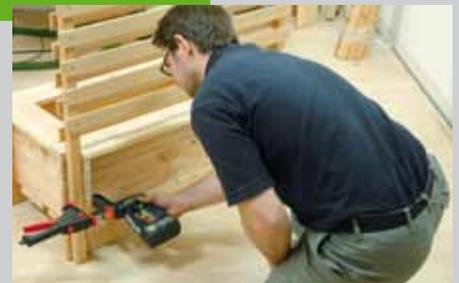
Um die Rankwand am Pflanzkübel sicher zu befestigen, werden Löcher (3,5 mm) in die Verblendung gebohrt. Dann wird die Wand eingestellt, ausgerichtet und mit mind. 6 Schrauben (Spax 3,5 x 45) befestigt.
