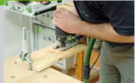
Löcher (3,5 mm) vorgebohrt und mit Spax 3,5 x 35 von unten an den Deckel geschraubt. Für den Griff, einen einfachen Stock (Haselnuss) (Pos. 10) in ein Brettchen (Pos. 9) einbohren. Das Brettchen mit einer Stichsäge und einem Kurvensägeblatt in der gewünschten Form aussägen.
