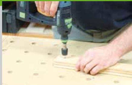
Zeichnen Sie auf einer Leiste die genauen Positionen der Bohrlöcher an. Zum Bohren eignet sich am Besten ein Bohrer, an dem schon ein Senker für den Kopf der Schraube, montiert ist. Bohren Sie in die erste Latte die Löcher. Sie können diese dann auf die anderen Leisten auflegen und als Schablone benutzen.
