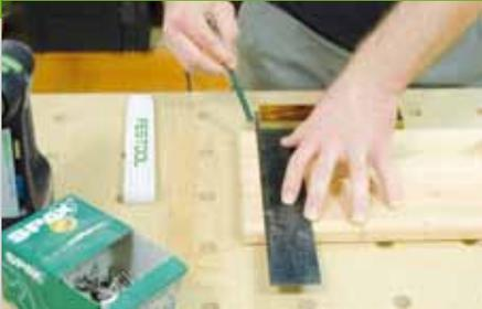
4. Die Sitzfläche besteht aus sieben einzelnen Leisten (Pos. 6), die auf der Unterseite von zwei schmälere Leisten (Pos. 5) zusammengehalten werden. Kürzen Sie zunächst alle Leisten auf das angegebene Maß. Die Kanten werden wieder gerundet oder gefast. Legen Sie die Leisten für die Sitzfläche zusammen
