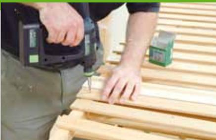
2. Es ist hilfreich, einen Arbeitstisch zu verwenden, der in etwa der Größe der Rankwand entspricht. Alternativ können Sie sie auch auf dem Boden zusammenzubauen. Die erste Latte wird oben am Strich auf der Unterkonstruktion angelegt und verschraubt (Spax 3,5 x 30).
