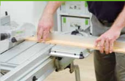
1. Sägen Sie die Unterkonstruktion (Pos. 1) und die Leisten (Pos. 2) mit einer Hand- oder Tischkreissäge zu. Zeichnen Sie oben die 10 mm Überstand auf der Unterkonstruktion an. Die Leisten werden hochkant zusammengelegt, um den seitlichen Überstand anzuzeichnen.
