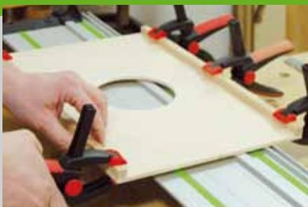
2. Auf der Rückwandplatte werden auf der Innenseite umlaufend Leisten angeleimt. Achten Sie darauf, dass die Leisten genau bündig mit den Außenkanten der Sperrholzplatten sitzen. Auch die Seiten bekommen an der Front und oben und unten jeweils eine Leiste. Die oberen und unteren Leisten stehen so weit zurück, dass die Rückwand inkl. Leisten noch von hinten eingeschoben
