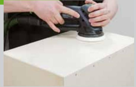
Die Flächen werden mit einem Exzentrerschleifer geschliffen. Letzter Schliff Körnung P180. Wenn Sie die Cajon farbig gestalten möchten können Sie sie jetzt beizen oder bemalen. Abschließend sollte die Oberfläche mit einem Lack oder Öl mindestens zweimal versiegelt werden.
