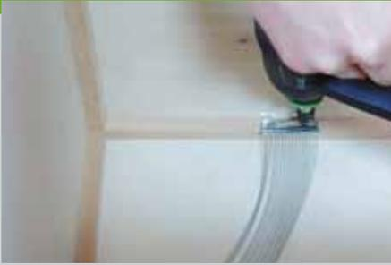
3. Legen Sie die Trommel auf die Front und schrauben Sie von hinten den Snareteppich ein. Testen Sie ob sich die Rückwand in den Korpus einschieben lässt. Auf den Leisten an der Rückwand wird Leim angegeben und die Rückwand von hinten in den Korpus eingeschoben.
