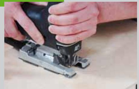
Stelle des Kreises vor und sägen Sie das sogenannte Schallloch mit einer Stichsäge oder einer Laubsäge aus. Die Kanten der Schalllochs werden mit Schleifpapier entgratet.
