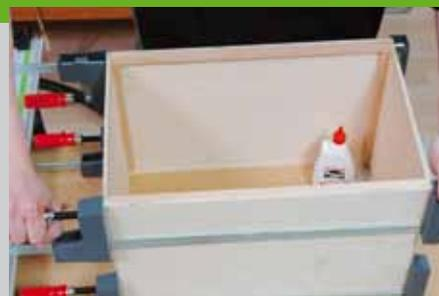
werden kann (ca. 18 mm). Nachdem der Leim getrocknet ist, werden Seiten, Boden und Deckel miteinander verleimt. Es ist wichtig, dass alle Einzelteile bündig zusammengebaut werden. Zeichnen Sie die Länge der Leisten, die an der Front auf Deckel und Boden geklebt werden, an. Schneiden Sie die Leisten ab und leimen Sie auch diese fest.
