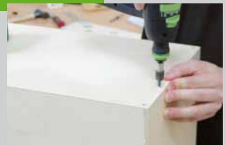
Das Fell (Pos. 4 auf der Materialliste) wird auf die Front festgeschraubt (Linsenkopfschraube 3 x 12). Bohren Sie die Löcher (3 mm) für die Schrauben in einem Abstand von ca. 70 mm vor. Die Schrauben im unteren Bereich werden fest angezogen. Die Schrauben oberhalb der Mitte müssen locker sitzen, das heißt einmal fest anziehen und dann wieder um eine Umdrehung lösen.
