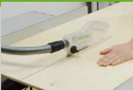
1. Sägen Sie die einzelnen Sperrholzplatten mit einer Tischkreissäge auf die angegebenen Maße ab. Alternativ können Sie die Platten auch im Baumarkt zuschneiden lassen. Um das Maß von Rückwand und Frontplatte zu kontrollieren, werden die Seiten, Deckel
