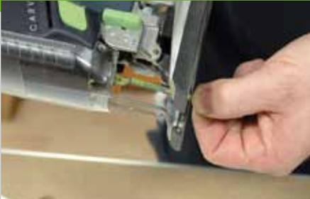
Zum Ausschneiden wird ein feines Kurvensägeblatt in die Stichsäge eingespannt. Schneiden Sie möglichst exakt entlang der angezeichneten Linien die Kontur aus. Mit einer feinen Feile und einem Handschleifklotz wird die Kontur gründlich geglättet. Ebenso wird auch die runde Mutterschablone für die Grundplatte hergestellt.
