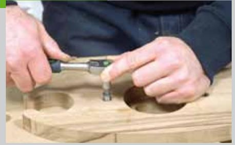
werden. Die von uns verwendeten Muffen haben eine Inbusschlüsselaufnahme. Das erleichtert das Eindrehen. In der Grundplatte werden zwei 6 mm Löcher vollständig durchgebohrt. In die Mitte der Platte müssen Sie ein 20 mm Loch für die Einschraubmuffe (Pos. 8) bohren. Zum Entgraten des Loches können Sie hier die Kantenfräse verwenden.
