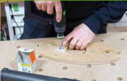
Die Schablone wird auf dem eigentlichen Werkstück festgeschraubt. Bei mehrmaliger Verwendung rutschen die Schraubenköpfe immer tiefer in das Holz der Schablone. Um das zu verhindern, werden mit einem Forstnerbohrer Vertiefungen für Unterlegscheiben in das Material der Schablone eingelassen. Die Unterlegscheiben werden in diese Löcher eingeklebt. Zeichnen Sie mit Hilfe der Schablonen die Kontur auf die obere Platte
