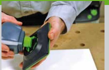
Mit dem Festool Ölspender SURFIX lassen sich Öle mit einem Schwamm auftragen. In den SURFIX lassen sich verschiedene Ölfaschen einstecken. Auf der Unterseite der Spenderfläche befindet sich ein Klettverschluss mit dem die Schwämme zum Auftragen des Öls gehalten werden. Wenn der Verschlussdeckel abgenommen ist, kann über eine sich selbst wieder verschließende Öffnung das Öl auf die Fläche aufgetragen
