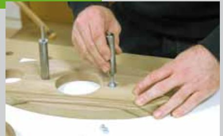
Vor der Montage sollten Sie die Oberfläche mit einem Öl, das für den Außenbereich geeignet ist, behandeln (siehe Oberflächentipp). Wenn alle Teile vorbereitet sind, können sie zusammengebaut werden. Abschließend wird der Erdspieß in die untere Muffe eingedreht und mit einer Mutter gekontert.
