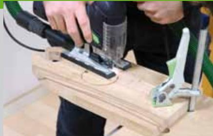
(Pos. 5) und auf die Grundplatte (Pos. 6) auf. Mit einem größeren Kurvensägeblatt wird die Kontur wieder mit ca. 2 mm Zugaben ausgeschnitten. Stellen Sie den Fräser auf die passende Höhe ein. Durch die tiefliegende Kontur muss leider die Zuführfeder an der Bogenfräshaube abgebaut werden. Um aber trotzdem sicher abreiben zu können, werden Werkstück und Schablone an der einen
