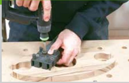
Loches muss dem Schaftdurchmesser der Muffe entsprechen. Mit einem Bohrständler, oder wie im Bild mit einer Dübelschablone, wird sichergestellt, dass die Löcher senkrecht gebohrt werden. Mit einem Bohrtiefenbegrenzer können Sie die Tiefe der Löcher exakt festlegen. Die Löcher müssen vor dem Einschrauben der Muffen mit einem Kegelsenker großzügig entgratet
