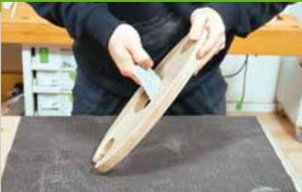
Unsere M12 Muffe hat keine Aufnahme für den Inbusschlüssel und muss mit einer gekonterten Schraube eingedreht werden. Achten Sie darauf die Muffe möglichst rechtwinklig einzudrehen. Runden Sie alle Kanten mit einer Ober- oder Kantenfräse ab. Schleifen Sie die Schmalflächen und Kanten mit Schleifklotz und Schleifpapier. Für die Flächen wird der Exzentrerschleifer eingesetzt, letzter Schliff Körnung P180.
