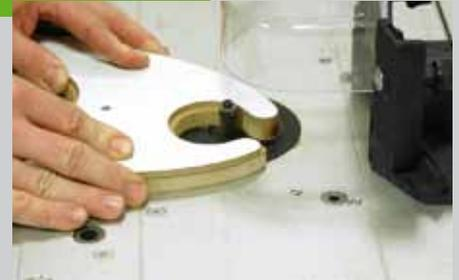
Schrauben Sie die Mutterschablone auf der eigentlichen Schablone fest. Stellen Sie die Höhe des Fräasers so ein, dass das Kugellager auf der Mutterschablone läuft und fräsen Sie eine 1:1 Kopie der Mutterschablone.
