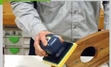
werden. Mit dem Schwamm wird es dann gleichmäßig verteilt. Das hier verwendete Outdoor-Öl sollte nach ca. 15 Minuten mit dem grünen Vlies und dem Exzentrerschleifer eingerieben werden. Anschließend muss das nicht eingezogene Öl mit einem Lappen von der Fläche entfernt werden. Nach ca. 8 Stunden kann dann noch mindestens ein weiterer Auftrag erfolgen.
