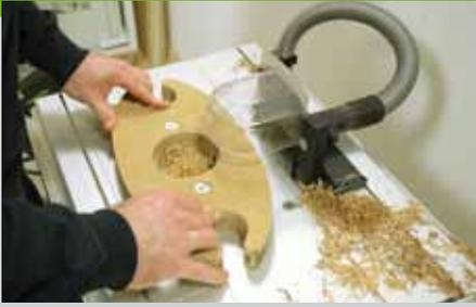
Bevor das innere Loch gefräst werden kann, müssen Sie die Fräse ausschalten und das Werkstück von oben einfädeln. Nach dem Fräsvorgang sollte die Fräse wieder ausgeschaltet und dann erst das Werkstück oben herausgehoben werden. In die Unterseite der oberen Platte werden zwei Einschraubmuffen (Pos. 11) eingelassen. Der Durchmesser des vorgebohrten
