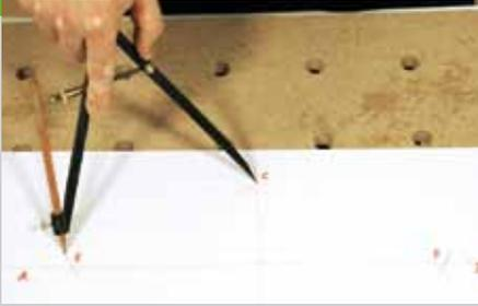
Zunächst werden aus dünner Hartfaser (Pos. 1 + 2) die Mutterschablonen hergestellt. Zum Aufzeichnen der Ellipse benötigen Sie lediglich eine Schnur und zwei Nägel. Zeichnen Sie auf der Hartfaserplatte zunächst die beiden Mittelachsen ein. Markieren Sie auf diesen Achsen die Länge „A-B“ und Breite „C-D“ der Ellipse. Es gibt Formeln, um den Abstand der beiden Brennpunkte „F“ auf „A-B“ auszurechnen.
