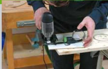
Falls Sie einen Zirkel für die Stichsäge zur Verfüzung haben, können Sie diesen zum Ausschneiden der runden Form benutzen. Zeichnen Sie mit Hilfe der Mutterschablonen die Außenkante auf der Grundplatte der eigentlichen Schablonen (Pos. 3 + 4) an. Mit ca. 2 mm Zugabe wird die Kontur mit der Stichsäge ausgeschnitten.
