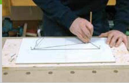
Einfacher geht es aber mit einem Zirkel. Nehmen Sie die Hälfte von „A-B“ als Maß in den Zirkel. Stechen Sie in „C“ oder „D“ ein und markieren Sie mit dem Zirkel die beiden Brennpunkte „F“ auf „A-B“. Schlagen Sie in die Brennpunkte die Nägel ein. Um die Schnurschleife auf die passende Länge knoten zu können, hilft ein dritter Nagel in „A“ oder „B“.
