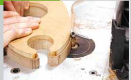
Kante der Schutzhaube angelegt und dann an den Fräser geschwenkt. Sobald gegen die Faserrichtung des Holzes gefräst wird, muss eventuell die Vorschubgeschwindigkeit gesenkt werden. Am Fräsgeräusch können Sie feststellen, ob sich Fasern beim Fräsen lösen. In diesem Fall sollten Sie den Fräsvorgang unterbrechen und die losen Fasern mit Holzleim anleimen.
