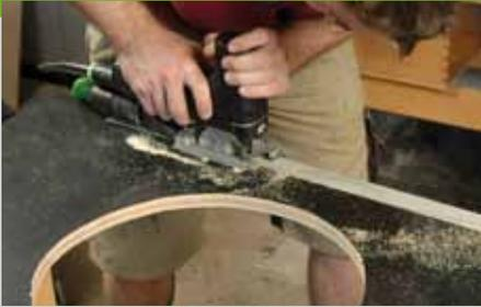
3. Aus dem Rest, der beim Zuschnitt der Seitenteile übrig geblieben ist, wird ein schmales Brett zugeschnitten. Beim Zuschnitt schmalere Bretter legt man am besten ein zweites Brett unter die Schiene, damit diese nicht kippen kann. Zeichnen Sie auf der Bodenplatte den
