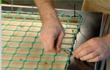
Dann werden die Aluminiumstäbe in das Netz eingefädelt und das entstandene Rechteck wird von innen auf die Rückplatte gelegt. Führen Sie durch die zuvor gebohrten Löcher Kabelbinder hindurch und ziehen Sie diese zu.
