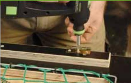
5. Im nächsten Schritt werden zwei Scharniere an der Aufdopplung festgeschraubt. Es ist einfacher, die Schrauben exakt in der Mitte zu positionieren, wenn Sie sich die Schraubenlöcher mit einem Vorstecher markieren. Schrauben Sie nun auch an den beiden seitlichen
