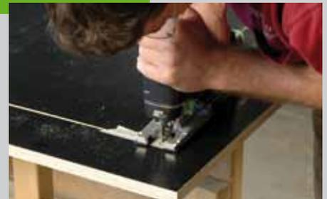
Wenn Sie eine Tauchsäge benutzen, sollte auf der Schiene ein Rückschlagklotz festgeklemmt werden. Dies verhindert ein Zurückschlagen der Säge. Bei älteren Sägen muss zusätzlich der Spaltkeil entfernt werden. Anschließend schneiden Sie die Ecken mit einer Stichsäge aus.
