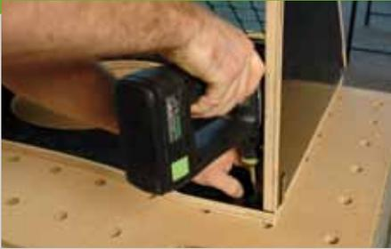
6. Jetzt bohren Sie an zwei Stuhlwinkeln das obere Loch auf 6 mm Durchmesser auf. Schrauben Sie die Winkel auf der Bodenplatte fest und bohren Sie mit dem 6 mm Bohrer die Position des oberen Bohrloches in die Seitenteile. Bohren Sie die Löcher im Holz auf 8 mm auf. Dann werden innen in diese Löcher
