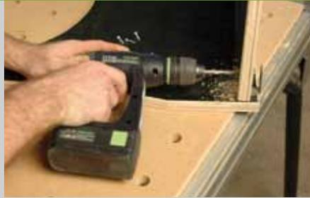
die beiden Einschlagmuffen eingeschlagen. Drehen Sie von außen durch die Stuhlwinkel zwei Flügelschrauben in die beiden Einschlagmuffen und ziehen Sie diese fest an. Danach lösen Sie die beiden Flügelschrauben und klappen Sie das Tor zusammen. Markieren Sie die beiden Positionen der Stuhlwinkellöcher
