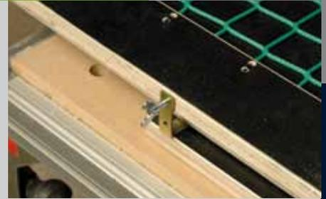
auf der Schmalseite der Rückplatte und bohren Sie zwei Löcher (Durchmesser hängt von der Einschraubmuffe ab) in die Sie die Einschraubmuffe eindrehen. Durch diese beiden Löcher können Sie das Tor im geschlossenen Zustand fixieren und die beiden Flügelschrauben gehen nicht verloren.
