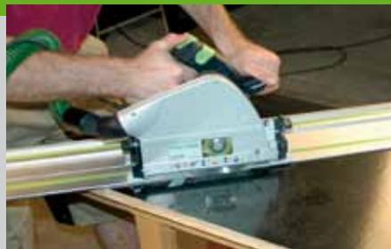
nach unten fallen kann. Stechen Sie die Reste in den Ecken mit einem Stemmeisen weg. Aus der herausgeschnittenen Platte werden die beiden seitlichen Ecken des Tores zugeschnitten. Schneiden Sie dazu die Platte auf eine Breite von 500 mm zu. Zeichnen Sie sich die beiden „Dreiecke“ (eine Ecke ist ab-
