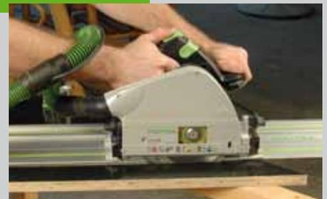
geschnitten) auf der Platte an. Um den Strich besser sehen zu können ist es auch hier ratsam, Kreppband zu verwenden. Legen Sie die Führungsschiene am Strich an und schneiden Sie die Seitenteile aus.
