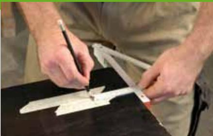
1. Lassen Sie sich beim Holzhändler oder im Baumarkt die beiden benötigten Platten zuschneiden. Wenn Sie die Platten selbst zuschneiden möchten, übertragen Sie die Maße aus der Zeichnung und zerschneiden Sie die Platte mit einer Tauchsäge und einer Führungsschiene. Zeichnen Sie sich auf
