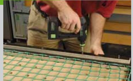
Dadurch wird das Netz auf der Rückplatte fixiert. Positionieren Sie die Aufdopplung auf der Platte und schrauben (Spax 4 x 35) Sie das Netz fest.
