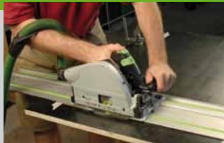
der größeren der beiden Platten die Umrisse des Ausschnittes an. Bei dunklen Platten ist es hilfreich, Kreppband als Kontrast unter den Strich zu kleben. Der Ausschnitt lässt sich mit einer Stichsäge oder mit einer Tauchsäge mit Führungsschiene heraussägen.
