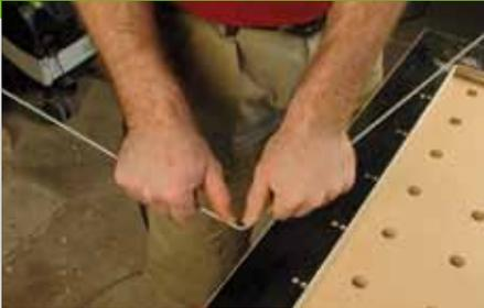
4. Als nächstes schneiden Sie das Netz auf das passende Maß zu. Biegen Sie 4 mm dicke Aluminiumstäbe so, dass Sie zwischen die beiden markierten Linien auf der Innenseite der Rückplatte passen.
