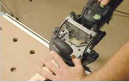
3. An der Dübelfräse montieren Sie den 5 mm Fräser und den Leistenanschlag. Stellen Sie den Leistenanschlag so ein, dass jeweils die Oberkante der Leiste anliegt und der Mittelstrich auf der Leiste mit dem der Maschine übereinstimmt. Die Klappenhöhe wird auf eine Materialdicke von 20 mm eingestellt. Fräsen Sie in jedes Leistenende ein
