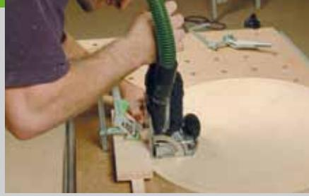
Dübelloch mit der exakten Dübelbreite und einer Tiefe von 20 mm. Zum Fräsen der Löcher in die Seiten spannen Sie einen Anschlagklotz auf die Fläche und stellen Sie die Frästiefe auf 12 mm ein. An diesem Klotz können Sie die Fräse anlegen und die Löcher fräsen. Anlegepunkt ist auch hier wieder der Mitte-Anriss. Legen Sie den Boden flach auf
