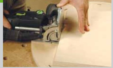
Kopf- und Fußteil und spannen Sie ihn genau auf seiner späteren Position fest (Oberkante an Oberkante). Zunächst werden senkrecht auf der Seite stehend die Verbindungslöcher gefräst (Frästiefe 12 mm). Danach werden horizontal die Gegenlöcher in den Boden gefräst (Frästiefe 20 mm).
