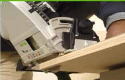
2. Schneiden Sie mit der Tauchsäge die beiden Längskanten des Bodens (Pos. 1) schräg ab. Zeichnen Sie sich auf einer Leiste (Pos. 3) das spätere Wellenprofil auf und schneiden Sie es mit der Stichsäge aus. Schleifen Sie die Leiste mit einem Bandschleifer oder einem Handschleifklotz. Übertragen Sie die Konturen auf die anderen Leisten
