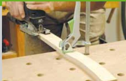
und schneiden Sie auch diese aus. Nun zeichnen Sie auf jeder Leiste an beiden Enden einen Mittelstrich an. Zeichnen Sie die Position des Bodens auf Kopf-/Fußteil an. Die Positionen der Leistenoberkante werden auf dem Mittelstrich markiert und nach außen übertragen. Zeichnen Sie eine Linie im Abstand von 20 mm von der Ellipsenkante ein.
