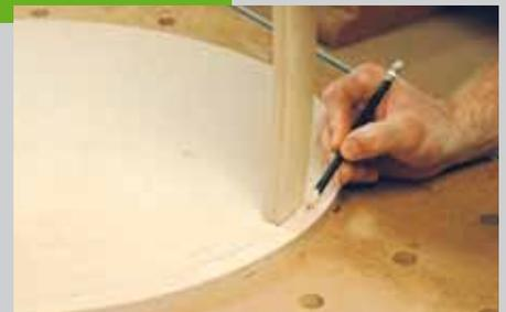
Wo sich Abstandslinie und Markierung der Oberkante schneiden, stellen Sie senkrecht die Leisten auf und markieren jeweils die Mitte und die Außenkanten. Auf diese Art werden alle Positionen angezeichnet. Dann werden die Positionen der beiden Löcher für das Seil angezeichnet.
