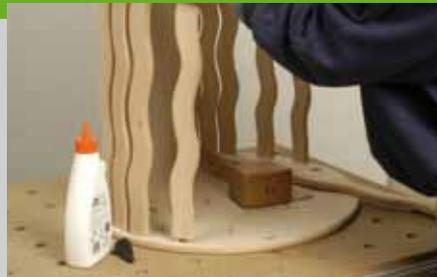
Kopf- und Fußteil und fügen die Teile zusammen. Verspannen Sie alles mit Zwingen und Zulagen. Bohren Sie in die inneren Grundplatten der Seilführungen die Löcher für das Aluminiumrohr und verkleben Sie die Einzelteile der Seilführung. Wie das Seil in der Führung verläuft sehen Sie auf dem nächsten
