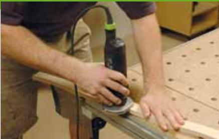
6. Runden Sie alle sichtbaren Kanten mit einer Kantenfräse oder einem Handschleifklotz. Schleifen Sie alle Flächen mit einem Exzentrerschleifer, letzter Schliff Körnung P 180. Die Domino Dübel werden zunächst in die Schmalflächen eingeleimt. Danach geben Sie Leim in die Gegenlöcher von
