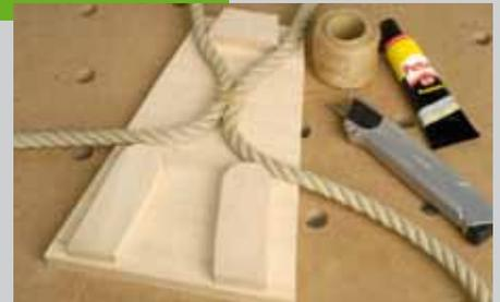
Bild. Nachdem der Leim getrocknet ist, werden alle Leimreste entfernt und mögliche raue Stellen nachgeschliffen. Die Oberflächenversiegelung muss in diesem Fall für die Verwendung bei Kinderspielzeug geeignet sein.
