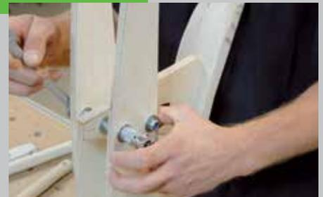
Schneiden Sie die Distanzstücke für die Befestigung der Sattelstütze mit einer Eisesäge zu. Als Distanzstücke kann entweder ein Eisenrohr oder eine Distanzmuffe (M10 X 30) genommen werden. Bauen Sie die Sattelstütze so ein wie auf der Zeichnung dargestellt.
