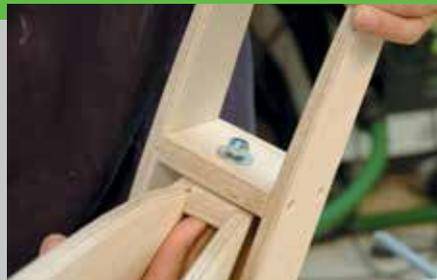
darauf, dass bei jeder Verschraubung, immer dort wo die Maschinenschraube auf das Holz trifft, eine Unterlegscheibe dazwischen kommt. Stecken Sie Gabel und Rahmen zusammen und schieben Sie die beiden Befestigungsschrauben durch die Löcher. Stecken Sie auf die Schraube zuerst eine Beilagscheibe und drehen Sie dann die Stopmutter auf.
