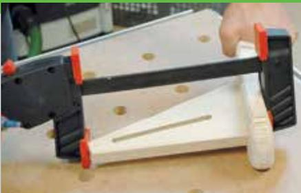
4. Kleben Sie die Dübel zunächst in die Sattelstütze ein. Geben Sie in den Dübellöchern im Sattel und auf der Verbindungsfläche ausreichend Leim an und verspannen Sie alles mit einer Zwinde. Um die Einzelteile besser streichen zu können, werden die Flächen vor dem Zusammenbau farbig oder transparent gestrichen. Achten Sie
