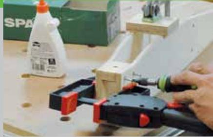
Verspannen Sie zunächst eine Seite des Rahmens mit den Streben und verschrauben Sie die Verbindungen (Spax 3,5 x 30). Die zweite Seite wird festgespannt, ausgerichtet und verschraubt. Damit ist der Rahmen zusammengebaut und kann zum Trocknen beiseite gelegt werden. Die beiden Bretter der Gabel werden auf die gleiche Art und Weise mit den Streben
