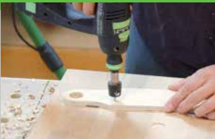
2. Auf den Rahmen und Gabelteilen werden die Positionen der Bohrlöcher und auf den Innenflächen die Positionen der Lenkbefestigung und Verstrebungen der Gabel angezeichnet. Bohren Sie in die Einzelteile von Rahmen und Gabel die Löcher für die Schrauben ( $\varnothing = 3,5 \text{ mm}$ ) und für die Achsen und Sitzbefestigung ( $\varnothing = 8 \text{ mm}$ ). Sägen Sie die Streben der Gabel und die des
