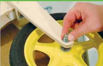
5. Bauen Sie nun Vorder- und Hinterrad ein und ziehen Sie alle Schrauben fest. Sie müssen darauf achten, dass sich die Räder frei drehen können. Der Lenker wird an den beiden Enden großzügig abgerundet. Stecken Sie ihn dann durch die beiden Löcher in der Gabel und schieben Sie ihn an die richtige Position.
