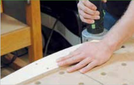
3. Alle Kanten mit einem Handschleifklotz oder einer Kantenfräse runden. Schleifen Sie die Flächen mit einem Exzenterschleifer, letzter Schliff Körnung P 180. Verleimen Sie die Streben der Gabel mit der vorderen Abdeckung. Die Einzelteile zur Montage des Rahmens werden zum Zusammenbau bereitgelegt. Geben Sie auf den Verbindungsflächen Holzleim an.
