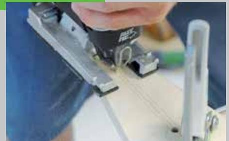
gebohrt. Der Zwischenraum wird mit einer Stichsäge herausgesägt. Auf die Vorderseite der Gabel kommt eine Abdeckung. In die Mitte dieser Abdeckung wird entweder ein dekoratives Loch gebohrt oder man kann ein Katzenauge darauf befestigen. An den oberen Enden der Gabel wird jeweils ein Loch ( $\varnothing = 25 \text{ mm}$ ) für den Lenker gebohrt.
