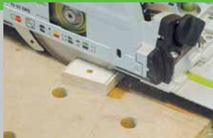
Rahmens mit einer Tisch- oder Handkreissäge auf dem Multifunktions Tisch zu. Zeichnen Sie die Bohrlöcher auf den Streben an und bohren Sie die Befestigungslöcher ( $\varnothing = 8 \text{ mm}$ ) für die Gabel. Für die Höhenverstellung muss ein Schlitz in die Sattelstütze geschnitten werden. Dazu wird der Schlitz auf dem Brett angezeichnet und am oberen und unteren Ende ein Loch ( $\varnothing = 8 \text{ mm}$ )
