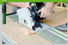
4. Um die Wände zu verkleiden, werden zunächst die Leisten der Unterkonstruktion (Pos. 9) an die Querbalken angeschraubt. Die Wandverkleidung wird unten 15 Grad schräg gesägt, dadurch kann herablaufendes Wasser nicht ins Holz einsickern. Um die Knacken zu verkleiden und die Optik noch mehr einer Ritterburg anzugleichen, werden die beiden äußeren Bretter mit einer
