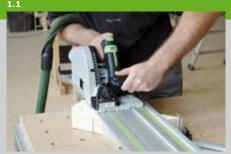
1. Sägen Sie die Balken (Pos. 1, 2, 3, 4) mit einer Kreissäge auf das passende Maß ab. Falls Sie mit der Säge die dicken Balken nicht auf einmal durchtrennen können, sollten Sie die Schnittkante vorher genau anzeichnen und dann mit der Säge genau an dieser Linie von beiden Seiten des Balkens sägen. Die so genannten Knacken (Pos. 5) sind die Winkelaussteifungen des Turms.
