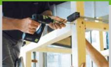
der Leiter wird keine Knacke eingebaut, sonst kann die Leiter nicht sicher benutzt werden. Sobald die drei fehlenden Knacken eingeschraubt sind, ist das Grundgestell fertig.
