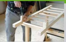
zusammengesteckt und von hinten in jede Sprosse mit zwei Schrauben fixiert. Unten an die Leiter werden die Abstandsklötze zum Befestigen am Sandkasten angeschraubt. Die Leiter wird von hinten am Querbalken festgeschraubt. Die genaue Länge des Fußbodenbelages (Pos. 11) wird am Gestell ausgemessen.
