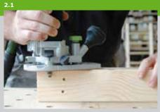
2. Stecken Sie die Eckpfosten und den First vor dem Weiterbau zusammen und prüfen Sie, ob die Verbindung passt. Die Kanten der Balken werden großzügig abgerundet. Dadurch sinkt das Verletzungsrisiko und die Farbe kann an den Ecken besser haften. So viele Teile wie möglich, sollten am Boden zusammengebaut oder eingepasst werden.
