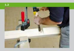
Sie verhindern, dass der Turm wackelt und machen die Konstruktion steifer. Die Knacken werden auf beiden Seiten 45 Grad schräg geschnitten. Der Firstbalken (Pos. 4) sitzt diagonal auf den Eckpfosten (Pos. 1). Dadurch kann die Plane besser darüber gespannt werden und es sammelt sich kein Wasser darauf. Um den Firstbalken dauerhaft auf den Pfosten zu befestigen,
