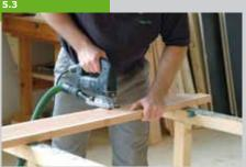
Die Fußbodenbretter werden zugeschnitten. Auch hier die Schnittkanten entgraten. Das erste und letzte Brett mit der Stichsäge so aussägen, dass es bündig mit der Außenkante der Querstreben abschließt. Die Löcher für die Handgriffe werden auf dem ersten Bodenbrett angerissen und gebohrt.
