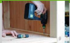
6. Die Handgriffe oben in die Löcher der Querstrebe einstecken und unten mit dem ersten Bodenbrett in Position schieben. Von außen die Griffe gegen verdrehen mit Schrauben sichern. Verschrauben Sie den Bodenbelag mit den Querbalken. Sägen Sie die Seitenteile (Pos.14) des Sandkastens auf das angegebene Maß ab. An den Ecken
