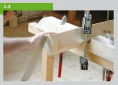
werden die Verbindungen miteinander verzapft. Zunächst wird auf dem First auf jeder Seite eine Nut angezeichnet. Mit einer Handsäge wird an den Linien dann ein Schnitt gesägt und das Holz zwischen den Schnitten herausgestemmt. Oben auf den langen Eckpfosten wird der Zapfen angezeichnet und ebenso mit einer Handsäge ausgesägt.
