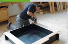
den gleichen Brettern wie die Wandverkleidung zugesägt. Hinter der Leiter wird mit der Stichsäge eine Aussparung in die Sitzfläche gesägt. Dadurch entsteht keine Stolperfalle. Stecken Sie die Sandkastenseiten innerhalb des Grundgestells zusammen und schrauben Sie die Eckverstärkungen ein. Nun die Sitzfläche ausrichten und festschrauben.
