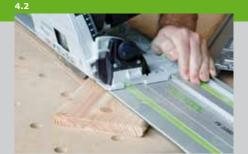
45 Grad Schräge abgesägt. Auch hier wieder alle Kanten, außer der unteren, mit einer Kantenfräse oder einem Handhobel abrunden. Das erste Brett wird parallel zum Eckpfosten ausgerichtet und von innen durch die Unterkonstruktion festgeschraubt. Die Schraubenlöcher werden zuvor mit einem Bohrer (D = 3.5 mm) in der Unterkonstruktion vorgebohrt.
