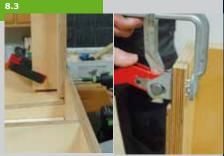
den Tisch um und spannen Sie die Beine auf ihrer späteren Position fest. Mit einem 10 mm Bohrer werden die Postionen der Befestigungsschrauben in die Beine gebohrt. Spannen Sie die Beine aus und bohren Sie die eben gebohrten Löcher mit einem 12 mm Bohrer auf und drücken Sie von innen die Einschlagmuffen M10 in die Beine. Schrauben Sie die Beine am Tisch fest.
