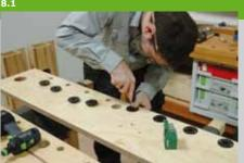
2. Schleifen Sie alle Flächen und Kanten. Der letzte Schliff vor der Oberflächenbehandlung sollte mit Körnung P 180 ausgeführt werden. Die Oberfläche sollte mindestens zweimal mit Öl oder Lack behandelt werden. Schrauben Sie die Lager für die Stangen, die Abdeckungen auf der Gegenseite und den Balleinwurf in die vorgesehenen Löcher ein. Um die Positionierung zu vereinfachen, werden die mittleren
