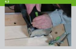
Rampe fest. Markieren Sie sich drei Positionen für die DOMINO-Dübel und fräsen Sie waagerecht in die Rampe, anschließend senkrecht in der Seite die Löcher für die Verbinder ein. Fasen Sie mit einer Kanten- oder Oberfräse alle Kanten, auch an den Stellen an denen die Einzelteile zusammenstoßen. Dadurch entsteht eine so genannte offene Brüstung und leichter Materialversatz, der durch das Arbeiten der
