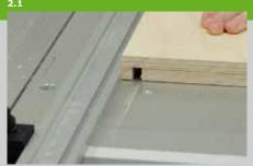
2. Die beiden Innenseiten (Pos. 4) werden an der Unterkante schräg abgeschnitten. Am späteren Tisch gibt diese Schräge die Neigung des Ballauswurfes vor. In den beiden Verstrebungen (Pos.6) wird mit der Tischkreissäge jeweils eine Nut geschnitten. Die Löcher für die Stangenlager, den Ballein- und Auswurf werden die Seiten (Pos.1) gebohrt oder gefräst. Beim Fräsen wurde eine 24 mm Kopierhülse
