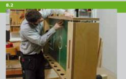
Löcher auf einer Linie ausgerichtet und die Schraubenpostionen mit einem Vorstecher markiert. Der Toreinsatz wird in der Aussparung mit zwei Zwingen nach oben gedrückt und mit zwei Tackerklammern auf jeder Seite fixiert. Bauen Sie jetzt die Einzelteile des Kickertisches zusammen. Mit vier durchgehenden Gewindestangen werden die Einzelteile des Tisches zusammengehalten. Drehen Sie
