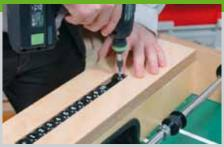
Die Spielfiguren werden mit den passenden Schrauben an der Stange befestigt. Sie Stangen haben in den Lagern etwas Spiel und sollten sich schon ohne Schmierung leicht drehen lassen. Vor dem Spielen sollten sie aber mit etwas Silikonspray eingesprüht werden. Die Torzähler werden in den zuvor gefrästen Nuten oder einfach oben auf die Ablagen geschraubt. Richten Sie den Kickertisch mit den Stellfüßen aus und das Spielvergnügen kann beginnen.
