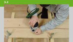
Innenseiten (Pos.4) unterschiedlich ist. Auf der Schablone für die Nut in den Seiten befinden sich auch 14 mm Bohrungen für Schraubenlöcher. Auch diese werden mit dem gleichen 10 mm Fräsungen komplett durch die Seiten (Pos. 1) gefräst. Falls die Länge des Fräsers nicht ausreicht, werden die Löcher mit einem Bohrer nachgebohrt.
