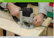
3. Die Nuten für das Spielfeld werden mit einem 10 mm Fräser und einer 13,8 mm Kopierhülse gefräst. Die Fräsungen in der Schablone wurden zuvor mit einem 14 mm Fräser ausgeführt. Zum Bau der Schablone wurde die Fräse mit einer Führungsschiene geführt. Achten Sie darauf, dass die Frästiefe an den Seiten (Pos.1) und an den beiden
