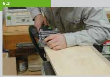
zusammengesteckt. Fräsen Sie also in die Deckel, in die kurzen Außenseiten des Torkastens und in die Seiten DOMINO-Löcher. Um später alles einfacher zusammenstecken zu können, werden diese mit der mittleren Breiteneinstellung gefräst. Alternativ können natürlich auch hier Runddübel benutzt werden.
