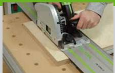
1. Beim Zuschnitt von Furniersperrholzplatten (Multiplex) dieser Stärke müssen Sie, um eine saubere Schnittkante zu bekommen, ein scharfes Sägeblatt verwenden. Sägen Sie die einzelnen Teile, nach den in der Materialliste angegebenen Maßen, zu. Die großen Teile können mit einer Handkreissäge mit Führungsschiene zugschnitten werden.
