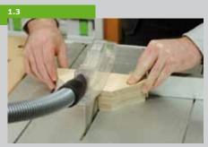
Beim Ablängen kleiner Teile am Schiebetisch ist der Einsatz eines Schiebestockes allerdings nicht geeignet. Achten Sie in solchen Fällen darauf, dass Sie den größtmöglichen Sicherheitsabstand zum Sägeblatt einhalten und die Schutzhaube über dem Sägeblatt so weit wie möglich nach unten geschoben ist.
