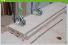
6. Entfernen Sie die Zwingen an den Torkästen und schrauben Sie die Ballrampe von unten an die Torseite. Die Positionen der Verstrebungen (Pos. 6) werden auf der Innenfläche der Seiten (Pos.1) angezeichnet. Spannen Sie die Streben flach an dieser Position fest und fräsen Sie die DOMINO-Löcher zunächst senkrecht in die Seiten und dann waagerecht in die Verstrebungen.
