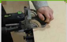
4. Fräsen Sie die DOMINO-Löcher für die Verbinder in die Einzelteile. Alternativ können Sie auch Dübel verwenden. Die Ballrampe (Pos. 5) wird nicht mit dem Torkasten verklebt, sondern nur mit Dübeln in die kurze Seite (Pos. 2) gesteckt und von unten an der Innenseite festgeschraubt. Zeichnen Sie die Schräge der Ballrampe auf der Innenfläche der kurzen Seite an und spannen Sie an dieser Linie die
