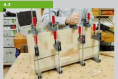
Platten entstehen kann, ist nicht mehr spürbar. Geben Sie Leim in den Löchern an und schlagen Sie die Dübel in die Seiten ein. Geben Sie dann in den Gegenlöchern des Deckels (Pos.3) Leim an und stecken Sie alles zusammen. Kontrollieren Sie, ob die Außenkanten bündig abschließen und spannen Sie alles mit Zwingen zusammen.
