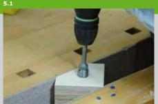
5. In den vier Füßen (Pos.10) wird jeweils ein 20 mm Loch für die Eindrehmuffen (M12) gebohrt. In diese Muffen werden später die Stellfüße eingedreht, mit denen der Kicker bei unebenen Böden ausbalanciert werden kann. Drehen Sie die Muffen mit einer gekonterten Schraube M12 oder einem passenden Eindreher in die Füße ein. Zeichnen Sie die Positionen der Füße auf den Innenseiten der
