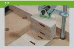
Beine an. Fräsen Sie die Dominolöcher, welche die beiden Bretter (Pos. 7+8) zu einem L-förmigen Bein verbindet. Der Fuß wird an der angezeichneten Stelle festgespannt. Fräsen Sie nun die Dübellöcher um den Fuß mit den Beinen zu verbinden. Zeichnen Sie die Position der Querstrebe (Pos.9) an und fräsen Sie die Dominolöcher. Die Kanten der Beine und der Füße werden auch gefast.
