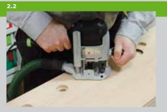
und ein 12 mm Fräser benutzt. Bei den Löchern (D = 28 mm) für die Stangenlager muss das Loch in der Frässchablone 40 mm groß sein. Dieses Maß ergibt sich aus der Differenz zwischen Kopierhülsen- und Fräseraußendurchmesser, addiert mit dem Durchmesser des Lochs. Der Ausschnitt für das Tor wird in die beiden Innenseiten (Pos.4), entweder mit der Stichsäge gesägt oder auch mit der
