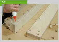
Geben Sie in den Löchern der Füße Leim an und schlagen Sie die Dübel ein. Zunächst wird ein Fuß mit der kurzen Seite der Beine verklebt. Kleben Sie dann die Dübel in die Beine ein und spannen Sie alles zusammen. Der überschüssige Leim wird nach dem Aushärten mit einem scharfen Stemmeisen entfernt.
