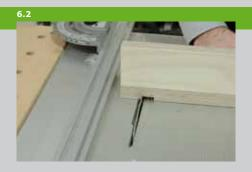
Nachdem die Beine ausgespannt sind, wird an der Oberseite mit der Tischkreissäge in mehreren Schnitten eine Aussparung herausgesägt. Durch diese Aussparung drückt das Gewicht des Oberteils später nicht auf die Schrauben, sondern wird gleichmäßig nach unten auf die Beine verteilt. Verleimen Sie die Beine mit den Querstreben. Auch die Torkästen und die Seiten werden mit DOMINO-Dübeln
