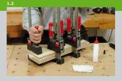
Beim Zuschnitt der kleinen Teile sollten Sie eine Tischkreissäge verwenden. Die Füße (Pos. 10) bestehen aus zwei 30 mm dicken Platten. Verleimen Sie dazu zwei Reststücke mit Verschnittzugabe und sägen Sie nach dem Trocknen die einzelnen Füße zu. Beim Sägen kleiner und schmaler Teile sollte zur Sicherheit immer ein Schiebestock benutzt werden.
