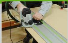
7. Durch die schräge Nut in den Seiten und rechts und links der Tore sind die Ecken des Spielfeldes nach oben gezogen. So kann der Ball nicht in den Ecken liegenbleiben. Ebenso werden auch die Außenbanden nach oben gebogen. Um das zu erreichen wird, von unten eine 6 mm breite Nut gefräst (Frästiefe 6 mm). Der Biegeeffekt wird durch eine 6,5 mm breite Leiste (Pos.12) erreicht, die in die Nut
