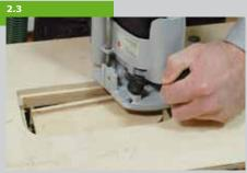
Oberfräse gefräst. Auch hier muss die Kontur der der Schablone insgesamt um 6 mm in jede Richtung größer sein. In der Tiefe wird die Platte, beim Tor, in zwei Schritten vollständig durchgefräst. Es ist wichtig beim zweiten Fräsen in einer der Ecken anzufangen. Dadurch fällt der Abfall am Schluss nach unten und kann sich nicht verkeilen und zu Beschädigungen führen.
