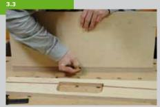
Je nach Bauart des Fräsers kann es sein, dass Sie, um ein sauberes Bohrloch zu bekommen, die Drehzahl der Fräse vermindern müssen. Nachdem alle Fräsungen gemacht sind werden die Einzelteile der Seitenkästen nummeriert und die genaue Position der Einzelteile mit einem Schreinerdreieck gekennzeichnet.
