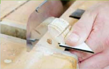
6. Um die Schlitz für die Schaufeln in die beiden Scheiben (Naben) zu schneiden, wird in der Mitte ein passender Holzdübel durch das Loch gesteckt. Die beiden Scheiben werden jetzt in die Hobelbank eingespannt und mit einer Handsäge die Schlitz herausgeschnitten. Kontrollieren Sie jeden Einschnitt auf Passgenauigkeit.
