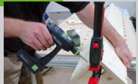
Wenn alles zugeschnitten ist, die Kanten der Absperungen mit einer Kantenfräse oder einem Handschleifklotz abrunden. Jeweils eine Absperung wird in der Rinne festgeschraubt. Dazu die Schraubenlöcher ( $D = 3,5$  mm) in den Rinnen vorbohren und die Absperung festschrauben.
