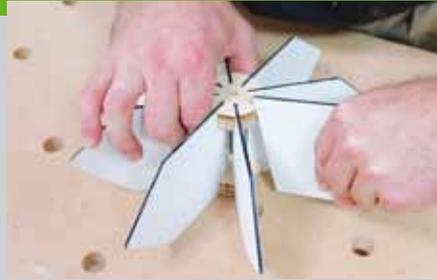
Die Schaufeln sollten stramm in den Schlitz stecken. Mit einem Acrylrest können Sie die beiden Scheiben gegen verdrehen sichern. Runden und entgraten Sie alle Kanten und stecken Sie das Schaufelrad zusammen. Die Schaufeln werden mit etwas PU-Kleber in die Nabe eingeklebt. Danach alles zusammenstecken.
