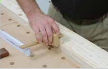
3. Zeichnen Sie auf den Seiten (Pos. 1) der Stützen die Positionen der 20 mm Bohrlöcher an. Den Abstand vom Rand können Sie wieder mit einem Streichmaß markieren. Spannen Sie die beiden Seiten, die später eine Stütze ergeben, zusammen und bohren Sie die 20 mm Löcher durch beide Teile durch. Wenn Sie später diese beiden Seiten miteinander verbinden, liegen die Löcher
