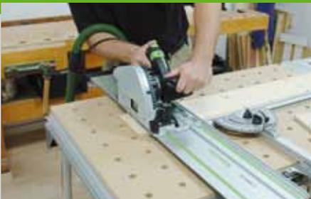
1. Sägen Sie zunächst die Bretter auf das in der Materialliste angegebene Maß. Die Bretter für die Rinnen (Pos. 7 + 8) werden auf einer Ecke im 90 Grad Winkel miteinander verschraubt. Um die Positionen der Schraublöcher schneller markieren zu können, sollten Sie zunächst mit einem Streichmaß oder einem Parallelanreißer eine Linie (Abstand vom Rand halbe Brettstärke)
