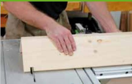
2. An den Oberkanten der Rinnen mit einer Tischkreissäge oder einer Stichsäge Aussparungen für die Absperungen (Pos. 9) sägen. Die Form der Absperungen wird direkt mit der Rinne auf ein Brett aufgezeichnet. Die obere, geschwungene Kante mit einem Zirkel anzeichnen. Das Griffloch wird mit einem 35 mm Bohrer gebohrt.
