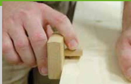
anzuzeichnen. Dann werden auf dieser Linie mit einem Abstand von ca. 200 mm Löcher ( $d = 3,5$ ) für die Spax ( $3,5 \times 3,5$ ) gebohrt. Vor dem Zusammenschrauben der beiden Bretter auf der Stoßfuge wasserfesten Leim oder Polyurethan-Kleber angeben, um eine dichte und witterungsbeständige Verbindung herzustellen.
