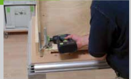
Schrauben Sie dann die Platte von unten am Rahmen fest und runden Sie alle Kanten. Die Beine werden von innen am Rahmen festgeschraubt. Das Wasser sammelt sich später unter dem Tisch in einem Mörtelkübel. Dieser ist in den Tisch eingeschoben.
