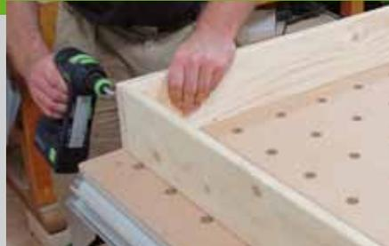
Die Bretter für die Beine (Pos. 13, 14 + 15) des Sandtisches werden genau wie die Rinnen aus zwei Brettern verschraubt. In der Position 16 werden die Löcher vorgebohrt, um sie mit den Positionen 17 verschrauben zu können. Dadurch entsteht der obere Rahmen des Tisches. In den Boden (Pos. 18) ein 50 mm Loch für ein Wasserrohr bohren; das ist später der Abfluss des Tisches.
