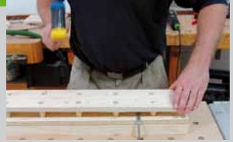
die Rundstäbe eingeschlagen. Danach den Leim erst ca. 15 Minuten trocknen lassen, bevor die zweite Seite aufgeleimt wird. Dadurch verrutschen die Rundstäbe nicht mehr in beiden Seiten und es ist einfacher, die Stäbe mit der Außenfläche der Seiten bündig abschließen zu lassen.
