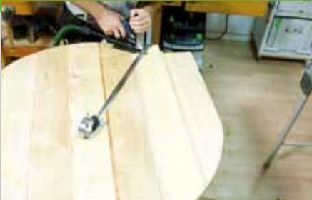
2. Drehen Sie die Platte um und markieren Sie auf der Oberseite den Mittelpunkt. Mit einem Bleistift wird wieder die Kontur der Platte angezeichnet. Wenn Sie die Rundung fräsen möchten, wird beim Ausschneiden mit der Stichsäge eine Zugabe von ca. 3 mm gegeben. Bei weichen Hölzern können Sie die Kontur auch nur mit einer Stichsäge und dem
