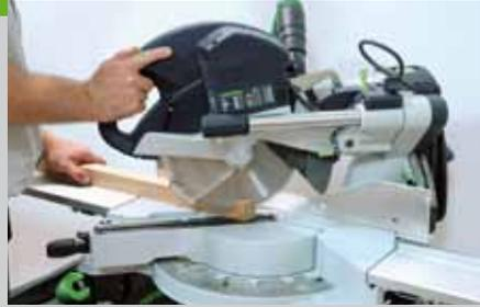
Mit einer Zwinde wird die Platte fest zusammengezogen. Markieren Sie den Mittelpunkt und zeichnen Sie mit einem Zirkel die Kontur der Platte an. Schneiden Sie die beiden Leisten (Pos. 10) zu. Die Ecken der Leisten werden in einem 45 Grad Winkel abgeschnitten. Zeichnen Sie die Positionen der Leisten unter der Tischplatte an. Um die Schraubenlöcher gleichmäßig bohren zu können, wird mit
