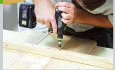
einem Streichmaß die Mitte der Leiste angerissen. Bohren Sie zunächst die beiden äußeren Löcher und schrauben Sie die Leiste an der Markierung fest. Jetzt lässt sich die Position der anderen Löcher einfach per Augenmaß festlegen. Schrauben Sie die Leisten vollständig fest und entfernen Sie die Zwinde.
