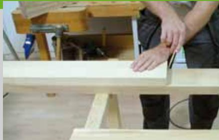
Die Zargen werden an beiden Enden im 45 Grad Winkel abgeschrägt. Zeichnen Sie die Verbindungspositionen auf den langen Zargen (Pos. 6) an. Legen Sie dazu die kurzen Zargen (Pos. 7) auf. Spannen Sie zwischen die kurzen Zargen ein Stück Restholz mit der gleichen Stärke. Mit einer weiteren Zwinde wird die lange Zarge mit dem Restholz verspannt. Für die Verbindung zwischen
