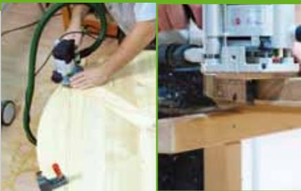
3. Die Plattenkante wird je nach Holzart in mehreren Schritten rund gefräst. Eine zweite Person, die die Platte festhält oder die Zwingen versetzt, ist hier sehr hilfreich. Falls es beim Fräsen zu Brandstellen kommt, muss die Drehzahl reduziert oder ein schärferer Fräser eingespannt werden. Sobald Sie die Fräse entgegengesetzt der Faserrichtung fahren, müssen Sie langsam und
