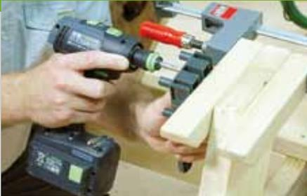
8. Die Spitzen der Beine zwischen den kurzen Zargen müssen abgeschnitten werden um Platz für die Leisten unter der Platte zu schaffen. Am oberen Ende der Beine beiden Seiten Befestigungsleisten mit einer Zwinde fixieren. Bohren Sie jeweils in der Mitte jedes Beins ein 8 mm Loch für die Schlossschrauben. Nachdem an jedem Bein die Leisten angebracht sind, wird das Gestell
