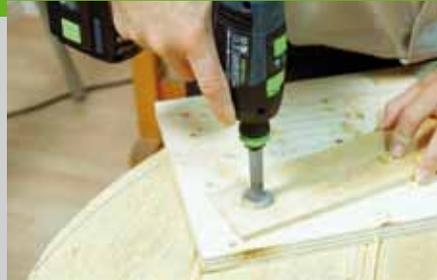
passendem Zirkel schneiden und dann schleifen. Als Zirkel für die Oberfräse eignet sich ein einfacher 10 mm dicker Sperrholzstreifen, der an einem Ende ein 30 mm dickes Loch zur Aufnahme der Kopierhülse hat. Setzen Sie eine 30 mm Kopierhülse in den Oberfräsentisch ein. Der Fräser sollte einen möglichst großen Durchmesser haben (mind. 14 mm) und
