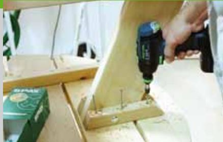
gedreht und auf der Platte ausgerichtet. Bohren Sie in die Befestigungsleisten Löcher (4,5 mm) und schrauben Sie das Gestell an der Platte fest. Falls Platte und Gestell einmal getrennt werden müssen, reicht es, die vier Schlossschrauben zu entfernen. Zum Befestigen der Sitzflächen die Tischplatte mit einer Decke darunter auf den Boden legen. Um die Sitzflächen nach oben zu
