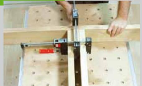
den Zargen werden Schlüsselschrauben (8 x 120) verwendet. Bohren Sie 8 mm Löcher für die Schrauben in die langen Zargen. Bei harten Hölzern muss im Querholz der kurzen Zargen das Schraubenloch noch mit einem 6 mm Bohrer vorgebohrt werden. Verschrauben Sie die Zargen miteinander.
