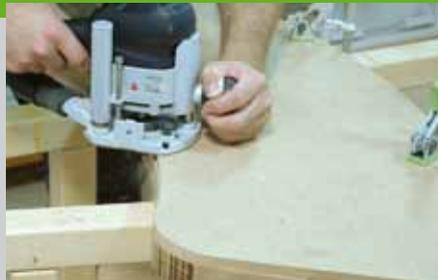
Ein Spanfänger, der von unten in den Tisch der Oberfräse eingesetzt werden kann, verhindert herumfliegende Späne und verbessert die Absaugung. Um ein Kippen der Fräse zu vermeiden, sollte der vordere Knauf immer über der Platte geführt werden. Wenn Sie die Kontur nur mit der Stichsäge ausgeschnitten haben, eignet
