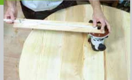
muss so lang sein, dass er die Kante der Platte vollständig fräsen kann. Zeichnen Sie sich den Radius auf dem Zirkel an und bohren Sie an dieser Stelle ein Loch, durch das Sie den Zirkel im Mittelpunkt der Tischplatte festschrauben.
