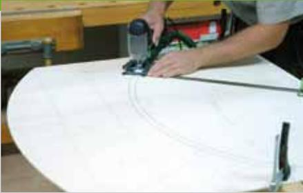
4. Um die Form der Sitzflächen immer gleich auf das Holz zu übertragen ist es hilfreich, sich eine Schablone aus dünnem Sperrholz anzufertigen. Diese Schablone kann dann auch zum Ausfräsen der Sitzflächen verwendet werden. Zum Fräsen sollte die Schablone mindestens 10 mm dick sein, um dem Anlauf-ring des Fräsers genügend Auflagefläche
