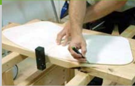
zu bieten. Zeichnen Sie sich die Form der Sitzfläche und die Lage der einzelnen Bretter auf einem Sperrholzbrett an und schneiden Sie sie mit einer Stichsäge aus. Mit einem Handschleifklotz werden die Konturen der Schablone geglättet. Spannen Sie wie zuvor bei der Tischplatte die einzelnen Bretter, mit Abstandleisten dazwischen, zusammen.
