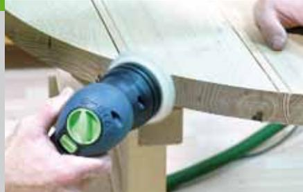
vorsichtig agieren. Wenn es zu Absplitterungen kommt, sofort wieder mit Leim angekleben und die betroffene Stelle erst nach dem Aushärten weiterbearbeiten. Die entstandenen Übergänge, mit einem Exzentrerschleifer entfernen. Für das Schirmloch benötigen Sie einen 26 mm Bohrer. Um ein exakt senkrecht Loch zu bohren, schrauben Sie das mittlere Brett heraus und benutzen eine Ständer-
