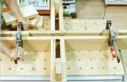
7. Spannen Sie die beiden Gestellhälften zusammen. Auch hier mit Reststücken den passenden Abstand herstellen. An jedes Ende der vier Zargen-Paare kommt eine Platte (Pos. 8), auf der die Sitzfläche angeschraubt wird. Diese stabilisiert auch das Gestell. Aus diesem Grund wird sie auf die Zargen geklebt und geschraubt. Am Kreuzungspunkt der Zargen wird oben und unten jeweils eine
