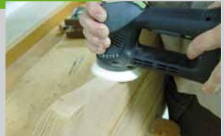
sich ein Schweifhobel besonders gut, um die Kanten zu glätten. Nachgeschliffen wird dann mit einem Exzenterschleifer oder Handschleifklotz. Runden Sie dann noch die Kanten auf beiden Seiten. Die Leisten in den Zwischenräumen werden nach oben herausgezogen und die Ecken mit einem Handschleifklotz entgratet.
