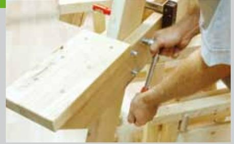
beiden Zargen und das Bein in der Mitte gebohrt werden. Als kleine Hilfe kann eine einfache Dübelschablone benutzt werden. Stecken Sie dann die Schrauben durch die Löcher und schlagen Sie den Vierkant unter dem Kopf ins Holz. Auf die andere Seite kommen zunächst eine Unterlegscheibe und dann eine Hutmutter.
