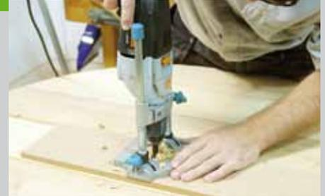
bohrmaschine oder einen kleinen mobilen Bohrstand. Löcher mit dem gleichen Durchmesser zur Aufnahme des Schirms werden auch in die Versteifungsplatten (Pos. 13) gebohrt. Alle Kanten, auch das Schirmloch werden abgerundet. Nehmen Sie dann die Abstandleisten heraus und entgraten Sie großzügig mit einem Handschleifklotz die Ecken.
