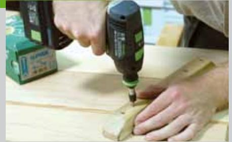
Eine Mittellinie hilft dabei die Schablone genau auf den Brettern zu positionieren. Zeichnen Sie die Position der kurzen Streben (Pos. 9) unter der Sitzfläche an. Bohren Sie die Löcher für die Schrauben in den Leisten vor und verbinden Sie damit die Bretter der Sitzfläche. Lösen Sie die Zwingen und übertragen Sie die Kontur auf die Oberseite der Sitzfläche.
