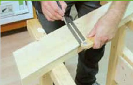
6. Schneiden Sie die Beine (Pos. 5) in der angegebenen Schräge ab. Sie werden paarweise mit der schöneren Kante nach außen zusammengelegt und mit einem Schreinerdreieck gekennzeichent. Zeichnen Sie die Höhe an, in der die Beine mit den Zargen (Pos. 6 + 7) verschraubt werden. Der Winkel kann einfach am Ende der Beine mit einer Schmiege abgenommen werden.
