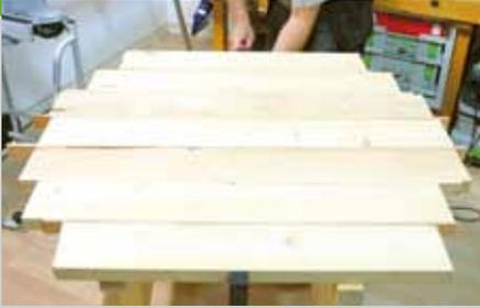
1. Schneiden Sie die Bretter für die Tischplatte zunächst grob ab. Die Längskanten der Bretter werden mit einer Kanten- oder Oberfräse gerundet ( $R = 4 \text{ mm}$ ). Legen Sie die Bretter mit der Oberseite nach unten auf die Arbeitsfläche und spannen Sie zwischen die Bretter der Tischplatte Abstandleisten (Pos. 14). Diese Leisten verringern das Ausreißen beim Schneiden und Fräsen.
