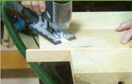
5. Schneiden Sie die Form der Sitzfläche mit der Stichsäge aus. Falls Sie noch nachfräsen möchten, lassen Sie ca. 3 mm mehr stehen. Spannen Sie die Schablone mit Zwingen von oben auf die Sitzfläche. Mit einem Bündigfräser mit Kugellager oben, wird die Fräse exakt an der Schablone entlanggeführt.
