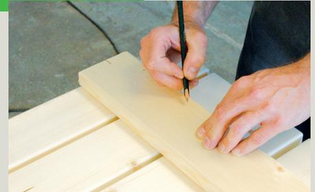
Für jede Verbindung genügen zwei Schrauben, die diagonal zueinander eingeschraubt werden. Der Abstand der Schrauben zu den Außenkanten sollte ca. 25 mm betragen.
