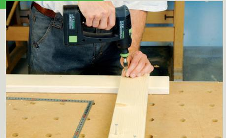
Positionieren Sie die Querbretter auf Ihrem Anriss (angezeichnete Position) und verschrauben diese mit der Tischplatte. Die Einzelteile für die Beine auf den Tisch legen und auch diese verschrauben. Auf die gleiche Art und Weise nun auch die Sitzflächen und die Beine der Bank zusammenbauen.
