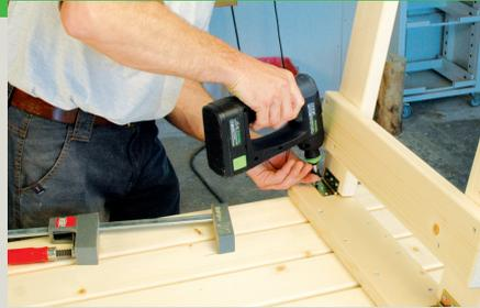
Dabei müssen die Außenkanten der Beine mit den Außenkanten der Querbretter bündig sein. Seitlich werden die Untergestelle auf dem Querbrett vermittelt. Verschrauben Sie nun die Scharniere mit den Querbrettern. Befestigen Sie die Scharniere an den diagonalen Verstrebungen.
