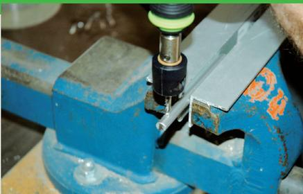
5. Fertigen Sie jeweils aus einem Aluminiumstab, einem Schlüsselring und einer kleinen Kette die benötigte Anzahl Sicherungsbolzen (pro Bank oder Tisch zwei Stück). Schneiden Sie den Aluminiumstab ab, entgraten ihn mit einer Feile und bohren am oberen Ende ein Loch. Durch dieses Loch den Schlüsselring fädeln und darauf das Kettenstück auffädeln.
