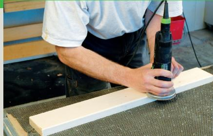
Nach dem Schneiden werden alle Kanten mit einer Kantenfräse, Oberfräse oder einem Handschleifklotz gerundet. Übertragen Sie die einzelnen Positionen der Bretter aus der Zeichnung auf das Material. Ebenso alle Bohrlöcher auf den Brettern anzeichnen.
