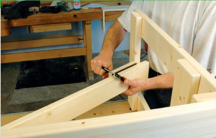
4. Klappen Sie drei Beine auf und spannen Sie einen Klotz als Anschlag an die Strebe. Nun die Bank oder den Tisch umdrehen und noch einmal den rechtwinkligen Stand kontrollieren. Es ist hilfreich, wenn Sie zum Drehen einen Helfer haben, da sich die Untergestelle sonst schnell einklappen könnten.
