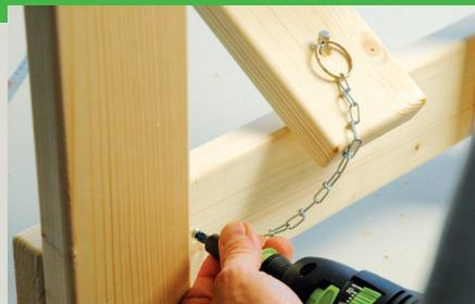
Der Sicherungsbolzen wird mit Hilfe einer durch die Kette geschraubten Spaxschraube an den unteren Querstreben der Gestelle fixiert. Der Bolzen muss stramm im Loch sitzen, damit er sich nicht von alleine lösen kann.
