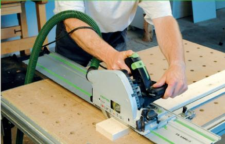
1. Schneiden Sie die einzelnen Bretter auf das in der Materialliste angegebene Maß. Zum Schneiden kann sowohl eine Stichsäge, eine Handkreissäge, eine Kappsäge als auch eine Tischkreissäge verwendet werden.
