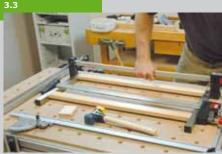
verkleben können. Der Kleber wird erst in die Löcher im Querholz gegeben. Dann schlagen Sie die Dübel bis zum Grund des Bohrloches ein. Geben Sie Kleber in die Löcher der Beine und stecken Sie alles zusammen. Mit Zwingen werden die Einzelteile verspannt. Kontrollieren Sie, ob alles im rechten Winkel zueinander sitzt und korrigieren Sie durch Versetzen der Zwinge.
