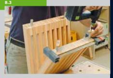
Sie Löcher (5 mm) und schrauben (Spax 5 x 70) die Sicherungsklötze dagegen. Damit sich die Klötze leichter drehen lassen, wird jeweils eine Beilagscheibe zwischen Hülse und Klotz gelegt. Die seitlich angesetzten Zwingen verhindern, dass die Schraube das Holz spaltet. Entfernen Sie alle Kleberreste und streichen Sie Ihre Gartencouch mit wasserfestem Öl oder einer Lasur.
