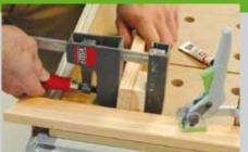
7. Die Leisten für die Rückenlehnen werden auf der Unterseite schräg geschnitten (20 Grad). Die Leisten werden mit schräg geschnittenen Abstandsklötzen miteinander verbunden. Zunächst verkleben Sie immer einen Abstandsklotz und eine Leiste. Da die Klebeflächen hier relativ groß sind, sind keine Verbinder oder Schrauben nötig.
