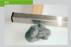
scharfen Stemmeisen und etwas Aceton (Lappen) entfernt. Falls ein Kleberschleier auf dem Edelstahl zurückbleibt, kann dieser mit feiner Stahlwolle entfernt werden.
