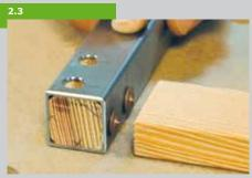
An den im Holz entstandenen Markierungen bohren Sie die Löcher für die Dübel. Benutzen Sie hierzu einen Holzbohrer mit Zentrierspitze und einen Tiefenanschlag. Auch hier ist es wieder sinnvoll eine Dübelschablone einzusetzen.
