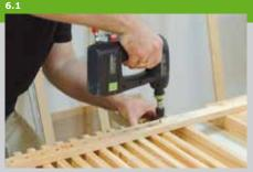
6. Bohren Sie die Schraubenlöcher (für Spax 4 x 45) für die Befestigung der ersten und der letzten Leiste in die Auflageleiste und schrauben Sie die Leisten fest. Legen Sie die Abstandslatten dazwischen und bohren Sie jeweils das Schraubenloch zum Befestigen der nächsten Leiste. Schrauben Sie nach dem Bohren die Leiste fest.
