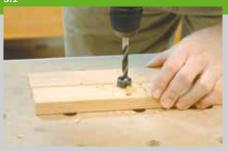
3. Bohren Sie die Dübellöcher für die Verbindung zwischen den unteren Zargen (Pos. 3) und den Längsstreben (Pos. 5). Dazu zeichnen Sie zunächst die Position der Löcher und der Streben auf den Zargen an und bohren die Löcher mit einem Holzbohrer mit Tiefenanschlag. Dann werden auch diese Löcher mit Hilfe von Dübelspitzen auf die Längsstreben übertragen.
