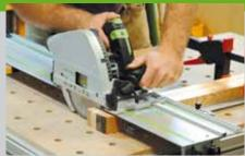
1. Alle Leisten der Bank werden mit einer Hand- oder Tischkreissäge auf das in der Materialliste angegebene Maß zugeschnitten. Wenn Sie eine Handkreissäge mit Führungsschiene benutzen, können Sie mehrere Leisten mit einer Zwinge zusammenspannen und diese gemeinsam zusägen. Die Vierkantrohre aus Edelstahl schneiden Sie mit einem Winkelschleifer oder einer Metallsäge
