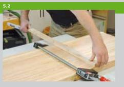
geteilt. Dadurch erhalten Sie das genaue Abstandsmaß. Schneiden Sie sich auf der Tischkreissäge zwei Latten mit genau diesem Maß zu. Messen Sie diese Abstandslatten mit der Schieblehre nach. Benutzen Sie auch jetzt wieder eine rechtwinklige Unterlage (alte Zimmertüre) und spannen Sie die erste Leiste an der Längskante fest.
