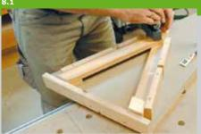
8. Verkleben Sie die Leisten miteinander. Achten Sie darauf, dass die Kanten an den Anschlägen anliegen. Sobald alle Dreiecke fest sind, werden sie zur Rückenlehne verklebt. Richten Sie das erste Dreieck im rechten Winkel zu einer Tischkante aus und spannen Sie es fest. Verkleben Sie nach und nach die einzelnen Dreiecke miteinander. Unten in die Rückenlehne werden
