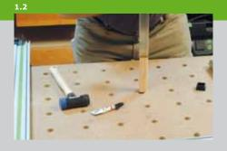
auf das passende Maß zu. Entgraten Sie anschließend die Schnittkanten mit einer Feile. Schneiden Sie Holzleisten, die innen in das Edelstahlprofil passen, auf der Tischkreissäge zu. Diese Holzleisten werden mit PU-Kleber (Polyurethan) in das Edelstahlrohr eingeklebt. Beim Einkleben setzen Sie eine Kunststoffkappe unten auf das Rohr auf. Nachdem der Kleber getrocknet ist, wird auf der
