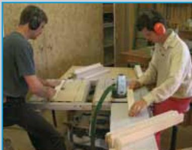
**11** Alle Kanten werden am Abrundfräser mit Anlaufring  $R=5$  mm abgerundet. Dies kann stationär mit der Oberfräse (bei den Latten) oder mobil mit der Kantenfräse OFK 500 geschehen.
