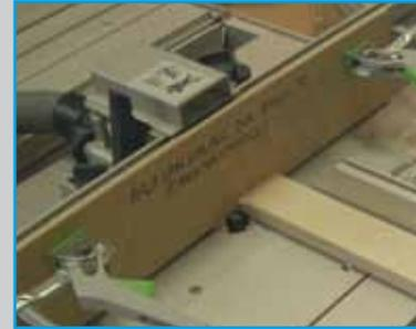
**7** Die Zapfen an den Latten werden mit der Oberfräse OF 1010 EBQ im stationären Einsatz (Basis Modul 5A) gefräst.
