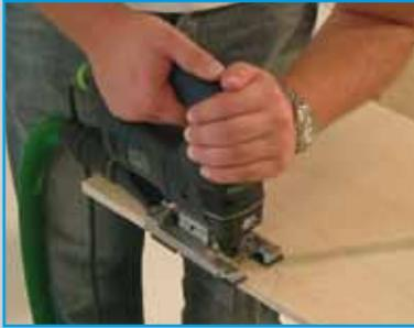
**1** Herstellen der drei Fräs- und Bohrschablonen (5,6,7,). Dazu die Klebeschablonen auf ca. 15 mm Birke Multiplex kleben und mit Stichsäge und Festool Kurvensägeblatt präzise aussägen.
