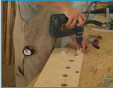
**9** Zur Herstellung der Rasterloch-Schablone (7) werden an den gekennzeichneten Stelle Löcher  $\varnothing$  30 mm gebohrt.
