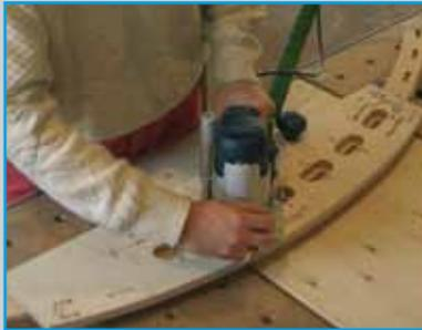
**10** Zum Einfräsen der Rasterlöcher  $\varnothing$  25 mm kann die Oberfräse mit Kopiering 30 mm in der Rasterloch-Schablone (7) als mobiler Bohrständer mit exakter Führung eingesetzt werden.
