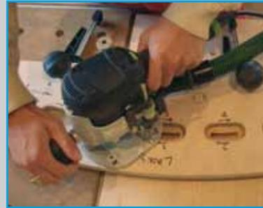
**6** Das Fräsen der Zapfenlöcher erfolgt mit Zapfenloch-Schablone, Oberfräse OF 1010 EBQ, 30 mm Kopiering und Nutfräser 10 mm eingespannt am Multifunktions Tisch MFT 1080. (Siehe Darstellung II)
