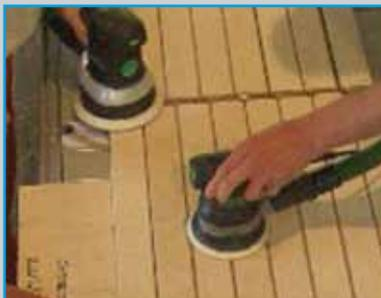
**12** Zum Schleifen der Flächen benutzt man einen Exzentrerschleifer ES 125 EQ mit Schleifmittel Rubin für Holzoberflächen Körnung P 80. Der Feinschliff erfolgt mit Körnung P 120.
