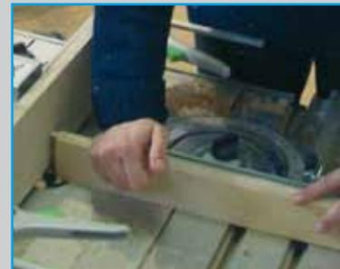
**8** Die Führung erfolgt mit Schiebeschlitten (SAS 500) und Winkelrastanschlag.
