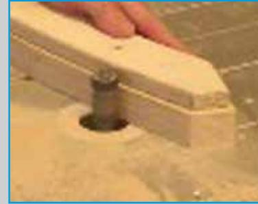
**5** Diese Zugabe wird mit der Oberfräse OF 1400 EBQ und einem Bündigfräser mit Anlaufring an der aufgeschraubten Schablone entlang abgefräst. (Siehe Darstellung I auf der Vorderseite).
