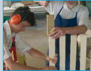
**13** Zum Verleimen werden 4-6 Zwingen (Bessey Korpuszwingen) mit der Länge 800 mm, sowie Zulagen zur Druckverteilung benötigt.
