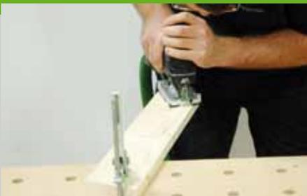
2. Mit einer Stichsäge und einem scharfen Kurvensägeblatt werden die Bretter entlang der Linie gesägt. Schneiden Sie auch gleich die Armlehnen (Pos. 4) mit aus. Mit Raspel und Feile oder mit einem Bandschleifer wird der Schwung nachgeschliffen, bis keine Unebenheiten mehr vorhanden sind. Benutzen Sie die beiden ersten Bretter als Schablone, um auf den anderen den
