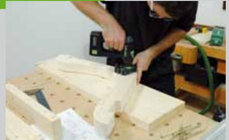
bohrmaschine besitzen, kann eine Dübelschablone dabei helfen, die Löcher gerade zu bohren. Verschrauben Sie die Seiten mit den Streben zur Unterkonstruktion für die Sitzfläche. Runden Sie die Kanten und bohren Sie die Schraubenlöcher in die Sitzleisten und beginnen Sie mit dem Festschrauben an der unteren Kante der Sitzfläche.
