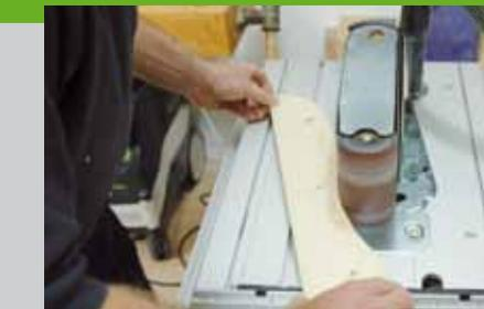
Schwung anzuzeichnen. Durch den dreischichtigen Aufbau der geschwungenen Teile können die Lehne und die Sitzfläche mit Schlitz und Zapfen verbunden werden. Bei den Lehnen gehen die beiden äußeren Bretter durch. Das mittlere springt um die Brettbreite (100 mm) nach oben zurück. Dadurch entsteht ein Schlitz, in den das mittlere Brett der Sitzflächen einge-
