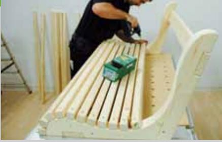
6. Um einen möglichst gleichmäßigen Abstand zwischen den Leisten zu bekommen, müssen Sie durch die wechselnde Wölbung verschiedene Abstandsklötze verwenden. Der Abstand beträgt im Mittel ca. 8 mm an der Vorderkante der Leisten. Nach circa der Hälfte sollten Sie die restlichen Leisten mit Abstandsklötzen auflegen und kontrollieren ob der Abstand passt. Falls nicht, können
