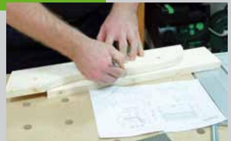
steckt werden kann. Bei den Sitzflächen ist das mittlere Brett um 100 mm länger und die beiden Äußeren stehen zurück. Diesen dreischichtigen Aufbau müssen Sie schon beim Übertragen der Kontur auf die anderen Bretter beachten. Die Konturen werden wieder mit der Stichsäge ausgeschnitten, geschliffen werden Sie allerdings erst wenn die Bretter miteinander verleimt sind.
