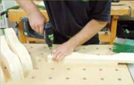
3. Die Bretter werden mit wasserfesten Leim oder PU-Kleber miteinander verbunden. Falls Sie nicht über ausreichende Zwingen verfügen, können Sie die Bretter zum Spannen auch miteinander verschrauben. Die Schrauben sollten später von Außen nicht sichtbar sein. Die Innenfläche von Sitz und
