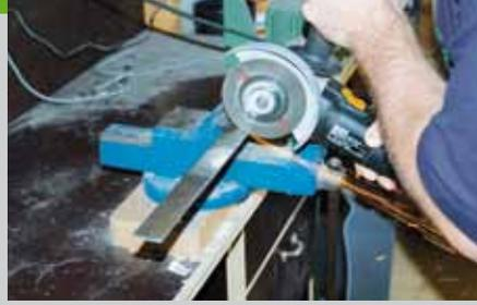
Sie jetzt dünnere oder dickere Abstandsklötze verwenden, ohne dass dies später zu erkennen ist. Die Aufhänger werden von einem Flachstahl abgeschnitten, gebohrt, mit einer Feile gerundet und dann im Schraubstock mit einem Gummihammer gebogen. Schrauben Sie die Aufhänger zunächst an die Sitzfläche. Zwischen Holz und Metall sollte jeweils eine Karosse-
