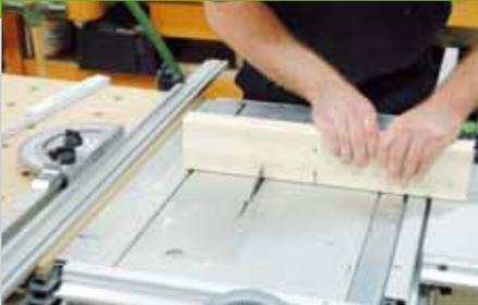
4. Die vier Beine (Pos. 2) werden auf der Innenseite so ausgesägt, dass die Querstreben (Pos. 5) eingesteckt werden können. Diese Ausschnitte können Sie entweder mit einer Tischkreissäge oder einer Stichsäge schneiden. Das Arbeiten mit der Tischkreissäge ist die genauere Variante. Dabei wird ein Anschlag so eingestellt, dass mit ihm der obere Schnitt gesägt wird
