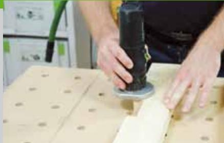
und der andere kommt auf die Position des unteren Schnittes. Dazwischen wird das Material mit mehreren Schnitten herausgesägt. Die Höhe des Sägeblattes entspricht der Dicke der Streben. In den Querstücken (Pos. 1) werden die 8 mm Löcher für die Aufhängung der Sitzfläche angezeichnet und gebohrt. Die sichtbaren Kanten des Untergestells mit einer Kantenfräse oder einem Hand-
