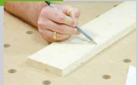
zeichnen. Mit Höhenmarkierungen werden die Kreuzungspunkte zwischen Rasterlinien und Schwung angezeichnet. Wenn Sie diese Kreuzungspunkte jetzt miteinander verbinden, haben Sie eine Linie, an der Sie die genaue Kontur der Bretter ausschneiden können.
