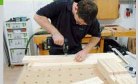
hobel abrunden. Die Einzelteile der Seiten werden miteinander verschraubt. Zeichnen Sie die Positionen der Schraubenlöcher an und bohren Sie die Löcher ( $d = 6 \text{ mm}$ ) in den Füßen (Pos. 3), den Querstücken (Pos. 1) und den Streben (Pos. 5) vor.
