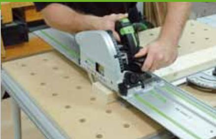
1. Sägen Sie zunächst alle Leisten auf das in der Materialliste angegebene Maß ab. Die Pos. 7 + 8 werden aus drei einzelnen Brettern mit jeweils 20 mm Dicke verleimt. Dadurch lässt sich auf einfache Art und Weise eine Schlitz- und Zapfenverbindung herstellen.
