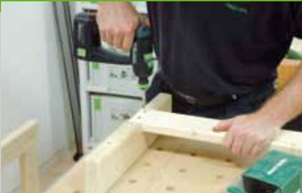
5. Verschrauben Sie die Streben und Beine miteinander. Dann werden die Beine mit den Querstücken verschraubt und die Füße noch von unten mit den Beinen verbunden. Unter den Füßen können Sie noch vier dünne Auflagen (Pos. 6) festschrauben, die das Kippen des Gestells verhindern sollen. Spannen Sie die beiden Seitenteile der Sitzfläche aus und entfernen Sie Leimreste mit
