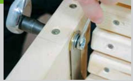
riescheibe unterlegt werden. Zwei gekonterte Muttern oder eine Stoppmutter verhindern, dass sich die Schrauben durch die Schaukelbewegung lösen können. Die Armlehne wird ausgerichtet und von unten verschraubt oder mit etwas Kleber auf dem Querstück angebracht.
