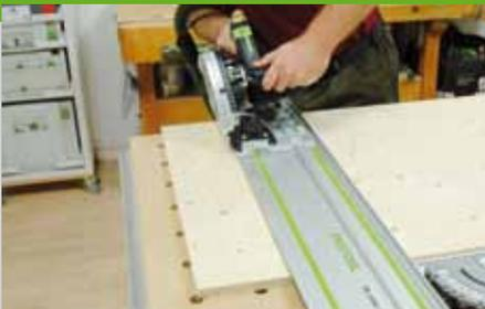
1. Sägen Sie die einzelnen Positionen aus der Materialliste auf das angegebene Maß zu. Die Oberkanten der beiden Seitenteile (Pos. 5 + 6) abschrägen (10 Grad). In beide Giebelseiten wird unten jeweils ein Ausschnitt gesägt, der später die Beine des Stalls ergibt. Zeichnen Sie den Ausschnitt an und sägen Sie ihn mit einer Stich- oder einer Tauchsäge aus. Falls Sie eine Tauchsäge verwenden,
