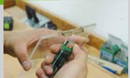
Am Ausgang wird eine Schiebetür eingebaut, die auch aus Acrylglas besteht. An der Oberseite wird das Acryl so gebogen, dass später durch ein Loch ein Schlüsselring mit einer Kette gefädelt werden kann. Dazu wird die Türe in diesem Bereich mit einem Heißluftföhn oder einem Feuerzeug erhitzt und dann im passenden Winkel auf die Arbeitsfläche gedrückt.
