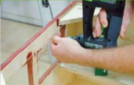
4. Für die Fenster werden zwei Acrylglasplatten zugesägt. Bohren Sie vorsichtig am Rand der Platten mit einem Holzbohrer 3,5 mm Löcher vor und reiben Sie diese mit einem Senker aus. Die Platten werden von innen vorsichtig an die Fenster geschraubt. Schrauben Sie die Scharniere an der passenden Stelle von innen auf der Türe fest.
