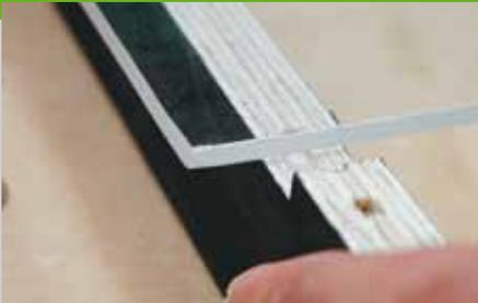
5. Die Türe läuft in zwei gefälzten Leisten (Pos. 20), der Falz sollte ca. 1 mm tiefer sein als die Türe dick ist. Unterhalb des Türausschnittes wird eine Art Balkon (Pos. 19) an den Stall geschraubt. Dieser Balkon hat auf der Rückseite einen Ausschnitt durch den die Türe nach unten rutschen kann. Dadurch steht die Tür später nicht auf
