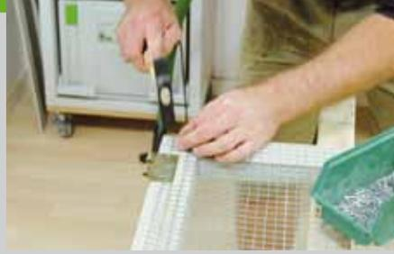
Damit die Stifte nicht verloren gehen, werden sie mit Ketten direkt am Gitter der langen Seiten befestigt. Schrauben Sie zunächst alle Scharniere an den Rahmen fest und schneiden Sie dann das Gitter zu. Auch hier müssen die Scharniere teilweise wieder ausgespart werden. Mit Krampen wird das Gitter
