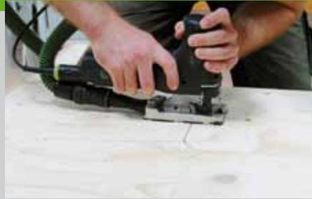
Ausschnitte in die hohe Seite gesägt. Auf die gleiche Art werden auch die Scharniere für das Dach in der niedrigen Seite (Pos. 6) eingelassen. Unter dem Dach wird noch eine Leiste befestigt, die im geschlossenen Zustand das Dach auf dem Stall stabilisiert. Runden Sie alle Kanten mit einer Kantenfräse oder einem Handschleifklotz. Vor dem Zusammenbau sollten Sie die Einzelteile
