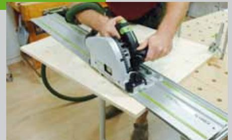
Legen Sie dann die Führungsschiene genau an den beiden Linien an und sägen Sie die Giebelwand ab. Anschließend zeichnen Sie die Unterkante des Ausschnittes für die Flügeltüre auf der Giebelwand an, legen die flache Giebelwand (Pos. 4) an dieser Kante an und übertragen Sie die Schräge darauf.
