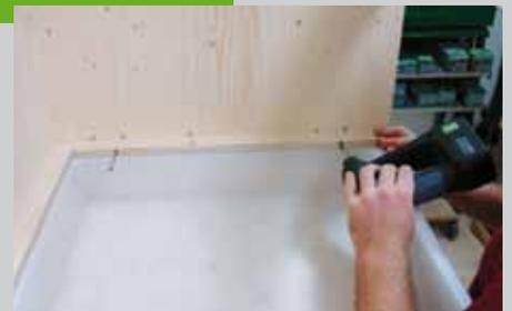
Um der Kunststoffwanne eine Auflage zu schaffen, werden rechts und links zwei Sperrholzstreifen (Pos. 14) eingeschraubt. Schieben Sie dann die Wanne ein und schrauben Sie darüber als Abdeckung noch eine weitere Holzleiste (Pos. 10 + 11). Dadurch wird verhindert, dass Schmutz seitlich an der Wanne vorbei fällt.
