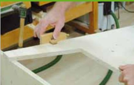
2. Die Wände werden mit Edelstahlschrauben (3,5 x 45) offen miteinander verschraubt. Um die Schraubenlöcher schneller anzuzeichnen, markieren Sie diese zunächst mit einem Streichmaß parallel zur Kante und bohren mit einem 3,5 mm Bohrer die Löcher für die Schrauben in einem Abstand von ca. 200 mm. Verschrauben Sie die Außenwände. In die beiden niedrigen
