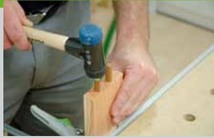
Dübellöcher in einem Bauelement gebohrt sind, werden alle sichtbaren Kanten mit einem Handschleifklotz oder einer Kantenfräse großzügig abgerundet. Die Verbindungen werden alle mit witterungsbeständigem Leim (D4) oder PU (Polyurethan) Kleber miteinander verklebt. Zunächst werden die Dübel in die Streben eingeleimt. Schlagen Sie die
