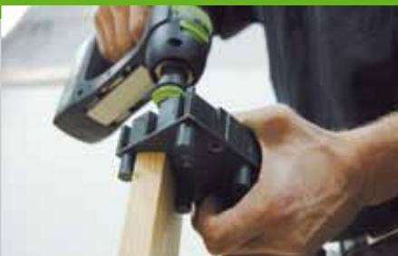
2. Zum Verbinden der Gestellteile werden wasserfeste Dübel mit einer Dicke von 8 mm verwendet. In das Querholz der Streben (Pos. 3 + 4) jeweils zwei Dübellöcher bohren. Um genau bohren zu können ist es hilfreich, eine Dübelschablone zu benutzen. Diese wird von oben auf das Brett aufgesetzt und hat auf der Unterseite Zapfen, um sie exakt zu positionieren.
