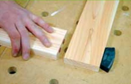
4. Bei den restlichen Verbindungen ist der Arbeitsablauf der gleiche. Es wird immer zunächst die Position der Bretter zueinander angezeichnet. Dann werden mit der Dübelschablone in das Querholz zwei Löcher gebohrt und diese mit Dübelspitzen auf das Gegenstück übertragen.
