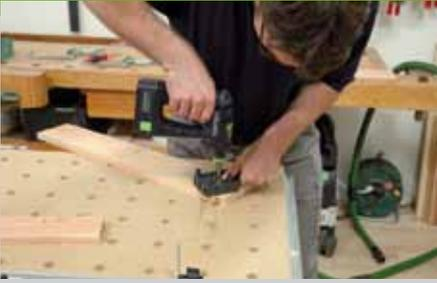
3. Verstellen Sie die Bohrtiefe und bohren Sie jetzt auch die Löcher in die Seiten (Pos. 1). Damit auch diese Löcher genau senkrecht werden, sollten Sie auch hier die Dübelschablone verwenden. Wenn die Anzahl Ihrer Zwingen begrenzt ist, sollten Sie die einzelnen Elemente zeitversetzt verkleben. Das heißt, sobald die
