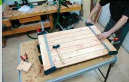
Achten Sie bei allen Bauteilen darauf, dass sie im rechten Winkel miteinander verbunden sind. Nach dem Aushärten wird überschüssiger Kleber mit einem Stemmeisen entfernt. Polyurethankleber kann nicht wie Leim im feuchten Zustand mit Wasser entfernt werden.
