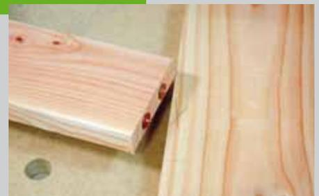
Mit den kleinen Zentrierdornen der Schablone, die in die Dübellöcher eingesteckt werden, wird die Position der Löcher auf das Gegenstück übertragen. Zunächst müssen die genauen Positionen der Bretter angezeichnet werden. Dann wird mit eingesteckten Spitzen eine Strebe an ihre Position auf der Seite gedrückt. Die so entstehenden Vertiefungen sind die Mitten der Löcher.
