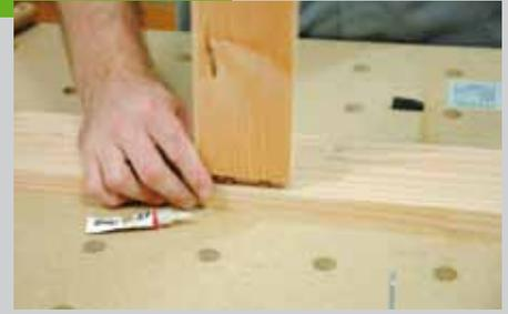
Dübel mit einem Hammer ganz in das Loch ein. In den Gegenlöchern wird auch Kleber angegeben und das Gestell wird zusammengesteckt. Verspannen Sie die Teile mit Zwingen, achten Sie darauf, dass alle Stoßfugen geschlossen sind und das Untergestell rechtwinklig verspannt ist.
