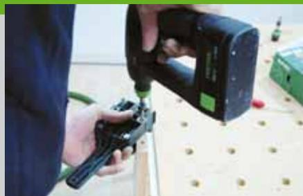
Verdreht man die Schablone bis die Zapfen anliegen, ist das gewünschte Dübelloch genau in der Mitte des Brettes. Bei einer Dübelgröße von 8 x 40 mm werden die Löcher in die Streben ca. 25 mm tief gebohrt und in die Seiten mit 15 mm. Um alle Löcher gleich tief zu bohren, einen Tiefenbegrenzer verwenden. Bohren Sie jetzt alle Löcher in die Streben.
