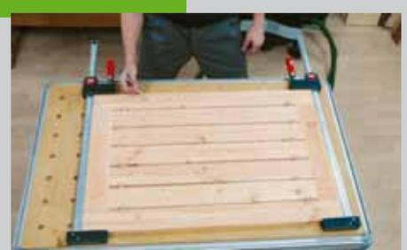
Zwischen die Latten der Tischplatte (Pos. 7) werden 8 mm dicke Abstandsklötze gelegt.
