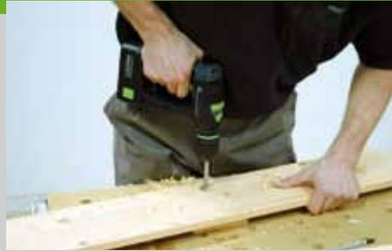
eines Sonnenschirms passt. Jetzt kann die Abdeckplatte (Pos. 2) mit Schrauben (Spax 3,5 x 35) von unten mit dem Gestell verbunden werden. Die Schraubenlöcher werden mit einem 3,5 mm Bohrer vorgebohrt. Dann wird das Loch für den Sonnenschirm auch durch die darunter liegende Strebe gebohrt. Als Endpunkt für den Sonnenschirm dient
