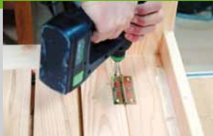
Spannen Sie das Gestell des Tisches mit der Oberseite nach unten auf dem Arbeitstisch fest. Legen Sie die Platte mit der Oberseite nach unten davor und verbinden Sie beide Teile mit zwei Scharnieren. Befestigen Sie auch an den Abstützungen jeweils zwei Scharnieren. Die Abstützungen werden jetzt am Gestell befestigt.
