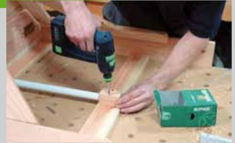
ein Klotz (Pos. 10) mit dem gleichen Loch, der auf der unteren Strebe angeschraubt wird. Bei Holzgeländern wird der Tisch durch die hintere Strebe am Geländer festgeschraubt. Bei Metallgeländern wird der Tisch mit einem Brett von Außen und durchgehenden Schrauben festgeklemmt.
