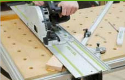
1. Sägen Sie die Einzelteile des Tisches auf das in der Materialliste angegebene Maß zu. Die beiden Diagonalstreben (Pos. 8) des Untergestells werden auf beiden Seiten mit einer Schräge von 45 Grad abgesägt. Legen Sie die Einzelteile der Abstützungen (Pos. 8 + 9) so zusammen, wie sie später verklebt werden.
