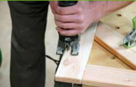
5. An den oberen Schmalfächen der Abstützungen wird mit der Stichsäge jeweils eine Aussparung gesägt. Alle Kanten und Flächen sollten mit einem Exzentrerschleifer oder einem Handschleifklotz geschliffen werden. Letzter Schliff Körnung P180. Wenn Sie den Tisch farbig gestalten möchten, müssen die Einzelteile vor dem Zusammenbau gestrichen werden.
