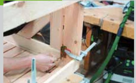
Spannen Sie dazu die Scharnieren mit einer Zwinne fest. Es ist hilfreich, die genaue Mitte der Löcher mit einem Spitzbohrer vorzustechen. Die erste Abstützung wird mit der Vorderkante der Scharniere bündig am Gestell befestigt. Die zweite muss so weit von der Vorderkante zurückstehen, dass sich beide beim Zusammenklappen nicht behindern.
