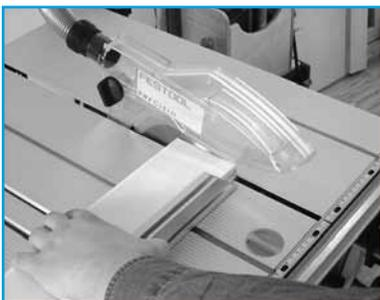
**19** Absägen der Schubkastenblende; Die Ecken mit einem Schleifklotz brechen, die Kanten mit der Oberfräse runden und schleifen; Flächen schleifen
