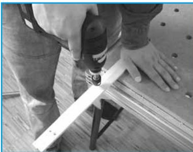
**20** Bohren der Führungsleisten mit dem Senkbohrer mit Tiefenanschlag
