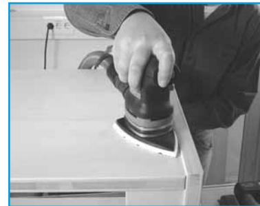
**22** Wegschleifen letzter Wasserflecken und Kratzer, mit dem Schleifer (DS 400), Körnung P 180
