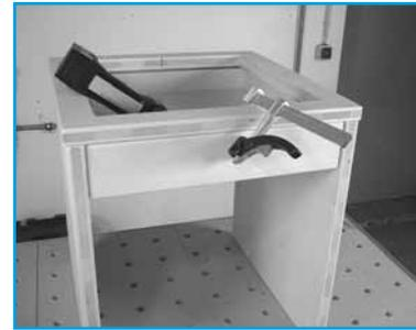
**24** Schubkasten einschieben, Blende mit Klemmzwinde fixieren, ausrichten und festschrauben
