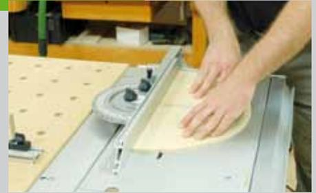
Die Breite der Nut entspricht wieder der Dicke des Materials, die Tiefe ist 2 mm. Stellen Sie die Unterkante der Nut am Anschlag der Tischkreissäge ein. Um die Höhe des Sägeblattes genau einzustellen, sollten Sie einen Probeschnitt machen. Schneiden Sie den ersten Schnitt auf jeder Seite der Mittelwände ein.
