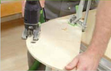
3. Der Griff wird auch mit der Stichsäge und dem Kurvensägeblatt ausgeschnitten. Um die beiden Schlitzte zu sägen, sollten Sie ein breites Sägeblatt für gerade Schnitte in die Stichsäge einsetzen. An jeder Flanke des Schlitzes wird ein Einschnitt bis zum Endpunkt gesägt, dann zieht man die Säge ca. 20 mm zurück und schneidet diagonal zum Ende des anderen Schnittes.
