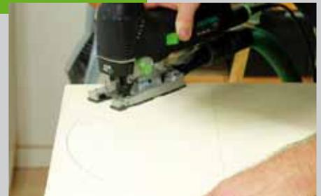
Kreise aus. Es kann hilfreich sein, zuvor ein paar Probeschnitte an Holzresten zu testen, um ein Gefühl für die Handhabung der Maschine zu bekommen. Alternativ zur Stichsäge können Sie die Kreise auch mit einer Laubsäge ausschneiden.
