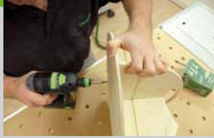
genaue Position der Mittelseite und schrauben Sie die beiden Seiten von unten mit Spax 3 x 30 fest. Sie können auch jeweils die Schraubenspitze zum Ausrichten der Mittelseiten benutzen. Geben Sie jetzt Leim in der Nut an und stecken Sie die Viertelkreise hinein. Falls Sie verschiedene Lochdurchmesser
