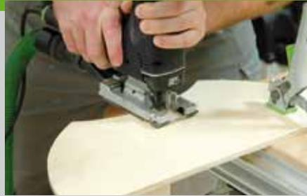
Das Material, das noch stehen bleibt, wird mit kleinen Schnitten herausgesägt. Schneiden Sie die beiden Schlitzte möglichst exakt und testen Sie durch zusammenstecken der Mittelseiten, ob alles passt. Unten wird in die Halbkreise eine Nut gesägt, in die später die Viertelkreise mit den Löchern für Flaschen und Gläser eingeleimt werden.
