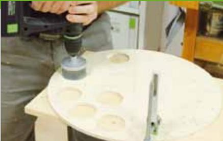
5. Mit einer Lochkreissäge oder der Stichsäge werden die Löcher ausgeschnitten. Es ist auch hier wieder sinnvoll, wenn Sie ein Brett unterlegen um Ausrisse zu vermeiden. Zeichnen Sie anschließend die genaue Größe der
