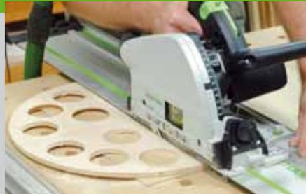
Viertelkreise an und zerschneiden Sie den Kreis mit einer Handkreissäge oder der Stichsäge in vier Teile. In den Boden werden vier Löcher ( $D = 3$  mm) gebohrt, um ihn später mit der Mittel-seite verschrauben zu können.
