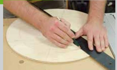
An den Schnittpunkten zwischen den Kreisen und den Mittellinien können Sie mit dem Zirkel die ersten Löcher anzeichnen. Zwischen der Kante der mittleren Löcher und den Außenkanten des Viertelkreises wird in der Mitte jeweils eine Markierung auf dem großen Kreis eingezeichnet. Das ist der Mittelpunkt der äußeren Löcher.
