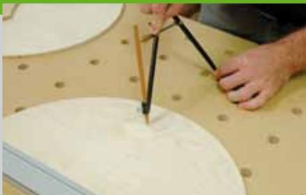
2. Zeichnen Sie auf dem Halbkreis (Pos. 1) mit dem Zirkel die Form des Griffs auf. Da der Mittelpunkt beim unteren Radius bei beiden Mittelseiten außerhalb des Werkstücks liegt, müssen Sie auf dem Arbeitstisch eine Mittellinie einzeichnen und dort die Halbkreise mit der Mitte anlegen. Dann wird an dieser
