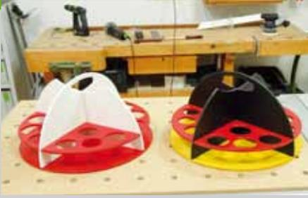
6. Wenn Sie das Tablett farbig gestalten möchten, sollten Sie es vor dem Zusammenbau streichen. Zum Zusammenbau werden zunächst die beiden Mittelseiten übereinander geschoben. Geben Sie dann in der Nut Leim an und stecken Sie die Viertelkreise hinein. Markieren Sie auf dem Boden die
