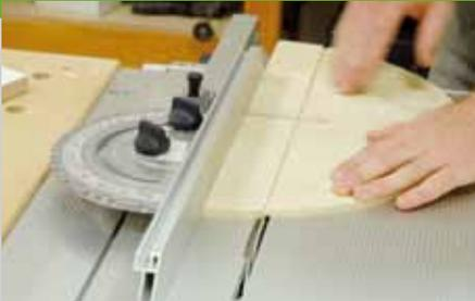
4. Verstellen Sie den Anschlag um die Sägeschnittbreite und schneiden Sie die Nut breiter. Das Probestück wird immer mitgeschnitten. Der letzte Schnitt, mit dem die Nut genauso breit wie die Materialdicke geschnitten wird, kann dann zunächst am Probestück gemacht werden. Dann stecken Sie eine Sperrholzstück ein und kontrollieren ob die Nut breit genug ist. Jetzt werden die
