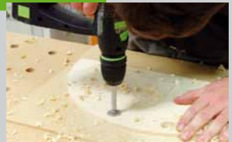
Halbte einen Schlitz einsägen. Die Schlitzbreite entspricht der Materialdicke. Die Länge des Schlitzes ist die halbe Strecke bis zur Unterkante des Griffs. Bohren Sie die beiden Löcher (D = 25 mm) am Ende des Griffs. Eine untergelegte Platte verhindert, dass die Löcher auf der Rückseite ausfransen.
