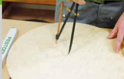
letzten Schnitte an den Mittelseiten gemacht. Auf dem oberen Boden (Pos. 4) werden die Positionen der Löcher für die Flaschen und Gläser angezeichnet. Zeichnen Sie zunächst mit zwei Kreisen ( $r = 80$ ,  $R = 162$ ) den Abstand der Löcher vom Mittelpunkt an. Dann werden in die Viertelkreise Mittellinien (Winkelhalbierende) eingezeichnet.
