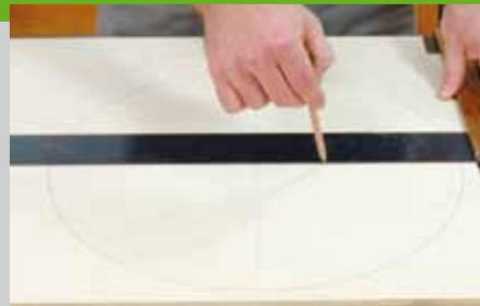
den Mittelpunkt ein Kreuz gezeichnet, das den Kreis in vier Viertelkreise teilt. Mit einer Stichsäge wird der Kreis möglichst genau ausgesägt. Achten Sie darauf, dass ein scharfes Kurvensägeblatt verwenden und sägen Sie möglichst gleichmäßig und mit Ruhe die
