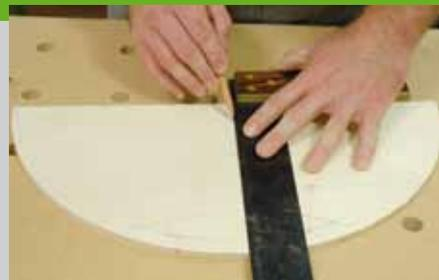
Mittellinie der Zirkel eingestochen und der untere Radius angezeichnet. Der Griff endet auf beiden Seiten in einer Bohrung. Für diese muss der Mittelpunkt des Bohrloches angezeichnet werden. Um die beiden Mittelseiten übereinander stecken zu können, müssen Sie auf jeder Wand bis zur
