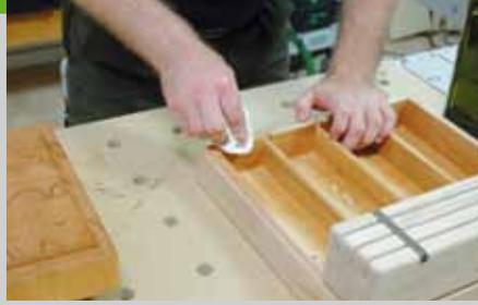
Schleifen Sie nach dem Trocknen noch einmal alle Kanten von Messerbank und Untergestell nach und entfernen Sie alle eventuell vorhandenen Leimreste mit einem scharfen Stemmeisen. Ölen Sie alle Teile satt mit Olivenöl und lassen Sie es über Nacht ins Holz einziehen.
