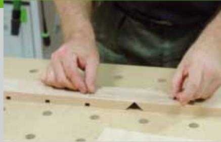
Vor dem Verleimen des Untergestells muss der Boden (Pos. 3) geschliffen werden. Legen Sie die Seiten des Untergestells wie eine Abwicklung in der richtigen Reihenfolge mit der Innenseite nach unten auf den Arbeitstisch. Die Gehrungen werden passgenau ausgerichtet und jede Verbindung mit einem Klebestreifen fixiert.
