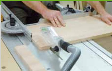
1. Das Schneidbrett (Pos. 4) wird aus einzelnen Streifen zusammengeleimt. Diese Streifen mit einer Tischkreissäge von der Leimholzplatte absägen. Legen Sie die einzelnen Streifen auf den Arbeitstisch und geben Sie den Leim an. Mit einem Leimpachtel wird er so verteilt, dass sich auf der gesamten
