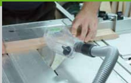
Jetzt können Sie die genaue Länge für das Untergestell anzeichnen. Das Gestell wird quadratisch, deshalb werden die vier Seiten genau auf die gleichen Längenmaße abgesägt. Die 45 Grad-Gehrung an den Ecken muss möglichst genau sein. Schneiden Sie zuvor aus Holzresten einen Proberahmen, um die Winkeleinstellung der
