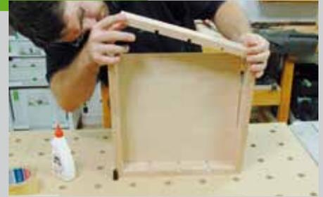
Drehen Sie die zusammen geklebten Seiten um und klappen Sie sie, mit dem Boden in der Nut, zusammen, um die Passgenauigkeit zu prüfen. Klappen Sie die Seiten wieder auseinander und geben Sie in den Verbindungen Leim an. Verspannen Sie anschließend die Seiten mit einem Streifen Klebeband.
