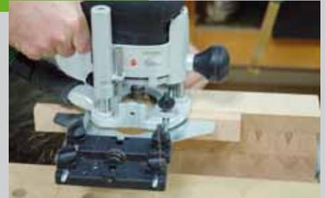
ein Falz gesägt, um später das Schneidbrett besser greifen zu können. Alternativ können Sie die Falze auch mit einer Oberfräse mit Anschlag fräsen. Wenn es beim Fräsen zu dunklen Stellen (Brandstellen) am Holz kommt, müssen Sie die Drehzahl der Fräse vermindern.
