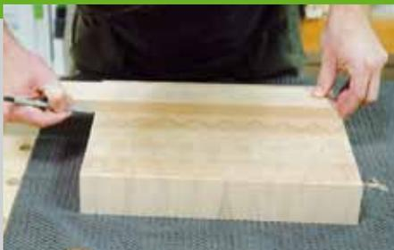
2. Für die Messerbank (Pos. 5) und für das Untergestell (Pos. 1) werden ebenso Streifen zugesägt. Die vier Streifen für die Messerbank werden, wie beim Schneidbrett, miteinander verleimt. Die genaue Länge und Breite des Untergestells ergibt sich durch das Schneidbrett. Schleifen Sie zunächst das Schneidbrett mit Körnung P80 vor.
