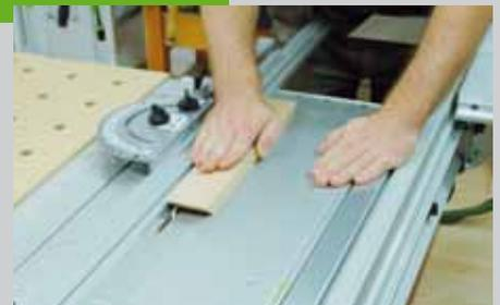
Maschine zu prüfen und gegebenenfalls zu korrigieren. Wenn die beiden Gehrungsschnitte an jedem Einzelteil gesägt sind, werden diese auf der Oberseite mit dem Schreinerdreieck gekennzeichnet. Unten an der Innenfläche wird in jede Seite eine Nut für den Boden gesägt.
