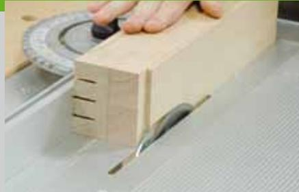
Tischkreissäge abgesägt. An der Unterkante der Messerbank und an Ober- und Unterkante des Schneidbrettes wird mit der Tischkreissäge jeweils ein Falz gesägt. Dadurch liegt das Schneidbrett mit beiden Seiten sicher auf dem Untergestell auf. An der Oberkante des Untergestells wird auch
