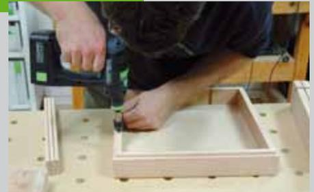
und ohne verrutschen auf der Arbeitsplatte und kann beim Schneiden nicht klappern. Die Trennwände werden mit einem Tropfen Leim in den Nuten des Untergestells befestigt. Schleifen Sie alle Teile mit einem Exzentrerschleifer, letzter Schliff Körnung P180.
