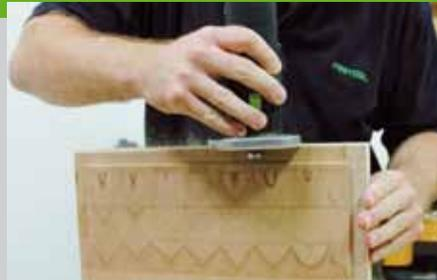
Länge abgeschnitten und an den Oberkanten gerundet. Runden Sie mit einer Fräse oder einem Handschleifklotz alle sichtbaren Kanten ab. Auf Ober- und Unterseite des Untergestells Löcher für Gummipuffer bohren. Durch diese Gummipuffer steht das Gestell sicher
