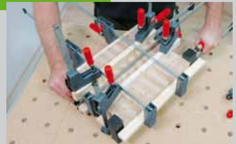
beiden Seiten, dass auch jede Lücke zusammengepresst ist. Gegebenenfalls setzen Sie lieber eine Zwinne zusätzlich an, um eine perfekt geschlossene Oberfläche zu bekommen. Der Leim wird nach dem Aushärten mit einem Stemmeisen oder einem Leimkratzer entfernt.
