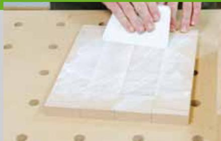
Fläche ein dünner Leimfilm bildet. Beim Zusammenspannen sollten die Zwingen zunächst nur leicht angezogen werden. Spannen Sie von oben und der Seite Kanthölzer an das Schneidbrett, um die einzelnen Streifen gegen Verrutschen zu sichern. Jetzt können Sie die Zwingen fest anziehen. Kontrollieren Sie von
