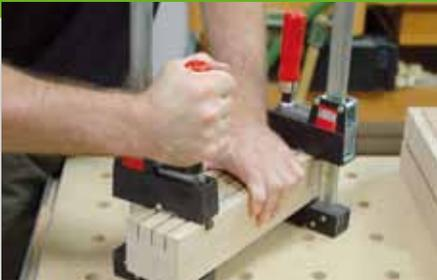
5. In die Oberseite der Messerbank werden zwei Nuten gesägt, in die Auflageleisten (Pos. 6) eingeleimt werden, um das Herausrutschen der Messer zu verhindern. Die Leisten (Pos. 2) für die Facheinteilung im Untergestell werden auf die passende
