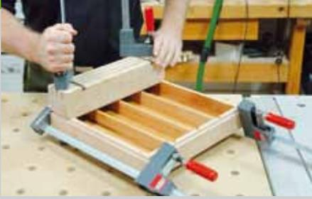
6. Ölen Sie das Untergestell nur innen mit Olivenöl. Auf der Messerbank wird Leim angegeben und sie wird mit Zwingen auf dem Untergestell festgespannt. Achten Sie darauf, dass die Messerbank auf allen Seiten mit dem Untergestell bündig abschließt.
