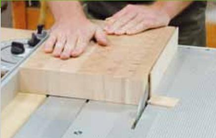
4. Entfernen Sie den überschüssigen Leim an der Messerbank und hobeln oder schleifen Sie eventuelle Überstände weg. Legen Sie das Schneidbrett und die Messerbank in der späteren Position zusammen und messen Sie die Breite. Falls diese zu groß ist, wird das Schneidbrett an der
