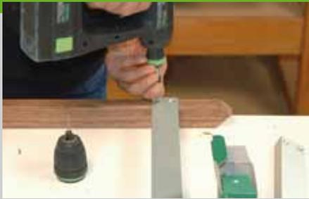
7. Verschrauben Sie (Spax 3,5 x 25) die Aluminiumwinkel (Pos. 11 + 12) mit den Beinen. Bei harten Hölzern sollten die Schrauben im Holz mit einem 2,5 mm Bohrer vorgebohrt werden. Die beiden entstandenen Rahmen des Untergestells werden im Drehpunkt mit den Schlossschrauben miteinander verbunden. Zwischen die Rahmen und unter die
