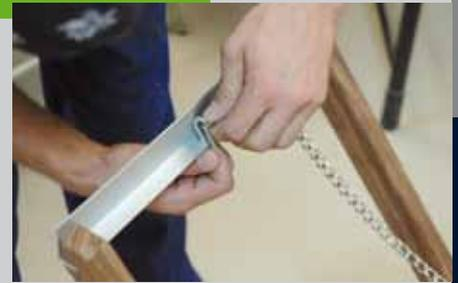
benötigen. Legen Sie auch die genaue Position der Bohrlöcher für die Karabiner auf den Aluwinkeln fest. Bohren Sie die beiden Löcher und schneiden Sie die Kette auf das benötigte Maß ab. Falls das Gestell zu eng ist können Sie durch größere Löcher die Breite erhöhen. Abschließend wird alles noch einmal mit einem transparenten Öl behandelt.
