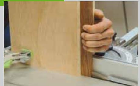
den Anschlag gespannt. Dahinter kommt ein zweites Brett um die Leiste genau positionieren zu können. Stellen Sie den Anschlag so ein, dass Sie genau in der Brettmitte schneiden. Bei dünneren Sägeblättern drehen Sie nach dem ersten Schnitt das Brett um 180 Grad, um mit einem zweiten Schnitt die benötigte Schnittbreite zu erreichen.
