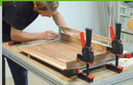
Entgraten Sie die Aluminiumkanten und runden Sie die Holzkanten mit einem Handschleifklotz. Beim Zusammenbau wird zunächst der Boden mit Kleber in das Aluminiumprofil eingeklebt. Legen Sie alle Leisten für die Tablettfläche zusammen. Ziehen Sie Ihr gemessenes Maß von 420 mm ab und teilen Sie es durch die Anzahl der Leisten, minus
