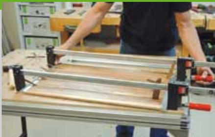
8. Alternativ zu der oben genannten Eckverbindung können Sie, mit einem anderen Aluminiumprofil, eine zwar optisch weniger schöne, dafür aber einfachere Verbindung herstellen. Die Holzleisten müssen dafür eine Dicke von 13 mm haben. Schneiden Sie die Holzleisten und die Aluminiumschienen auf das angegebene Maß ab.
