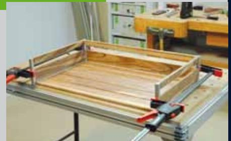
eine Leiste, um den Abstand zu ermitteln. Kleben Sie dann, wie auf den Bildern dargestellt, die restlichen Leisten ein. Es muss immer so viel Kleber angegeben werden, dass er beim Aushärten aus der Verbindung herausquillt. Entfernen Sie anschließend alle Kleberreste und ölen die Holzteile des Tablett.
