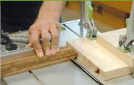
6. Die beiden Einschnitte in welche die Aluminiumprofile (Pos. 11 + 12) eingeleimt werden, werden mit der Tischkreissäge in die Tischbeine eingesägt. Beim Einschnitt oben wird das Sägeblatt schräg gestellt. Der Klotz auf dem Tisch dient als Anschlag. Machen Sie vorher auf jeden Fall einen Probeschnitt, um die genaue Schnitt-
