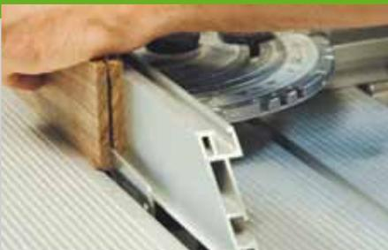
3. In den unteren Längskanten der breiten Leisten wird auch eine Nut eingeschnitten. Dafür wird der Holzanschlag abgebaut und die Leiste direkt am Anschlag entlang geschoben. Die Kanten der Leisten werden entweder mit einer Kantenfräse oder mit einem Handschleifklotz gerundet oder gefast. Die Flächen der Leisten werden mit
