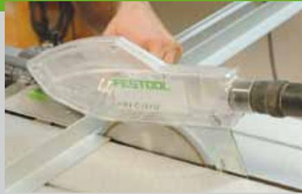
überstehen. Schneiden Sie dann mit einem Aluminiumsägeblatt oder einem feinen Universalsägeblatt die Aluminiumprofile auf das angegebene Maß zu. Beim Aluminiumschneiden sollten Sie eine Schutzbrille tragen um die Augen vor Spänen zu schützen. Wenn möglich
