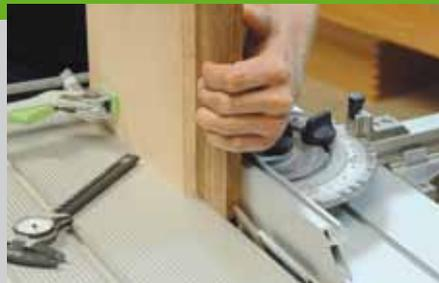
unserem Fall haben wir die Ausschnitte mit einer Zugsäge gemacht. Das bedeutet, das Werkstück wird fest am Anschlag positioniert und das Sägeblatt wird darunter durchgezogen. Falls Sie eine Tischkreissäge benutzen, sollten Sie die Leiste mit einem Holzklötz dahinter am Parallelanschlag entlang schieben. Bei der Zugsäge wird ein rechtwinkliges Brett als Haltehilfe an
