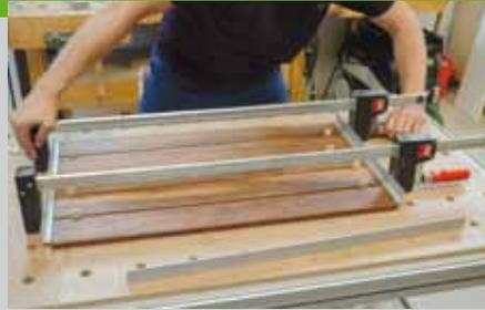
fünf Leisten (Pos. 5), die die Fläche des Tablett bilden, an ihrer Schmalfläche mit den beiden Aluminiumwinkeln (Pos. 7) verklebt. Als Abstandshalter werden 5 mm dicke Holzklötze verwendet. Im nächsten Schritt wird der hintere Aluwinkel (Pos. 6) eingeklebt. Nach dem Trocknen kann der überschüssige Kleber
