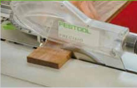
1. Es werden zunächst alle Teile für das Tablett zugeschnitten. Sägen Sie die Holzleisten auf das in der Materialliste angegebene Maß zu. Um beim Sägen von Holz einen sauberen Schnitt zu bekommen sollte das Sägeblatt bis zum Ansatz der Zähne über das Holz
