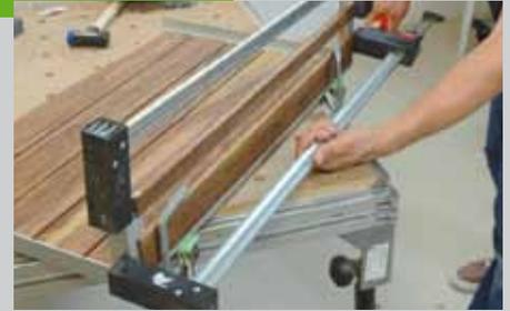
mit einem scharfen Stemmeisen oder einem Cuttermesser entfernt werden. Kleben Sie dann die breite Längsleiste (Pos. 1) auf den Aluwinkel (Pos. 6) und spannen Sie sie mit Zwingen fest. Als nächstes werden die beiden Eckwinkel (Pos. 8), unten bündig, und die schmale Leiste (Pos. 3) eingeklebt.
