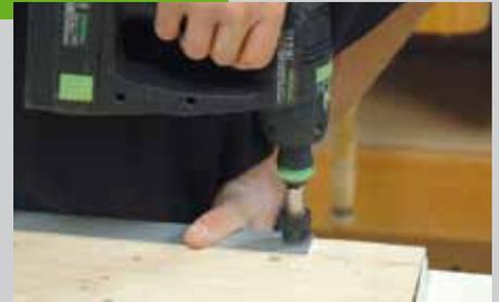
Winkeln an und bohren Sie Löcher mit einem 3,5 mm Bohrer. Runden Sie die Kanten an den Tischbeinen mit einem Handschleifklotz oder einer Fräse ab. Schleifen Sie die Beine, letzter Schliff Körnung P 180. Auch das Untergestell wird vor dem Zusammenbau mit Öl oder Lack grundiert.
