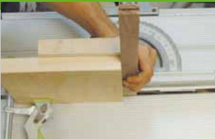
2. Die Aluminiumprofile werden im Querholz der Latten eingeklebt. Die dazu nötige Vertiefung wird auf der Tischkreissäge eingeschnitten. Sägen Sie zuvor einen Probeschnitt und stecken Sie das Alu-Profil hinein. Es sollte maximal 0,3 mm schmaler sein als der Schnitt. Falls der Spalt größer ist müssen Sie ein dickeres Profil oder ein dünneres Sägeblatt verwenden. In
