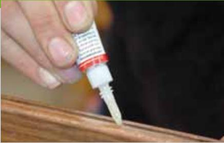
4. Der Zusammenbau und das Verkleben geschehen in mehreren Schritten. Jeder Bauabschnitt sollte vor Kleberangabe „trocken“ zusammengesteckt werden. Als Kleber wird ein Polyurethankleber verwendet. Der von uns verwendete Ponal X-PERT Turbokleber hat eine sehr kurze Aushärtezeit. Zunächst werden die
