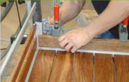
5. Die breiten Querleisten (Pos. 2) werden auf den seitlichen Aluminiumwinkel (Pos. 7) und in die Eckwinkel (Pos. 8) geklebt. Solange der Kleber noch feucht ist kann er auch mit einem Lappen und Waschverdünnung entfernt werden. Kleben Sie danach das Flachprofil (Pos. 9) und die schmalen
