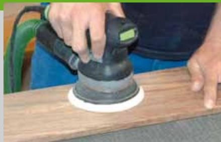
einem Exzentrerschleifer und einem Handschleifklotz geschliffen. Je nachdem wie sauber gehobelt wurde muss in mehreren Schritten, zuerst mit P 80, dann mit P 120 und abschließend mit P 180 geschliffen werden. Vor dem Verkleben sollte das Tablett einmal mit Öl oder Lack grundiert werden. In unserem Fall wurde ein Holzöl, Farbton
