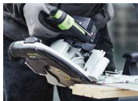
Kappschiene mit Anschlagssystem für wiederholgenaue Winkelschnitte.
