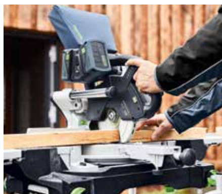
Exakt: LED-Schlaglicht zur Schnittlinienanzeige und optimale Sicht auf den Anriss.
