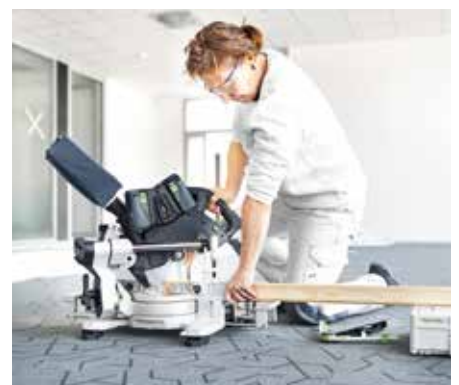
Die Zusatzfüße erhöhen den Arbeitstisch der KSC 60 exakt auf die Höhe des Systainers SYS 3 M 112 bzw. SYSTEMAINER SYS 1
