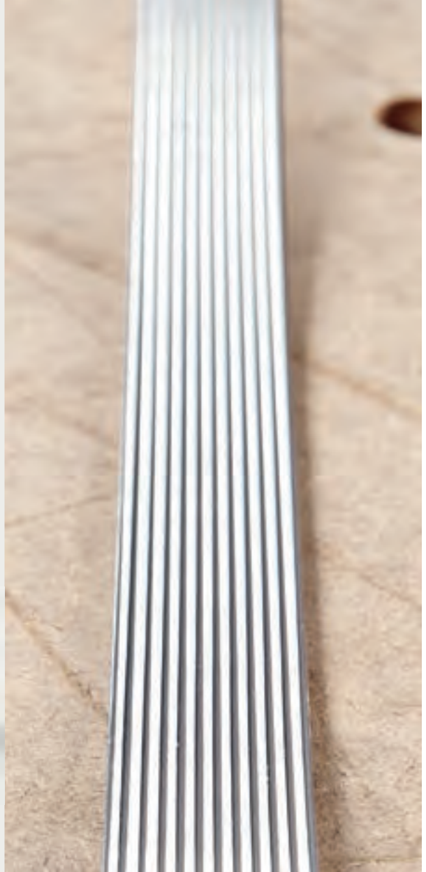
Leimauftrag auf der Kante
