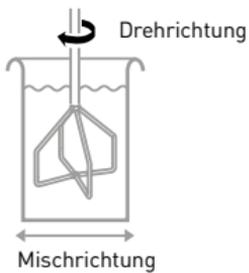
Verwirbelung des Materials für verlaufendes Rührgut. Vermeidet Lufteinschlüsse, z. B. bei Ausgleichs- und Spachtelmassen.
