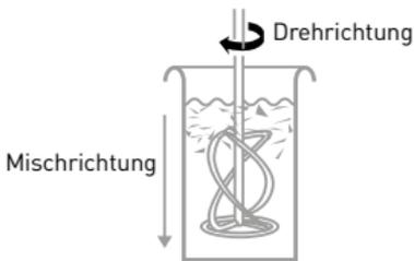
Für dünnflüssiges Rührgut (z. B. Lacke oder Wandfarben). Arbeitet von oben nach unten – so wird das Material nach unten gefördert. Vermeidet Materialspritzer.
