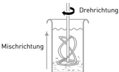
Für dickflüssiges, kompaktes Rührgut. Arbeitet sich wie eine Schraube in das Mischgut hinein und befördert das Material von unten nach oben.
