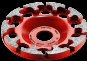
DIA ABRASIVE-D130 PREMIUM Für das Abfräsen stark sandhaltiger Materialien, Estrich, Frischbeton, Kleber auf Estrich, Kalksandstein und Porenbeton.
