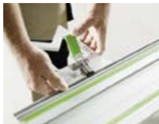
Plattenzuschnitt im 90°-Winkel Den Winkelanschlag FS-WA/90° einfach ansetzen, die Führungsschiene festklemmen – und los geht's! So gelingt der Plattenzuschnitt im rechten Winkel immer und ganz exakt.
