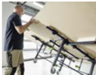
Ein-Mann-Bedienung Auf der Seite hat der Säge- und Arbeitstisch STM 1800 zwei drehbare Keile, mit denen man senkrecht an der Wand lehrende Platten einfach aufnehmen kann – ohne zusätzliche Hilfe.
