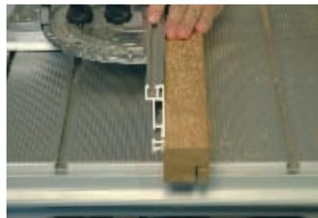
durch einen Probeschnitt. Beim Schneiden ist es wichtig, dass das Abfallstück am Schluss links vom Sägeblatt frei auf dem Maschinentisch liegt.
