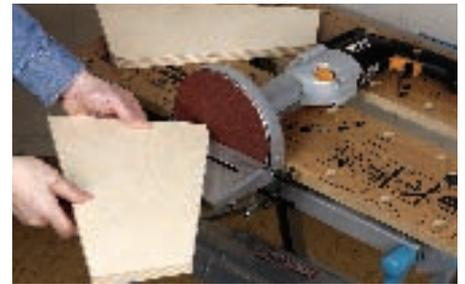
23. ... Seitenwand an der gleichen Position liegt, wird ein Anschlagbrettchen mit einer Zwinde befestigt. Sind beide Schrägen gesägt, wird die Kante noch mit dem Tellerschleifer oder einer Feile gerundet.
