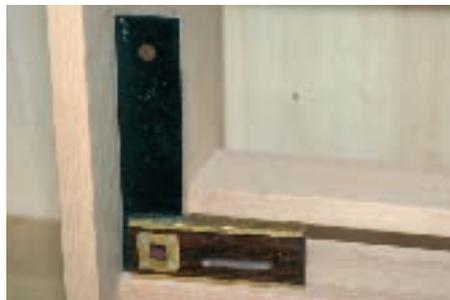
Anschlagwinkel braucht man beim Möbelbau zum präzisen Anreißen von rechtwinklig zur Werkstückkante verlaufenden Linien, zum Prüfen von rechten Winkeln an Brettkanten beim Sägen und Hobeln,
