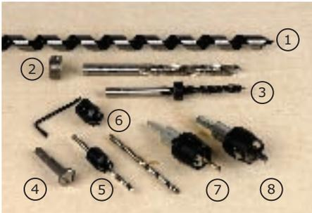
1. Schlangenbohrer (mögliche Bohrtiefen bis 385 mm), 2. Holzbohrer HSS mit aufsteckbarem Tiefenstopp, 3. Holzbohrer CV (Chrom Vanadium) mit Tiefenstopp, 4. Querlochsenker, 5. Spiralbohrer mit Aufstecksenker, 6. Aufstecksenker gedreht, auch als Tiefenstopp nutzbar, 7. Bohrer und Senker mit Tiefenstopp, 8. Holzbohrer (HM) 5 mm mit Tiefenstopp.
