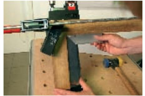
lange Zwinge nicht besitzen, können Sie auch zwei kürzere Zwingen in der Mitte zusammensetzen (hierbei am besten mit einem Helfen arbeiten). Am Schluss noch eine Zwinge quer auf die Verbindung setzen. Die Rechtwinkligkeit mit einem Winkel kontrollieren, wenn nötig durch Versetzen der Zwingen korrigieren.
