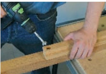
den Seitenleisten der Liegefläche an. Zum Bohren verwenden Sie am besten einen stationären oder mobilen Bohrständer. Zum Übertragen der Löcher auf die Liegestuhlseiten legen Sie die gebohrten Seitenleisten auf ihre spätere Position und kennzeichnen den Loch-
