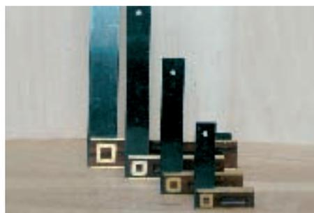
beim Zusammenbau von Werkstücken. Je nach Größe der Werkstücke (Leisten, Bretter, Platten) benötigt man unterschiedlich lange Winkel. Das macht auch Sinn, denn hat man sehr lange Winkel,
