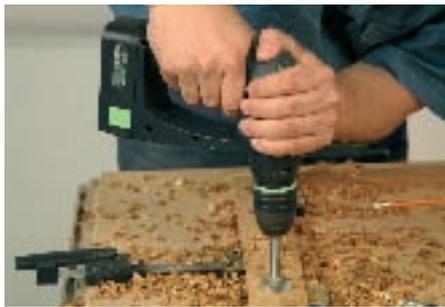
5. Zeichnen Sie die Aussparungen und das Loch für die Drehachse auf den Seiten des Klapprahmens (Rückenlehne) an. Beim Bohren der Löcher arbeiten Sie mit einem Unterlagebrett. Zuerst bohren Sie die Löcher, in denen später die Aluminiumstange einrastet, sowie
