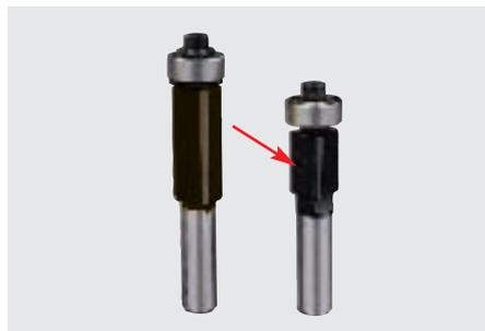
In unserem „Billig-Fräserkasten“ gibt es den Bündigfräser nur mit 12,7 mm langen und extrem dünnen Schneiden (re.). Damit lässt sich bestenfalls ein Furnierüberstand entfernen. Massivanleimer bündig fräsen oder ein 18 mm Leimholzbrett nach einer Schablone zu kopieren, ist nur mit den dickeren und doppelt so langen Schneiden des linken Qualitätsfräsers möglich.
