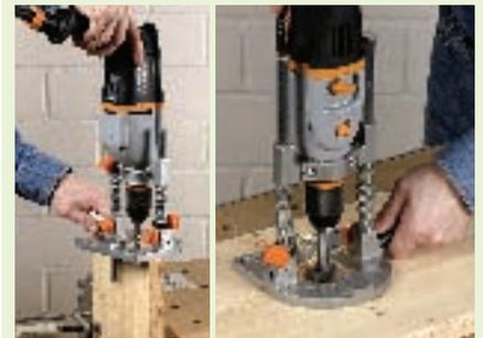
Wenn weit von der Holzkannte entfernte Löcher gebohrt werden müssen, ist der mobile Bohrständler eine große und oftmals die einzige Hilfe. Stehen die Führungsstangen aus der Grundplatte heraus, können exakt senkrechte Löcher in schmale Holzkannten gebohrt werden.
