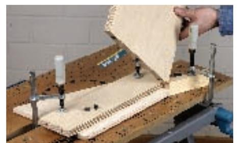
26. Die Stirnlöcher in Boden und Trichterfront werden wieder mit der Dübelhilfe gebohrt. Das Übertragen der Gegenlöcher übernehmen diesmal so genannte Dübelmarkierer.
