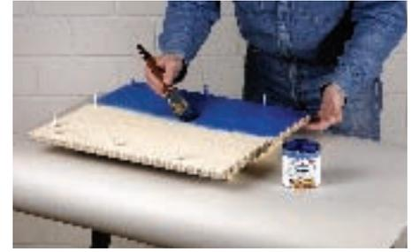
31. Wer trotz Farbe die Holzmaserung noch erkennen möchte, der kann entweder eine farbige Beize oder wie hier eine Lacklasur verwenden. Sie wird zweimal mit einem Flachpinsel in Maserrichtung aufgetragen (mit Zwischenschliff!).
