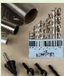
Auch eine Auswahl an hochwertigen HSS-Bohrern und Senkern für die Bearbeitung von Metall darf in der Holzwerkstatt nicht fehlen.
