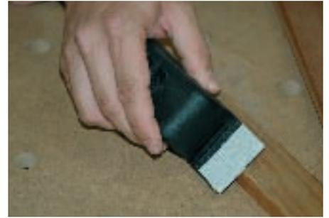
der Leisten schleifen. Nach ca. 2 Std. Trocknungszeit können Sie den verklebten Liegestuhl wieder ausspannen. Kleberreste mit einem scharfen Stemmeisen entfernen.
