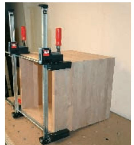
kann man die Zwingen auch zum Spreizen einsetzen. Die Korpuszwingen sind in Spannweiten zwischen 300 mm und 2500 mm verfügbar.
