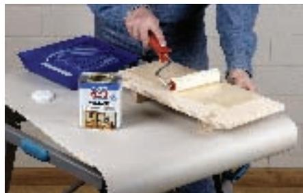
30. Der Klarlack wird am besten mit einer Rolle aufgetragen. Durchrocknen lassen und vor dem nächsten Auftrag mit feinem Schleifpapier (mind. P 280) zwischenschleifen. Ich empfehle Ihnen, die Klarlackflächen mind. dreimal zu lackieren.
