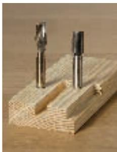
**Nutfräser** gibt es in den Durchmessern 2 mm bis ca. 25 mm als Spiralnutfräser (li.) oder als gerader Nutfräser (re.) mit aufgelöteten Schneiden. Spiralnutfräser haben durch ihre Form einen besseren
