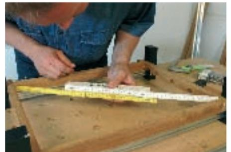
zen Rahmenteile einkleben. Dann den Kleber in den Löchern der Seitenteile angeben und alles mit Zwingen verspannen. Am Schluss den Winkel kontrollieren, am besten messen Sie dazu das Diagonalmaß.
