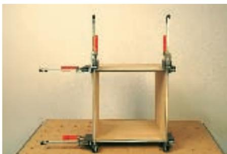
Typisches Merkmal dieser Zwingenart sind die großen und parallel geführten Spannflächen. Dadurch können Sie sich auch beim Spannen empfindlicher Werkstücke die Verwendung von Zulagen (kleine Bretter zum Schonen der Ober-
