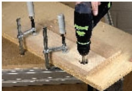
aus einem ca. 18 mm dicken Massivholz- oder Multiplexbrett hergestellt werden, in das man ein Loch im gewünschten größeren Durchmesser bohrt. Anschließend wird die Bohrschab-
