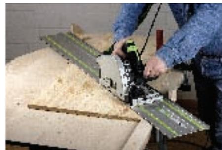
Das Werkstück einfach auf die Tischfläche und gegen die Anschlagleiste legen und mit Zwingen fixieren. Anschließend die Sägeschiene aufliegen und gegen die Anschlagbrettchen stoßen. Die Schiene mit den beiden Spezialzwingen unter ...
