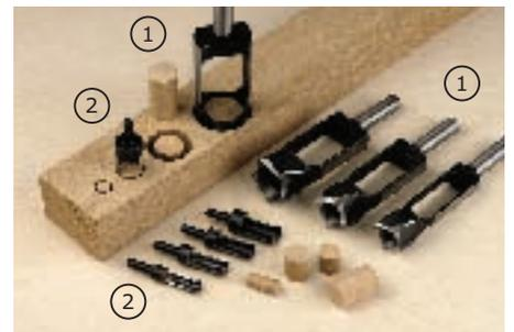
Querholzdübel sind ideal, um Astlöcher oder Schraubenköpfe abzudecken. Sie können mit Scheibenschneider (1) oder „Dübel-Cutter“ (2) leicht selbst hergestellt werden. Farbe und Maserung lassen sich so exakt auf das zu reparierende Holz abstimmen. Benutzen Sie beide Bohrer aber nur stationär im Bohrständer! Löcher für die Dübel können mit herkömmlichen Forstner- oder Kunstbohrern hergestellt werden.
