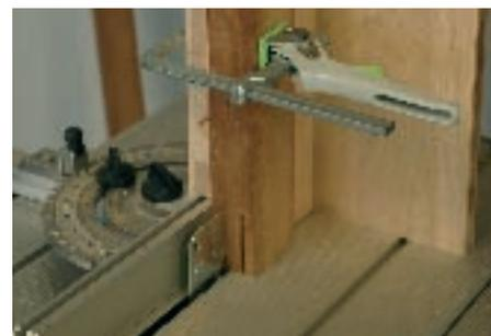
Erst wenn alle vier Enden so eingeschnitten sind, den Anschlag um Sägeblattbreite verstellen und den Zwischenraum heraussägen.
