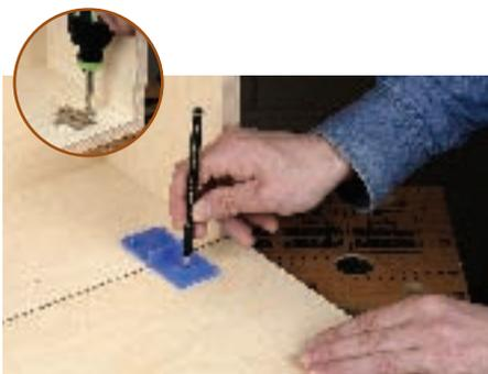
19. Die beiden Kunststoffstifte auf der Bohrlehre werden dann einfach in die gebohrten Löcher gesteckt und die Tür gegen die Bohrlehre geschoben. Die ...
