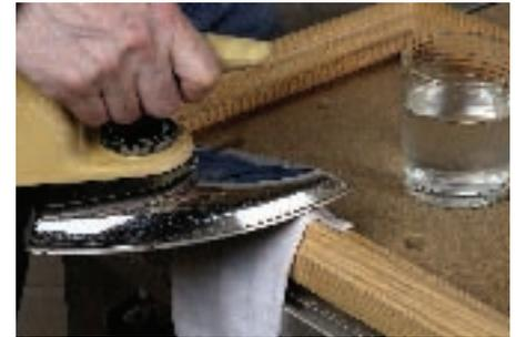
einmal gefaltet und auf die Druckstelle gelegt. Drücken Sie danach das heiße Bügeleisen auf den Lappen, bis kein Dampf mehr entsteht. Entfernen Sie den Lappen und begutachten Sie die Druckstelle. Gegebenenfalls wiederholen Sie den Vorgang, indem Sie den Lappen erneut anfeuchten. Haben die Holzfasern wieder ihre ursprüngliche Form erreicht, wird die Druckstelle weiträumig mit feinem Schleifpapier geglättet.
