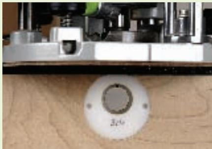
4. Die Frästiefe so einstellen, dass die Spitze des Fräasers knapp 1 mm in die Gewindebohrung hineinragt.
