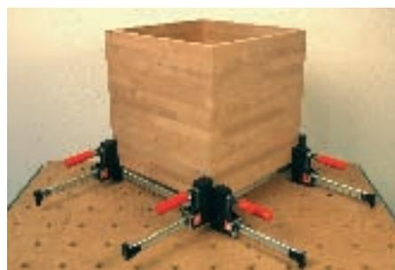
fläche) verzichten. Durch die parallel geführten Spannbacken können Sie sowohl gerade, als auch runde und spitze Werkstücke spannen. Das Unterteil der Zwingen kann ohne Werkzeug herausgenommen und gedreht werden, dadurch
