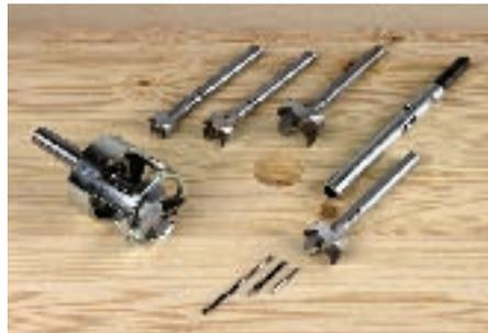
Die Kunstbohrer des ZOBO Bohrsystems von der Fa. Protool lassen sich durch unterschiedlich lange Zentrierspitzen, Schaftverlängerungen und aufsteckbare, kugelgelagerte Tiefenstopps sinnvoll ergänzen und der jeweiligen Anwendung optimal anpassen. Die Bohrer sind wahlweise in Chromstahl oder mit Hartmetall bestückten Schneiden in 1 mm Stufen von 10 - 130 mm (ZOBO 3) erhältlich.
