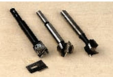
Für größere Löcher können Forstnerbohrer (Mitte) in verschiedenen Durchmessern eingesetzt werden. Bei Harthölzern und Plattenwerkstoffen sollte man aber besser zu den mit Hartmetall bestückten Kunstbohrern (rechts) greifen. Wer ein bestimmtes Bohrlochmaß benötigt, aber keinen passenden Bohrer findet, dem hilft ein stufenlos verstellbarer Zentrumsbohrer (links).
