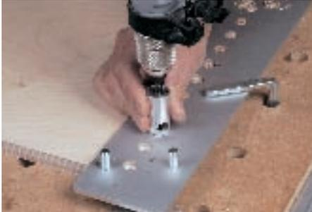
1. Bohren Sie in den Korpusseiten zunächst die Lochreihen. Achten Sie darauf, dass der Bohrbalken exakt mit den Stiften an der oberen und seitlichen Korpuskante anliegt. Die kugelgelagerte Hülse halten Sie mit einer Hand fest.
