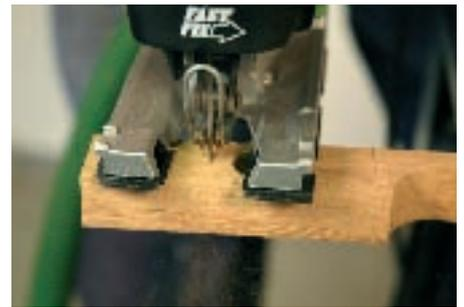
einer Handsäge vollständig heraussägen. Die beiden Seitenteile laufen am oberen Ende in einem Halbkreis aus. Zeichnen Sie diesen an und sägen Sie ihn mit der Stichsäge aus.
