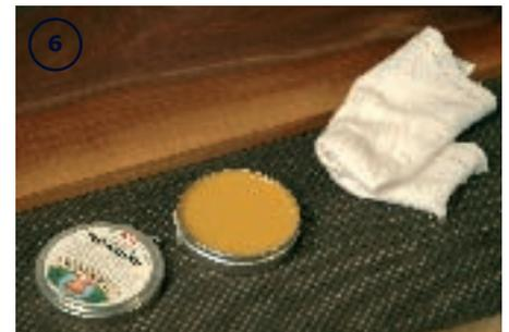
Beim Wachsen eines Werkstückes ist es oft sinnvoll, dieses vorher mit einem Öl zu grundieren, denn dies erhöht die Wasserbeständigkeit der Oberfläche erheblich. Zu diesem Zweck sollten Sie die Fläche mit einem 180er Schleifpapier gründlich schleifen. Nach dem Entstauben kann das Öl mit Hilfe eines Pinsels oder Lappens aufgetragen werden. Um den Zwischenschliff zu vermeiden, können Sie das Öl nass mit dem Exzentrerschleifer und Schleifvlies Körnung P 280 einschleifen.
