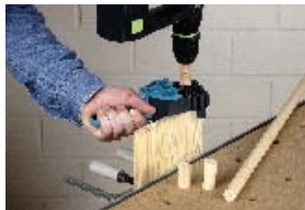
Rundstab Ø 20 mm. In die Stirnfläche des Rundstabs wird mit dem 8 mm Bohrer auf einem Bohrstander ein durchgehendes Loch gebohrt. Durch dieses Loch wird anschließend der Bohrer gesteckt. Indem der Bohrer tiefer oder weniger tief ins Bohrfutter eingespannt wird, lässt sich die Bohrtiefe noch leicht variieren.
