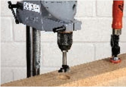
Spannen Sie ein Brett mit zwei Zwingen fest auf den Bohrständler und bohren Sie mit einem Forstnerbohrer (oder wie in unserem Fall mit einem 35 mm Kunstbohrer) ein Loch in das Brett. Tauschen Sie den Forstnerbohrer gegen den Bohrer mit dem gewünschten
