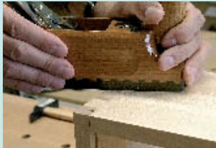
Bündig putzen von Zinken und Schwalben mit dem PRIMUS-Reform-Putzhobel: Schieben Sie den in der Hobelsohle eingelassenen Druckklotz relativ nah an die Schneide und stellen Sie das Eisen ganz fein ein. Hobeln Sie immer von der Kante der senkrecht stehenden Seite zu einer gedachten Mitte der waagrechten Seite. Sie können sich auch zwei diagonale Linien auf die Brettflächen zeichnen und zielen auf den Kreuzungspunkt. Den Hobel auch hier im ziehenden Schnitt führen.
