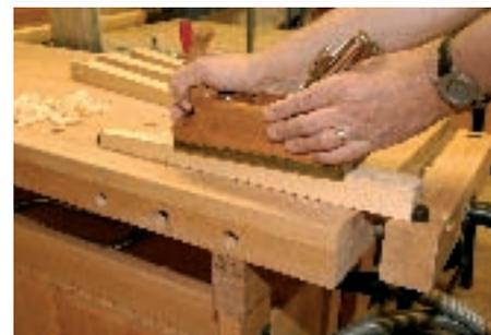
Schräge Tischbeine verputzen Sie mit einem fein eingestellten Putzhobel. Hobeln Sie möglichst immer in Faserichtung, in diesem Fall in Richtung Fußende, also zum sich verjüngenden Ende.
