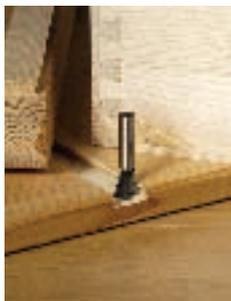
**Grat- und Zinkenfräser** werden in der Regel ausschließlich zum Herstellen traditioneller Holzverbindungen (Gratnut und -feder oder Zinken-Schwabenschwanzverbindungen) eingesetzt. Es gibt
