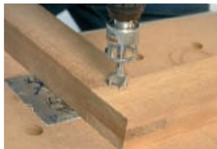
mittelpunkt durch Einstecken des Bohrers. Nun können Sie auch diese Löcher bohren. Um die Löcher alle auf die exakte Tiefe zu bohren, verwenden Sie am besten einen Bohrer mit Tiefenanschlag oder einen Bohrständer.
