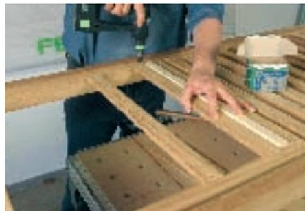
Anzahl der Leisten minus eine Leiste teilen. Das Ergebnis ist der Zwischenraum zwischen den Leisten. Schneiden Sie eine Abstandsleiste, die Sie beim Festschrauben zwischen die Leisten
