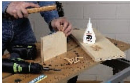
11. Leim in die Dübellöcher geben und 8 x 40 mm Runddübel mit dem Hammer einschlagen. Darauf achten, dass die Dübel maximal 12 mm vorstehen.
