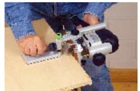
**Anleimer bündig fräsen:** Was sonst mit dem Handhobel vorsichtig bündig gehobelt werden muss, erledigt hier die Fräse sicher und absolut präzise.
