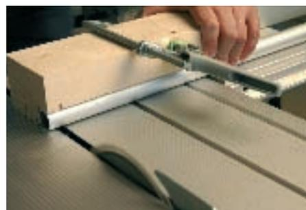
die Alu-Stange beim Schneiden darunter legen. Die Schnittkanten mit Schleifpapier oder Feile entgraten.
