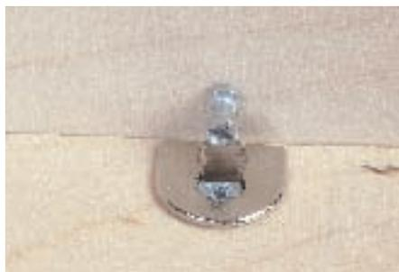
6. Anschließend werden beide Platten zusammengesteckt. Zum Verdrehen des Exzenters nehmen Sie einen Kreuzschlitzschraubendreher der Größe Pozidrive 2, den brauchen Sie auch zum Einschrauben der Einschraubdübel. Damit ist die Verbindung fertiggestellt. Und jetzt versuchen Sie es selbst einmal; beginnen Sie mit einem Probe-
