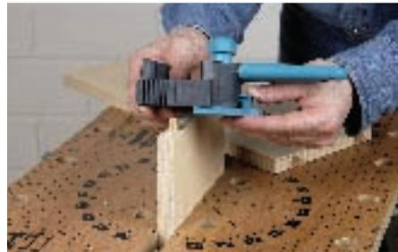
12. Anschließend die 8er Bohrbuchse der Dübelhilfe auf den Dübel stecken, den seitlichen Anschlag gegen die Brettseite schieben und Anschlag mit der Befestigungsschraube fixieren.
