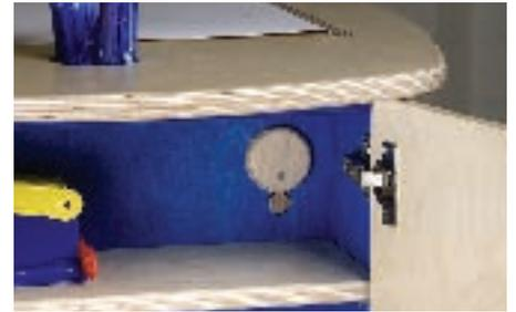
32. Zum Wechseln der Papierrolle kann der 18 mm Buche-Rundstab von der Schrankseite aus herausgezogen werden. Dazu muss nur die Abdeckung nach oben geschwenkt werden.
