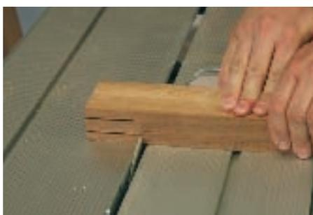
3. Bevor Sie den Zapfen am Fuß abschneiden, empfiehlt es sich, an einem Probestück die Passgenauigkeit zu prüfen. Der Arbeitsablauf ist ähnlich wie beim zuvor gesägten Schlitz. Mit dem Unterschied, dass anstatt den Zwischen-
