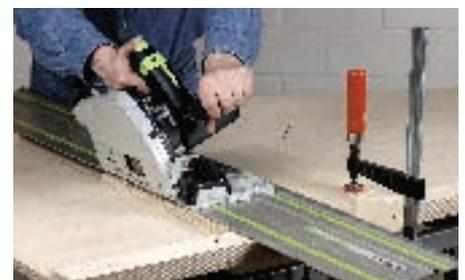
25. ... Winkel nicht genau mit unserem Bauplan übereinstimmt, solange Sie die Kreissäge genau nach ihrer Schräge einstellen. Anschließend die Schiene auf 90° einstellen und die Kante abschrägen.
