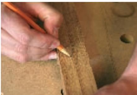
Schreinerdreiecks (die Spitze des Dreiecks zeigt immer zur Oberseite). Den Falz für die Auflageleiste müssen Sie mit der Tischkreissäge herausschneiden. Kontrollieren Sie die Sägeeinstellung
