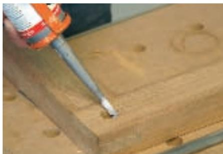
9. Bevor Sie die Einzelteile miteinander verkleben, sollten Sie den Stuhl einmal ohne Kleber zusammenstecken und kontrollieren, ob alles passt. Legen Sie nun beide Liegestuhlseiten flach auf den Arbeitstisch und geben Sie in den Löchern PU-Kleber an. Jetzt die Alumini-
