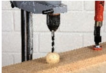
Durchmesser aus und legen Sie anschließend die Kugel in das zuvor gebohrte Loch. Da die Lage des Brettes nicht verändert wurde und die Kugel genau auf dem Rand der Bohrung aufliegt, befindet sich dieses Loch genau in der Mitte der Holzkugel.
