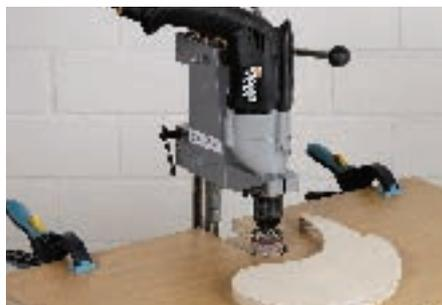
wird eine Holzplatte mit einer der Hülse entsprechenden Aussparung auf den Bohrständler gespannt. Schleifen Sie aber nur mit geringem Druck, um Schleifdellen zu vermeiden.
