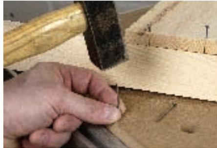
Werden Nägel nah am Brettende eingeschlagen, kommt es oft vor, dass die Holzenden „reißen“. Schlagen Sie einfach vorher mit dem Hammer leicht auf die Nagelspitze und „stauchen“ Sie den Nagel. So wird in aller Regel ein Reißen der Holzenden vermieden.
