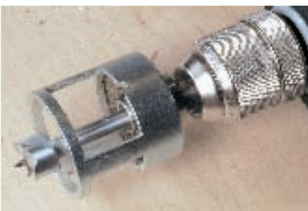
3. Zum Einlassen des Beschlages VB 35 muss ein sogenanntes angeschnittenes Sackloch mit 20 mm Durchmesser gebohrt werden. Angeschnitten bedeutet, dass das Loch seitlich offen ist. In diese Öffnung wird später der Einschraubdübel gesteckt. Dazu brauchen Sie einen guten Beschlagbohrer. Die Bohrtiefe beträgt 14 mm und sollte nicht überschritten werden um nicht durchzubo-
