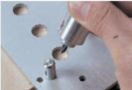
2. Platzieren Sie den Bohrbalken an den Ecken des Bodens und markieren Sie die Bohrlochmitten für die 20 mm Bohrung mit Hilfe des Hülsenbohrers, indem Sie die Bohrspitze ins Holz drücken.
