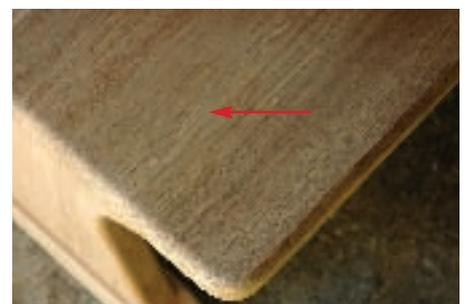
Leim in das Bohrloch und stechen Sie den Überstand mit einem scharfen Stechbeitel ab. Zum Schluss wird die gesamte Platte geschliffen und wenn der Dübel passend zur Holzfläche ausgewählt wurde, ist er nicht mehr zu erkennen (Pfeil).
