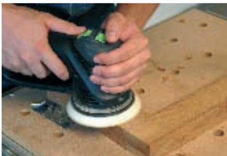
7. Nach ca. 2 Stunden Trocknungszeit können Sie die verklebten Liegestuhlseiten wieder ausspannen. Grobe Kleberreste entfernen Sie am besten mit einem Stemmeisen. Nun alle Teile mit einem Exzentrerschleifer (Körnung P 120) schleifen. Zeichnen Sie die Löcher auf
