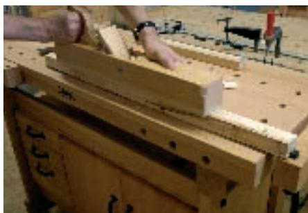
Zum Planhobeln (Abrichten) langer Flächen eignet sich die 600 mm lange Raubank. Dieser Hobel wird immer mit beiden Händen geführt. Eine Hand umklammert den Handgriff und schiebt, die andere drückt auf den vorderen Hobelkörper und zieht.
