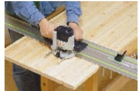
**Führungsschiene:** Im Gegensatz zum Parallelanschlag bietet sie eine freie Positionierung auf dem Werkstück und eine zwangsgeführte Oberfräse.
