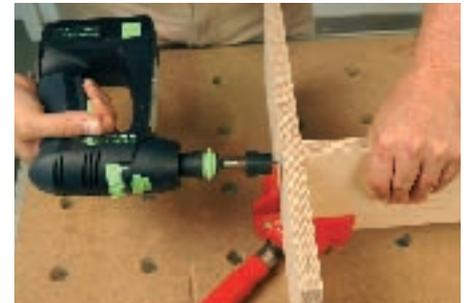
L-Ecken (Bild 1) und T-Stöße z. B. bei Sockeln (Bild 2) oder zur Fixierung von Fachböden gleichermaßen verwenden (Bild 3).
