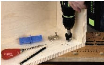
18. ... auf die Seitenwand übertragen werden. Anschließend werden mit einem 5 mm Holzbohrer zwei Löcher für die Befestigungsschrauben gebohrt.
