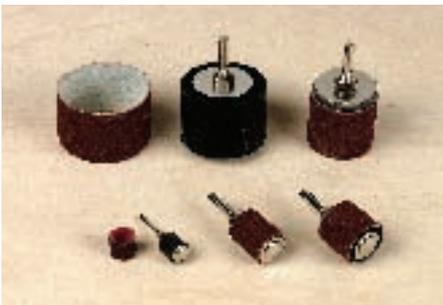
Innenradien können sehr gut mit so genannten Schleifhülsen bearbeitet werden. Die in verschiedenen Durchmessern erhältlichen Hülsen werden dazu in eine Bohrmaschine gesteckt, die stationär im Bohrständler betrieben wird. Damit die Hülsen etwas abgesenkt werden können,
