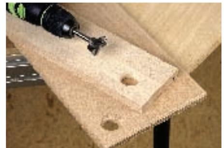
lone auf dem Brett ausgerichtet und mit zwei Zwingen befestigt. Ein „Wegdriften“ des Bohrers in der Schablone ist nahezu unmöglich.
