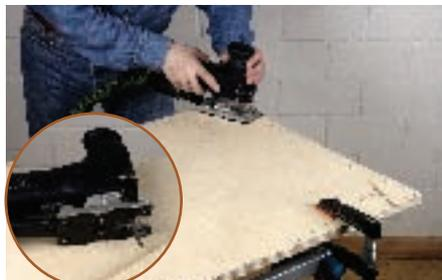
2. Danach ein fein gezahntes Stichsägeblatt (am besten aus HSS) und den Splitterschutz aus Kunststoff auf die Säge montieren und die Umriss aussägen.
