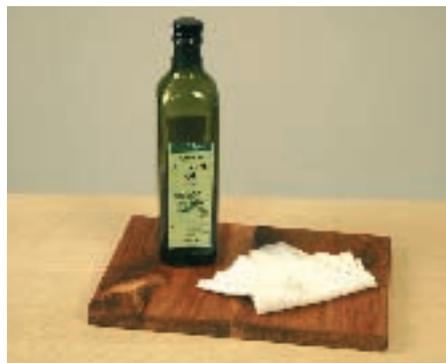
Olivenöl satt mit einem Lappen auftragen und über Nacht einziehen lassen. Bei stark beanspruchten Flächen können Sie diese Prozedur mehrmals wiederholen. Eine andere Auftragsmethode besteht darin, das geschliffene Werkstück direkt ins Öl einzulegen bis es sich voll gesaugt hat. Wenn es sich um Flächen handelt, die gespült werden, muss man eventuell nach dem Spülen mit einem Küchentuch nachölen.
