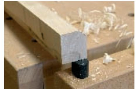
Die gewünschte Fasenbreite z. B. mit einem Gehrmaß am Stirnholz anzeichnen. Werkstück auf Kante gesetzt auf der Hobelbank einspannen. Den Hobel auf die Werkstückkante setzen und Fase in gleichmäßigen Hobelstößen anhobeln. Die Breite der Fase wird an den seitlichen Linien kontrolliert.
