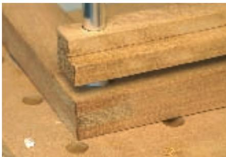
umstangen in eine Seite einstecken und zügig nacheinander Abstandshülse, die erste Seitenleiste, beim Kopfteil den Klapprahmen, die zweite Seitenleiste und wieder eine Abstandshülse auf die Stange schieben. Die zweite Liegestuhlseite aufstecken und mit Zwingen alles
