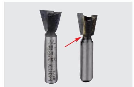
Die meisten billigen Grat- und Zinkenfräser überstehen in Hartholz nicht mal die ersten paar Zentimeter. Der auf fast 4 mm abgedrehte „Hals“ (Pfeil) des rechten Fräsers ist quasi eine Sollbruchstelle. Man mag gar nicht dran denken, wo solche Bruchstücke überall hin fliegen können. Am besten spannt man so einen Fräser erst gar nicht in die Oberfräse!
