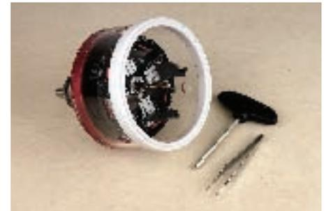
Der Kreisschneider der Fa. Protool bohrt Löcher von 50 - 120 mm Durchmesser, wobei die Schneiden und somit der Durchmesser in 0,2 mm Schritten präzise und schnell eingestellt werden können. Zwei Schneiden dienen als Vorritzer und stehen etwas weiter vor als die beiden Hauptschneiden. Dadurch sind absolut ausrissfreie Bohrlöcher garantiert.
