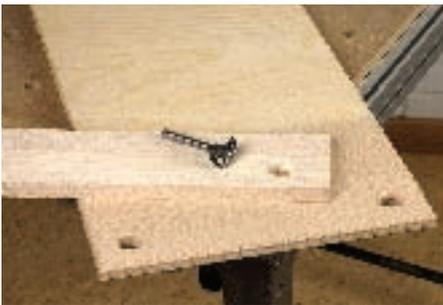
Ein bestehendes Loch größer zu bohren, ist nur mithilfe einer Bohrschablone möglich, da der Bohrer nicht mehr durch seine Zentrierspitze geführt werden kann. Diese Bohrschablone kann einfach
