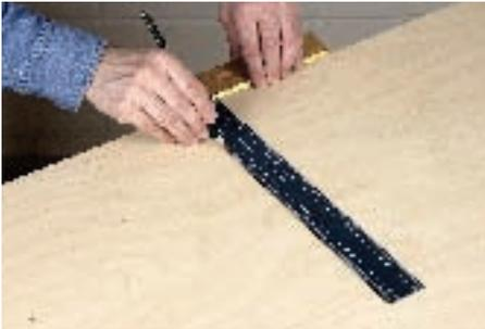
Vertrauen ist gut - Kontrolle ist besser. Dies gilt vor allen Dingen für den 90°-Schreinerwinkel. Denn schon eine Abweichung von einem halben Grad verursacht auf 1 m Länge einen Messfehler von über 8 mm. Die Genauigkeit eines Anschlagwinkels lässt sich aber schnell und einfach an einer geraden Platten-
