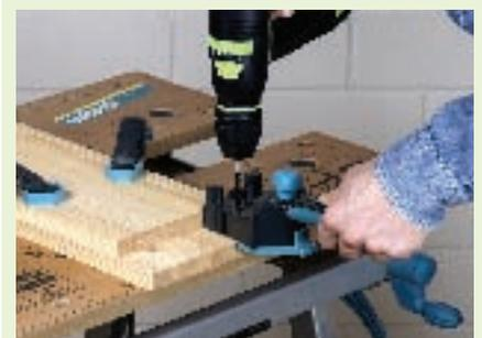
Wer Runddübel präzise einbohren möchte, kommt an einer Dübelbohrlehre nicht vorbei. Erst recht das Einbohren der Dübel in die Stirnholzfläche ist ohne Dübelhilfe nahezu unmöglich. Aber auch das Übertragen der Gegenlöcher ist mit diesen Bohrlehren kein Problem mehr.
