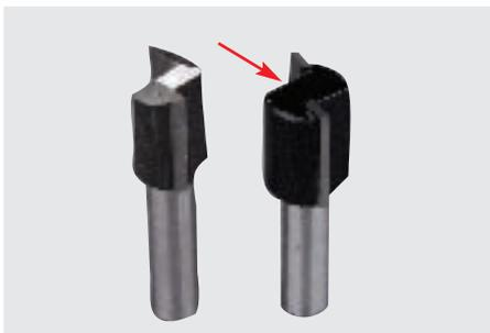
Das Eintauchen mitten ins Werkstück ist mit dem rechten Fräser unmöglich, da er keine angeschliffene Stirnfläche besitzt wie der linke Fräser. In besonders hochwertigen Fräsern wird zur Verbesserung der Eintauchqualität noch eine zusätzliche Hartmetallschneide in die Stirnfläche eingelötet.
