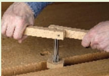
6. Für das Innengewinde zunächst in die Mutter ein 16 mm Loch bohren. Mutter einspannen und Schneideisen mit Hilfe eines Windeisens (Selbstbau aus Holz!) durch die Bohrung drehen.
