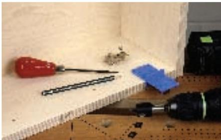
17. Mit der passenden Anreisschablone (als Zubehör bei den Topfscharnieren erhältlich) können die Bohrpunkte für die Montageplatte einfach mit einem Bleistift...
