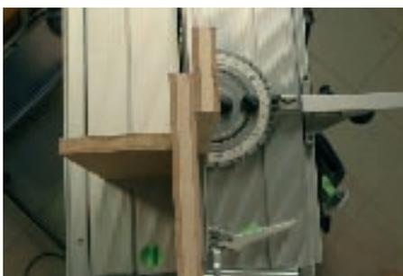
2. Um die Schlitz- und Zapfenverbindung zwischen den Beinen und der Querstrebe auf der Zugsäge herstellen zu können, benötigen Sie eine Schablone. Die Breite von Schlitz und Zapfen ist so gewählt, dass die
