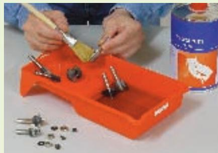
Ein mit Harz und Spänen verklebter Fräser wird zum Reinigen einfach in ein Petroleumbad gelegt. Nach einer kurzen Einwirkzeit kann der Schmutz mit einem Pinsel entfernt werden. Kugellager unbedingt vorher entfernen, da sich beim Kontakt mit dem Petroleum das Lagerfett auflöst. Eine andere Möglichkeit ist das Einsprühen des Fräasers mit Backofenspray. Nach einer zehnmütigen Einwirkzeit lässt sich selbst hartnäckiger Schmutz mühelos mit einem Lappen entfernen.
