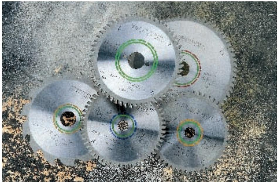
den billigen CV-Sägeblättern (Chrom-Vanadium) und den wesentlich teureren HW-Sägeblättern (Hartmetall-Werkstoff) kennen. Bei CV-Blättern sind nämlich Sägeblattkörper und Zähne aus dem gleichen Material, während bei HW-Sägeblättern der Körper aus hochwertigem Stahl und die Zähne aus einem aufgelöteten Hartmetall-Werkstoff bestehen. CV-Sägeblätter sollten Sie auf keinen Fall auf Ihre hochwertige Handkreissäge montieren, sie taugen im
