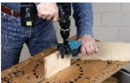
10. Bohrtiefe mit einem Tiefenstopp auf 28 - 30 mm begrenzen. Dübelhilfe auf die Brettkante legen und je zwei Löcher in die Holzkanten der Böden bohren.
