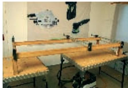
verspannen. Die Rechtwinkligkeit mit einem Winkel kontrollieren, wenn nötig durch Versetzen der Zwingen korrigieren.
