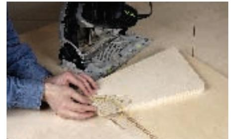
24. Um die Schräge der Bodenkante und der Trichterfront zu ermitteln, legen Sie einfach ein Geodreieck an die Trichterwand und lesen den Winkel ab. Es ist überhaupt kein Problem, wenn der ...
