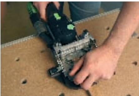
6. Bei unserer Liege wird der Klapprahmen mit Dominos (5 x 30) verbunden. Dazu müssen Sie den Leistenanschlag der Dominofräse auf die Leistenbreite einstellen und die Höhe der Klappe über die Schnellverstellung auf 20 mm einstellen. Zunächst werden
