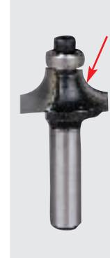
Die Schneide steht viel zu weit über den Grundkörper heraus. Das Hartmetallplättchen kann bei Harthölzern leicht abbrechen und aufgrund der fehlenden Spandickenbegrenzung besteht erhöhte Rückschlaggefahr!
