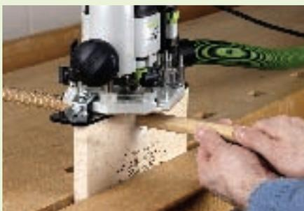
5. Oberfräse einschalten und 19 mm Rundstab in die Öffnung stecken. Dann den Stab im Uhrzeigersinn durch den Gewindeeinsatz drehen.
