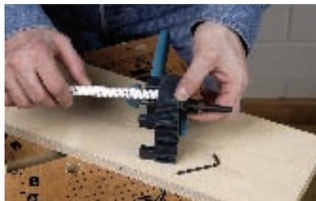
9. Benutzen Sie zum Bohren der Stirnlöcher einen 8 mm Metallbohrer. Der lässt sich mit der Bohrhilfe viel besser führen als ein Holzbohrer mit Zentrierspitze.
