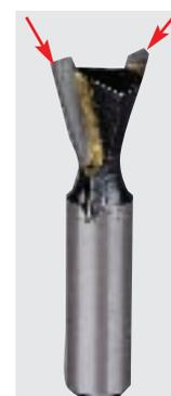
Schlecht aufgelötete Hartmetallschneiden, die bei extremer Belastung abbrechen können. Die beiden Spitzen (Pfeile) stehen zu weit über dem Grundkörper heraus und werden garantiert schon nach wenigen Metern abbrechen!
