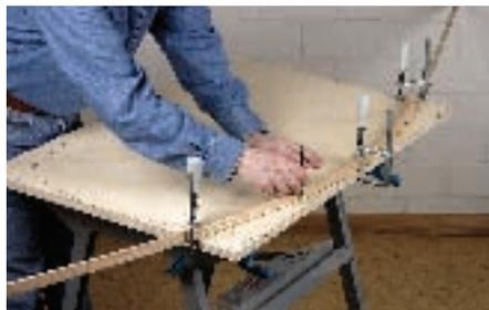
1. Die geschwungene Form der Tischkanten lässt sich am besten mit einer dünnen Holzleiste, die mit drei Zwingen gehalten wird, auf die Platte übertragen.
