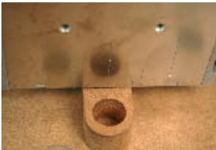
die Löcher in das Querholz der kurzen Rahmenteile gefräst. Danach die Klappe wieder nach oben klappen und die Dominofräse mit der Unterkante an den Positionen der Querstücke anlegen und die Löcher fräsen. Beim Verleimen zunächst den Domino-Dübel in die kur-
