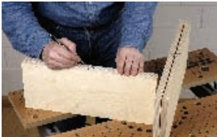
8. Damit die Schrankteile später nicht mehr vertauscht werden, sollten Sie die Seitenwände und Böden mit dem so genannten „Schreinerdreieck“ markieren.
