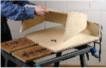
27. Stecken Sie anschließend den Trichter einmal ohne Leim zusammen und übertragen Sie die Dübellöcher wieder mit Dübelspitzen auf die Seitenwand.
