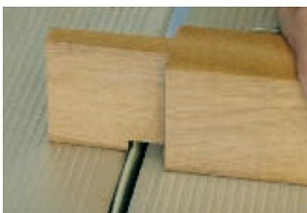
raum heraussägen, die Abfallstücke liegend auf der Zugsäge abgeschnitten werden. Falls die Schnitttiefe der Säge geringer ist als die Rahmenbreite, muss der Zapfen noch abgesetzt (auf der Innenseite abgeschnitten) werden. Die
