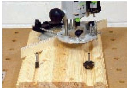
**Parallelanschlag:** Bei Nut- und Profilverfräsern ohne Kugellager wird die Fräse mittels Parallelanschlag oder einer Führungsschiene „auf Kurs“ gehalten.
