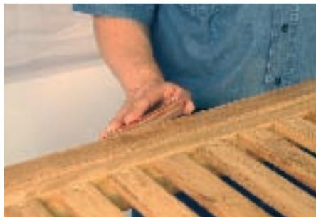
ein wasserfestes Öl für den Außenbereich (z.B. Clou Holzöl). Das Öl im ersten Schritt dünn mit einem Pinsel auftragen und über Nacht trocknen lassen. Die hochgestellten Fasern mit Schleifpapier (Körnung P 280) weg-schleifen (Zwischenschliff). In weiteren
