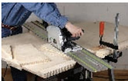
22. Zeichnen Sie sich die Schrägen genau auf die Trichterwände, legen Sie die Führungsschiene genau auf die Bleistiftlinie und spannen Sie sie mit den Spezialzwingen fest. Damit die nächste ...
