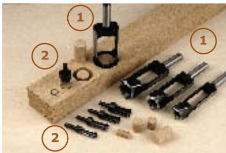
Querholzdübel sind ideal, um Astlöcher oder Schraubenköpfe abzudecken. Sie können mit einem Scheibenschneider (1) oder „Dübel-Cutter“ (2) leicht selbst hergestellt werden. Farbe und Maserung lassen sich so exakt auf das zu reparie-
