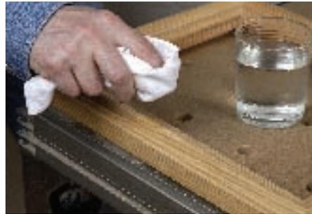
Wer kennt das nicht? Man ist fast fertig mit seinem Möbelstück und durch einen dummen Zufall schlägt die Kante des Rahmens gegen die Werkbank. Sind die Holzfasern dabei nicht gerissen, sondern nur zusammengequetscht lässt sich die Druckstelle leicht durch Wasserdampf wieder aufquellen. Dazu drücken Sie mit einem feuchten, sauberen Leinen- oder Baumwolltuch etwas Wasser in die Delle. Anschließend wird der feuchte Lappen
