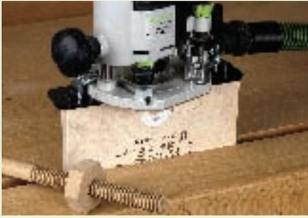
Mit dem - leider nur in den USA erhältlichen - Gewindeschneidapparat für die Oberfräse, können Gewindestäbe mit 1/2 (12,7 mm), 3/4 (19,05 mm) und 1 Zoll (25,4 mm) Durchmesser hergestellt werden. Die Einsatzmöglichkeiten reichen vom Nussknacker über Holzzwingen bis hin zur Herstellung von Holzspielzeug. In Hartholz sind die Ergebnisse sehr überzeugend und man kann das Gerät mit
