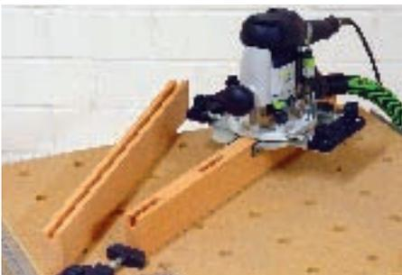
Die Führung des Parallelanschlags lässt sich wesentlich verbessern, wenn man die bestehenden Kunststoffbacken gegen durchgehende oder geteilte Holzleisten oder Brettchen aus Multiplex austauscht. Mit breiten Führungsflächen kann die Fräse sogar über schmale Holzanten geführt werden, ohne dass sie zur Seite kippt. Noch besser ist ein zweiter Parallelanschlag, der das Werkstück quasi "einklemmt". So ist weder ein Kippen der Fräse noch ein Verrutschen des Werkstücks möglich.
