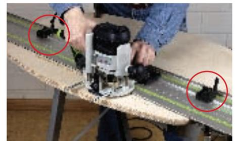
5. Der 51 cm lange Papierschlitz wird mit einem 8 mm Nutfräser und einer Führungsschiene eingefräst (max. 6 mm tief pro Fräsgang!). Zwei Anschläge sorgen dafür, dass man nicht zu weit fräst.
