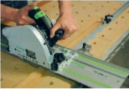
10. Die beiden Seitenleisten nach außen schieben und den Zwischenraum im Falz messen. Die Leisten für die Liegefläche auf das gemessene Maß abschneiden. An den Leisten alle Kanten mit der
