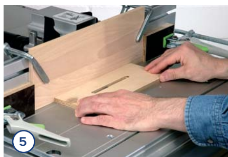
5. Dieses Brett spannen Sie anschließend an den Fräsanschlag und fräsen in die Zapfenschablone zunächst nur einen 10 mm Schlitz.
