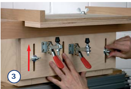
3. Legen Sie dann eines der Werkstücke auf den Anschlag und schieben Sie es bis knapp unter die Führungshölzer.
