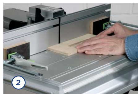
2. Fräsen Sie die Nut in vier Etappen heraus, bei der Sie zunächst die Schablone einfach um 180 Grad drehen (Rückschlagsicherungen ...
