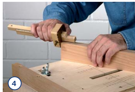
4. Als nächstes markieren Sie sich auf die Schmalseite des Werkstücks die halbe Holzbreite des Zapfenteils (in unserem Fall 60 : 2 = 30 mm)
