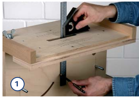
1. Zeichnen Sie sich zuerst eine präzise Mittellinie auf die Frontplatte.
