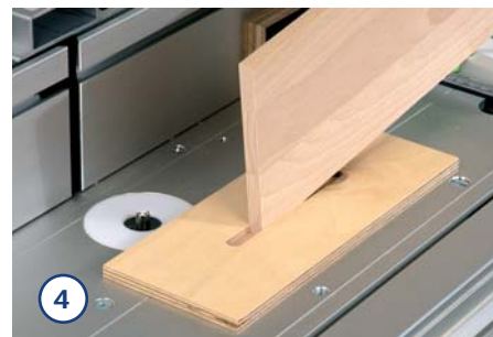
4. Für die Zapfenschablone fertigen Sie sich ein Massivholzbrett an, das genau in den 10 mm Schlitz ihres Nutfräasers passt.
