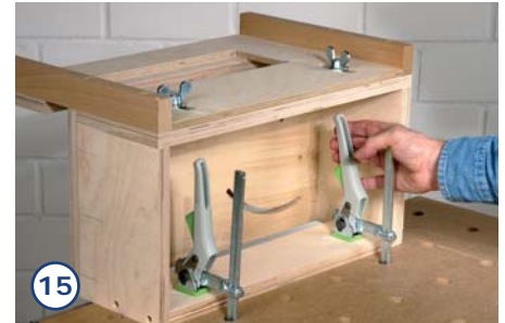
15. Auch die Querstrebe einfach mit Schrauben zwischen den Seitenwänden befestigen. So lässt sich die Vorrichtung später einfach auf einer Tischfläche mit Zwingen fixieren.
