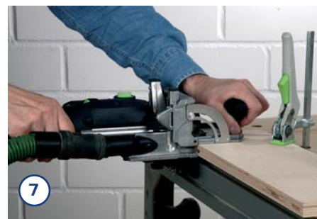
7. Danach fräsen Sie in die jeweiligen Stirnflächen die Dominos ein. Fixieren Sie dabei die Werkstücke unbedingt mit Zwingen.
