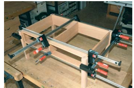
Die schwere Ausführung der Korpuszwinde ist erhältlich in Spannweiten von 300 bis 2.500 mm.
