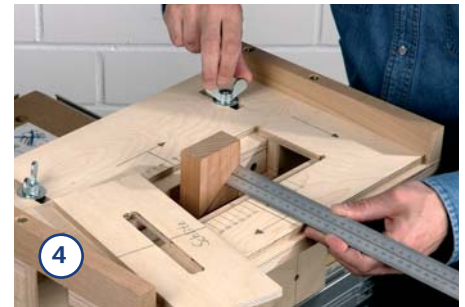
4. ... so aus, dass das Holz genau in der Mitte der Aussparung liegt.
