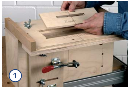
1. Legen Sie die Zapfenschablone für 10 mm dicke Zapfen in den Schablonenträger ein. Schieben Sie das Werkstück am Anschlag vorbei ...
