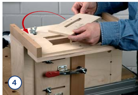
4. Drehen Sie anschließend die Schablone um 180 Grad, damit Sie auch die andere Seite des Zapfens fräsen können.
