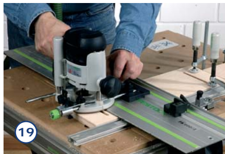
19. Die drei 100 mm langen und 8 mm breiten Schlitzte werden am besten mit der Oberfräse und einer Anschlag-schiene gefräst. Achten Sie unbedingt auf rechtwinklige und parallele Schlitzte. Zur Not ...
