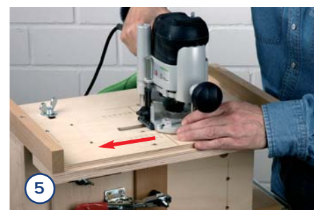
5. Gefräst wird immer mit der Laufrichtung des Fräasers, weil dadurch ein sehr sauberes Fräsbild, fast ohne jeglichen Spanausriss, entsteht.
