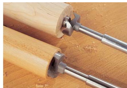
3. ...ins Bohrloch ein und bohrt so lange ein, bis die Schneiden des großen Bohrers greifen. Nun langsam und gleichmäßig weiterbohren. Ab und zu durch Herausziehen die Späne aus der Tiefe holen.
