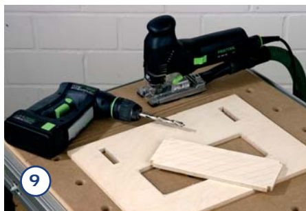
9. Sägen Sie mit der Stichsäge die Langlöcher für die Schlossschrauben genau aus, während Sie die Aussparung für die Schablone nur grob aussägen. Sägen Sie wieder ca. 3 mm bis an den Bleistiftfriss heran.
