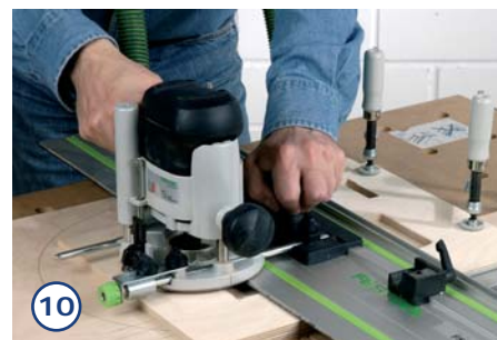
10. Den Rest fräsen Sie mit der Oberfräse und einem Nutfräser heraus. Führen Sie die Fräse auf einer Schiene und legen Sie eine dünne Platte unter den Schablonenträger, damit Sie nicht in den Tisch fräsen.
