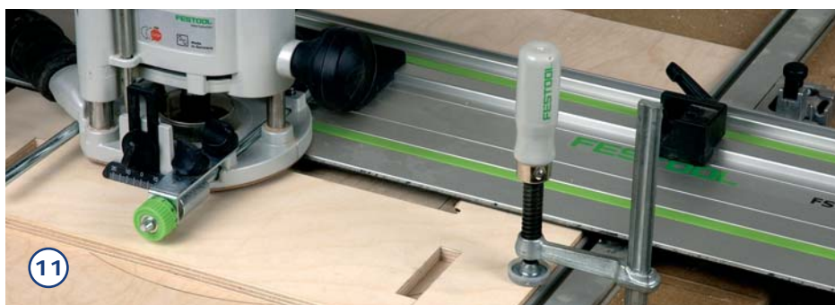
11. Wenn die beiden kurzen Ausschnittkanten sauber gefräst sind, drehen Sie die Platte um 90 Grad und fräsen auch die beiden Längskanten der Aussparung nach. Dabei ist es nicht so wichtig, dass sie genau das Maß im Bauplan einhalten, sondern achten Sie viel mehr auf Rechtwinkligkeit und Parallelität der Aussparung. Die Schablonen lassen sich später noch genau auf das Maß der Aussparung zuschneiden.
