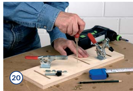
20. ... können Sie die Schlitzte auch auf 10 mm Breite vergrößern. Schrauben Sie eine Schnellklemme genau in der Mitte an (für die Schlitzte) und die andere im oberen Bereich (für die Werkstücke mit Zapfen).
