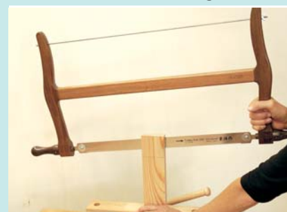
Links die breitere Schnittfuge der Gestellsäge, rechts die feine Schnittfuge der Dozuki
