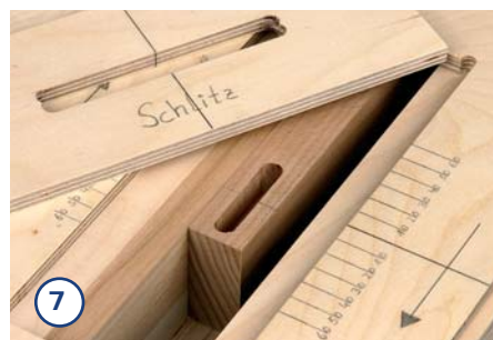
7. ... Platten können einfach lose gegen die Führungshölzer gelegt werden. Das garantiert immer perfekte, gleich lange Schlitzte.
