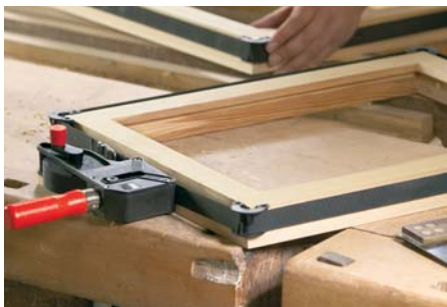
Rahmen auf Gehrung lassen sich mit dem Bandspanner perfekt spannen. Nimmt man die Spannecken ab, kann man auch runde Teile spannen. Standard-Zwingen würden hier abrutschen.
