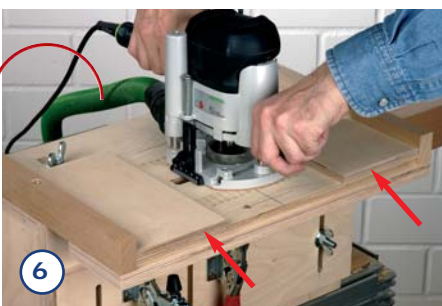
6. Damit der Schlitz immer die gleiche Länge hat, benutzen Sie einfach zwei dünne, passend abgesägte Holzplatten als Anschlag. Die ...
