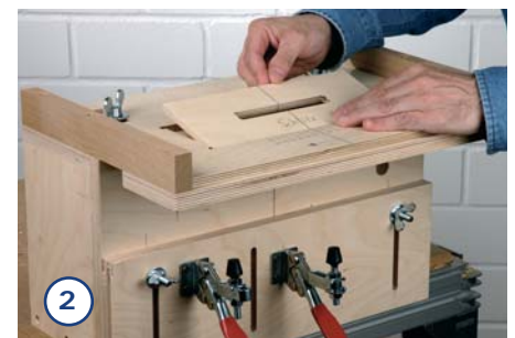
2. Danach wird die Schlitzschablone eingelegt und das Anschlagbrett von hochkant (für Zapfen) auf quer (für Schlitz) ummontiert.
