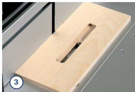
3. ... anbringen!) und danach auch von der Rückseite bearbeiten. Achten Sie darauf, gegen die Laufrichtung des Fräasers zu arbeiten.
