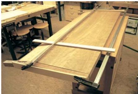
Für besonders lange Werkstücke wie die Kopfseite eines Bettes brauche ich extra lange Schraubzwingen (größere Exemplare heißen "Knechte"). Diese hier im Bild haben eine Länge von 2.500 mm.
