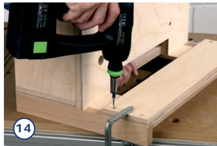
14. Kiste umdrehen und auch den vorderen Deckel mit je zwei Spaxschrauben befestigen. Alle Schrauben unbedingt vorbohren und versenken!
