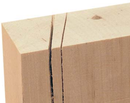
Links die breitere Schnittfuge der Gestellsäge, rechts die feine Schnittfuge der Dozuki
