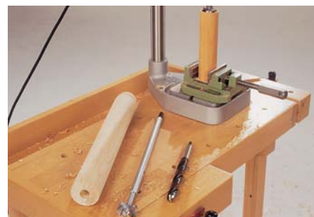
2. ...ausbohren (bis 400 mm tief): Zuerst wird mit dem 20er-Bohrer etwas vorgebohrt, dann der entsprechende Forstnerbohrer mit einem 20er-Führungszapfen bestückt. Den Zapfen setzt man ...
