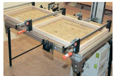
Im Rahmenbau ist die Korpuszwinde ein geniales Spannwerkzeug, einfach ansetzen und festspannen.
