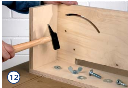
12. Schlagen Sie den Vierkantschaft der Schlossschraube von innen in die 10 mm Bohrungen der Deckelplatte ein. Anschließend legen Sie den Schablonenträger auf und richten ...
