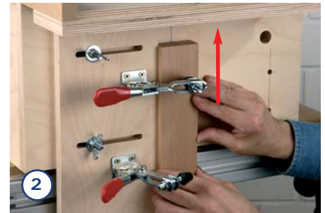
2. ... nach oben, bis es dicht an der Schablone anliegt und arretieren Sie es mit der oberen Schnellklemme.
