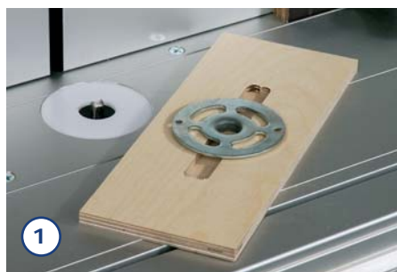
1. Fräsen Sie mit einem 10 mm Nutfräser genau mittig einen 130 mm langen Schlitz, in der die Kopierhülse spielfrei hin- und herläuft.
