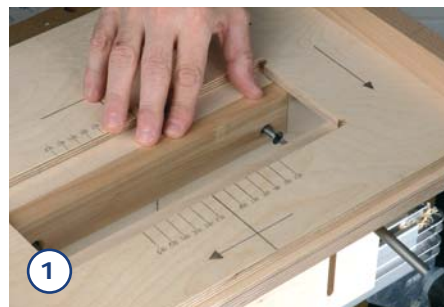
1. Der Zapfen wird ohne Ausreißholz gefräst. Beim Schlitzfräsen muss er aber unbedingt vorher angeschraubt werden.
