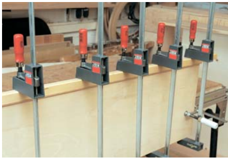
Schließlich kann die Einhandkantenzwinde durch eine weitere Standard-Zwinde ersetzt und für die nächste Platte verwendet werden.
