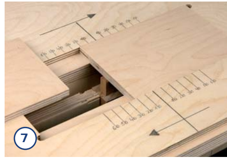
7. Dazu legt man einfach ein entsprechend gekürztes Schablonenbrettchen ein, an dem man wieder mit der Kopierhülse entlang fährt.
