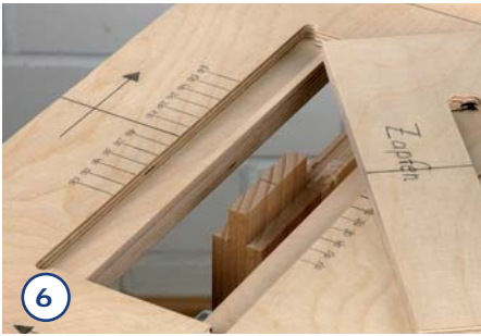
6. Am 10 mm dicken Zapfen soll links und rechts an den Schmalkanten noch ca. 5 mm weggefräst bzw. "abgesetzt" werden.
