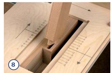
8. Zum Schluss wird der Zapfen an den Kanten mit einem Stechbeitel abgechrägt und in den Schlitz eingesteckt.
