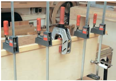
Anschließend werden Standard Zwingen (hier sind es Uniklamp) angesetzt.
