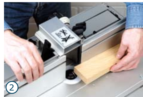
2 Mit einer Holzleiste kann man sehr gut die Position des Anschlags zum Fräserprofil vorjustieren. Das ersetzt aber nicht die nötige Probefräsung (Restholz)!
