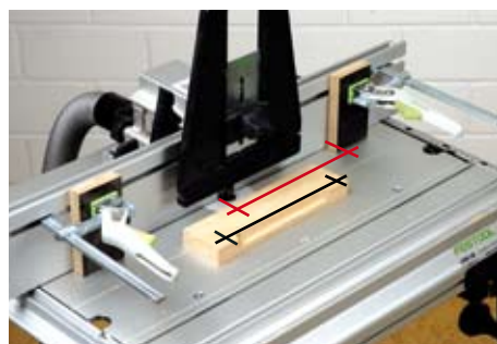
Um den Abstand der Brettchen zu ermitteln, müssen Sie den Fräser immer mit einbeziehen (rote Linie). Dieser Abstand entspricht dann der Werkstückaußenkante bis zum Anfang der Fräsung (schwarze Linie).
