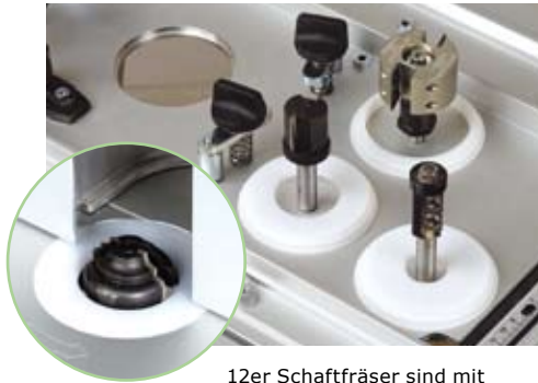
12er Schaftfräser sind mit längeren und größeren Schneiden erhältlich als 8er Schaftfräser. Je nach Fräserdurchmesser muss auch der passende Einlegering gewählt werden. Der Spalt zwischen Ring und Fräser sollte möglichst klein sein.
