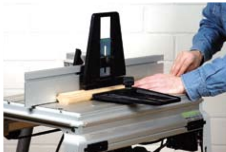
Schieben Sie die Holzleiste von rechts nach links am Fräser vorbei. Bei kleinen Leisten sollten Sie zum Schluss unbedingt einen Schiebestock benutzen.
