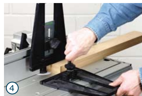
4 Zum Schluss stellen Sie die obere und seitliche Andruckeinrichtung auf die Holzstärke und -breite ein. Damit ist auch der Fräser weitestgehend verdeckt.
