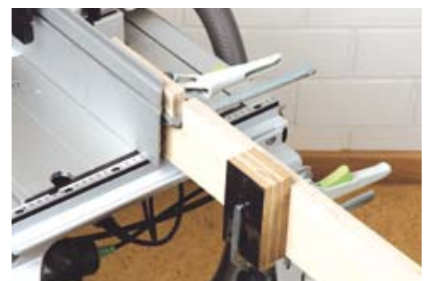
Bei längeren Werkstücken können die Brettchen nicht mehr am Anschlag befestigt werden. Hier hilft eine Verlängerung aus Multiplex, die man einfach hinter dem Anschlag befestigt. Daran lässt sich dann das Brettchen fixieren.
