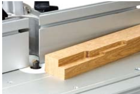
Fräsen Sie einen großen Falz immer in mehreren Arbeitsgängen heraus. Das schont nicht nur den Fräser, sondern verringert auch den Holzaustriss!
