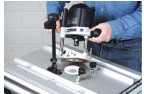
Legen Sie das Einsatzmodul mit der Oberseite auf den Tisch. Einlegering in die Öffnung legen und Fräse aufsetzen. Dadurch wird die Oberfräse gleichzeitig zentriert und muss nur noch mit den vier Befestigungsklammern gesichert werden.
