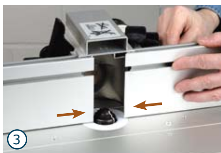
3 Die Anschlagsschienen (Anschlagbacken) werden anschließend so nah wie möglich an den Fräser herangeführt. Sie dürfen den Fräser aber nicht berühren!
