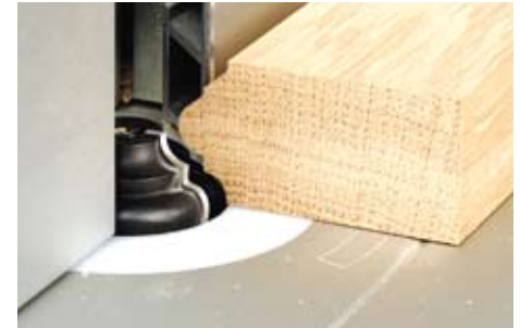
Sie können das Werkstück auch von beiden Seiten bearbeiten und erhalten dann weitere Profilvarianten, ohne eine neuen Fräser kaufen zu müssen.
