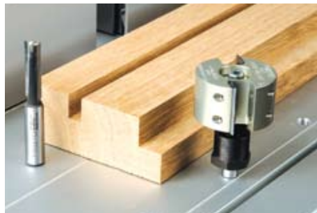
Mit einem Nutfräser (li.) können Sie natürlich auch falzen. Der größere Falzfräser (re.) fräst aber mit einer höheren Schnittgeschwindigkeit und durchtrennt die Fasern in einem flacheren Winkel.
