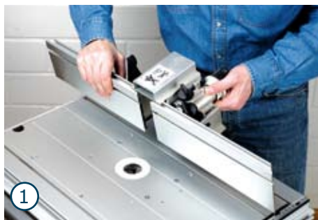
1 Je nach gewünschtem Abstand zum Fräser, kann der Fräsanschlag an zwei unterschiedlichen Positionen auf der Tischfläche befestigt werden.
