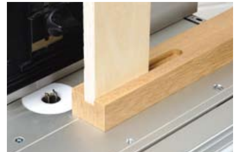
Selten passt der Nutfräser genau zur Brettdicke. Setzen Sie einen dünneren Fräser ein mit dem Sie in zwei Arbeitsgängen die Nutbreite herausfräsen.
