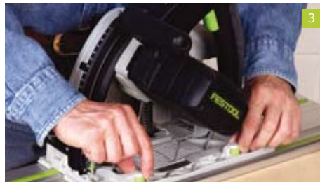
Für ein präzises Schnittergebnis muss die Tauchsäge spielfrei über die Führungsrippe gleiten. Mit den beiden Führungsbacken im Sägefleisch lässt sich das sehr genau nachjustieren.
