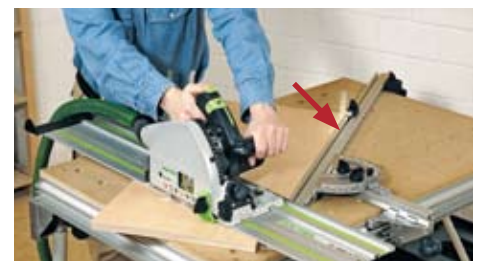
Schrägschnitte: Am Winkelanschlag kann jeder beliebige Winkel stufenlos eingestellt werden. Der klappbare Anschlagreiter (Pfeil) garantiert dabei immer gleich große Bauteile.
