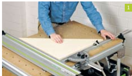
Mit einem genau rechtwinklig zugeschnittenen Brett mit den Maßen 60 x 60 cm, das einfach zwischen Anschlag und Schiene gelegt wird, können Sie beides im Handumdrehen genau im rechten Winkel zueinander einstellen.
