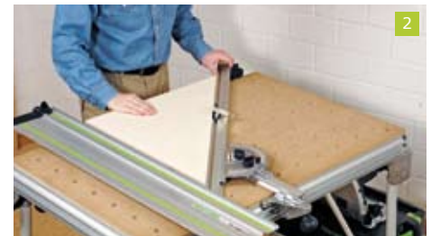
Wird das Brett dann noch diagonal genau auf 45° aufgeschnitten, kann es auch gleichzeitig zum Einstellen einer 45° Gehrung benutzt werden. Damit sind die wichtigsten Winkelgrade in wenigen Sekunden schnell und präzise eingestellt.
