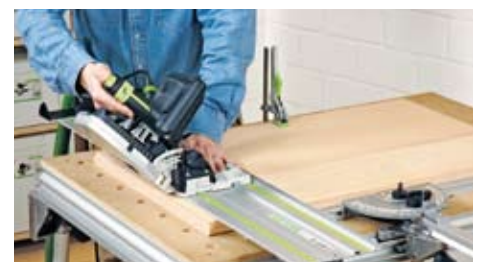
Wird die Säge genau 45 Grad zur Seite geschwenkt, lässt sich auch ein ganzer Korpus präzise auf Gehrung zuschneiden. Selbst Doppelgehrungen sind mit dem MFT problemlos möglich.
