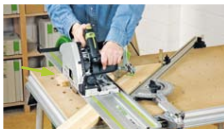
Gehrungsschnitte: Rahmen auf Gehrung zu sägen ist mit dem MFT kein Problem. Bei schmalen Rahmen wird einfach ein Reststück gleicher Stärke unter die Sägefschiene gelegt (Pfeil).
