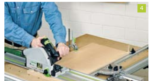
Schiene anheben, Werkstück gegen Winkelanschlag und Anschlagreiter platzieren und festspannen. Schnitttiefe einstellen und schon kann das Werkstück mit der Tauchsäge abgelängt werden.
