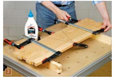
Wenn Sie eine Hobelmaschine ab ca. 300 mm Arbeitsbreite besitzen, können Sie zuerst nur die Kanten der Streifen „fügen“, um sie danach zu einer größeren Platte zu verleimen.
