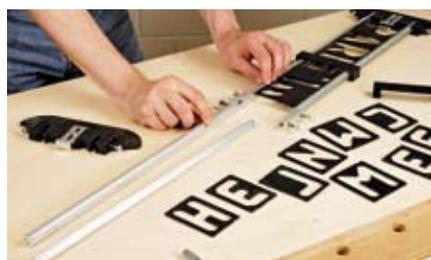
Bei besonders langen Wörtern können die beiden Aluschiene mit zwei weiteren Schienen über ein Adapterstück verlängert werden.
