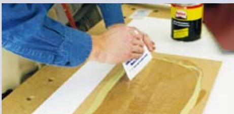
**1.** Geben Sie zunächst auf einer Seite der MDF-Platte und einem HPL mit einer feinen Zahnpachtel Pattex-Kraftkleber an. Lassen Sie das Lösemittel ca. 10 bis 15 Minuten entweichen, bis sich der Klebstoff-Film trocken und nicht mehr klebrig anfühlt.
