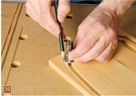
Mit einer 25 mm großen 8er Unterlegscheibe, die mithilfe des 8er Schafts eines Nutfräasers in der Rolladennut geführt wird, zeichnen Sie die obere Rundung der Seitenwände an.
