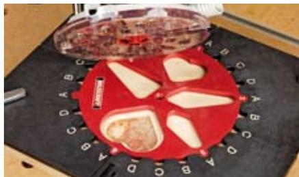
Mit der größeren 17er Hülse und dem speziellen Spiralnutfräser wird zuerst die Aussparung ins Holz gefräst.
