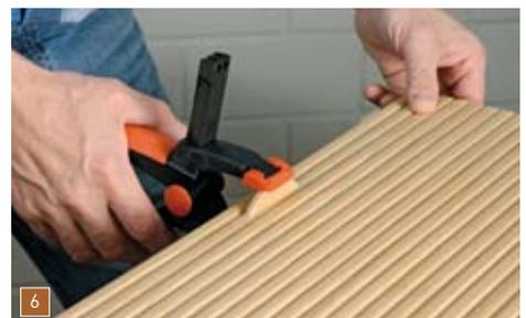
In der Mitte des zweiten Rollladenstabs leimen Sie den ellipsenförmigen Griff einfach stumpf auf. Besonders stabil ist er allerdings, wenn Sie ihn mit dem Stechbeitel etwas ins Holz einlassen.
