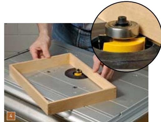
Ist der Leim getrocknet, fräsen Sie in die Seiten des Schubkastens mit einem Falzfräser mit Kugellager einen 5 mm hohen und ca. 4 - 5 mm tiefen Falz für den Sperrholzboden.
