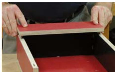
Wenn Sie zwei Leisten als Eingriff-Sicherung (Pos. 8) mit einbauen, müssen Sie beim Verleimen zunächst die obere Blende weglassen. Bei so vielen Ecken, die gleichzeitig verleimt werden, sollten Sie vorab schon Zwingen und Zulagen bereitlegen, um unnötige Hektik zu vermeiden. Kleben Sie zuerst die Verbindner in den Boden und in die Seiten ein.
