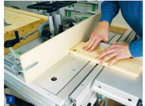
**3.** Mit Hilfe eines Falzkopfes oder Nutfräsers fräsen Sie passend zu den Nuten die Zapfen an die Kopfenden der Verbretterungen herzustellen, stellen Sie die Frästiefe so um, dass der Zapfen im Grund der Nut etwa 2mm Luft hat. Verwenden Sie bei dieser Fräsarbeit als Hilfsmittel ein so genanntes Vorsatzbrett, das Sie
