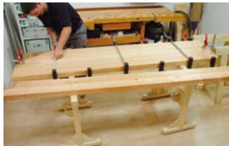
sie an beiden Enden mit einer senkrecht ange-setzten Zwinde gegen Verrutschen. Von innen nach außen werden die Zwingen angesetzt, immer im Wechsel von oben und von unten. Dadurch verhindert man das Verziehen des Brettes. Überschüssiger Leim wird nach dem Aushärten mit einem Leimkratzer oder einem Stemmeisen entfernt. Falls Sie keine breite
