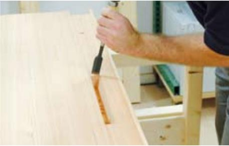
**7.** Schneiden Sie zunächst die Innen- und die Außenkante ein und arbeiten Sie dann in mehreren Schritten den Zwischenraum heraus. Abschließend werden bei beiden Arbeitsweisen die Ecken mit einem scharfen Stemmeisen heraus gestemmt. Legen Sie die Zwingen, die zum Verleimen von Sitzfläche und Beinen benötigt
