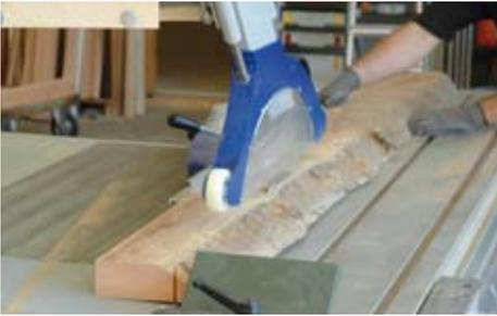
**1** Zunächst müssen die Massivholzbohlen besäumt und dann auf die passende Streifenbreite zugesägt werden. Durch die Anzahl der Streifen, aus denen die Sitzfläche besteht, wird das Erscheinungsbild maßgeblich beeinflusst. Mit wenigen Streifen erreichen Sie eine ruhigere natürliche Optik, mit mehreren wirkt es lebhafter.
