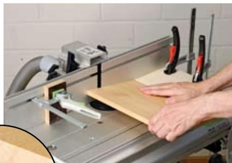
... werden am Anschlag Stopphölzer befestigt, wobei die hintere Platte gleichzeitig als Rückschlagsicherung dient.
