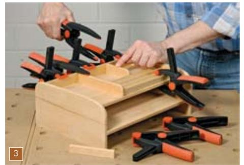
Dann werden nach und nach alle weiteren Teile - wie Stiftschale und Trennwände - einfach stumpf auf den oberen Boden geleimt und mit Federzwingen gehalten.
