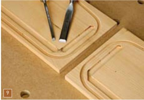
Hier sieht man das besagte „Spiegelbild“ der Seitenwände. Die Verbindung zwischen den beiden Nuten müssen Sie mit einem Stechbeitel von Hand herausarbeiten.
