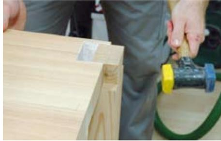
werden, bereit. Falls Sie die Zwingen nicht in ausreichender Länge besitzen, können Sie auch zwei Zwingen zusammensetzen. Auf den Flanken der Verbindung wird mit einem Pinsel gleichmäßig Leim aufgetragen. Schlagen Sie dann mit einem Gummihammer die Beine ein und setzen Sie die Zwingen an. Um die Verbindungen
