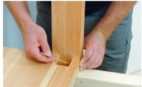
die Schablone wieder an dieser Linie an. Legen Sie die Beine (Pos. 3) an den Ausfräsungen an und übertragen Sie die Konturen. Im besten Fall sind alle Konturen genau gleich und Sie können alle Schwalben mit der gleichen Einstellung auf der Tischkreissäge schneiden.
