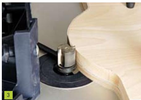
Während das am Fräseschaft liegende Kugellager an der Schablonenkante vorbei geführt wird, fräst der Bündigfräser den Überstand der Füllung genau passend 1:1 zur Schablonenkontur.
