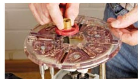
Je nach Schriftgröße wird die passende Kopierhülse zum Abfahren der Schablone in die TurnLock Grundplatte eingesetzt.
