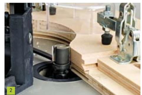
... beiden Schnellspannern. Dann fräsen Sie mit dem Bündigfräser den Restüberstand weg. Dabei tastet das gummierte schwarze Kugellager unter dem Fräser genau die Kontur der Schablone ab.
