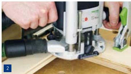
**2.** Die Nutfräsung zur Aufnahme der Füllung können Sie in zusammengestecktem Zustand ausführen. Hierzu eignet sich wieder der Scheibennutfräser, den Sie wie bei der Landhaustür in der Höhe so einstellen, dass Sie durch einmaliges Wenden des Werkstücks die passende Nutbreite erhalten.
