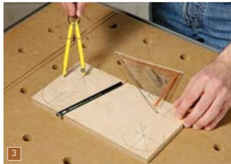
Bis der Leim abgetrocknet hat, können Sie die Zeit nutzen, um aus einer 9 - 12 mm dicken Multiplexplatte eine Schablone für die Rollladennut herzustellen (s. Zeichnung S.34).
