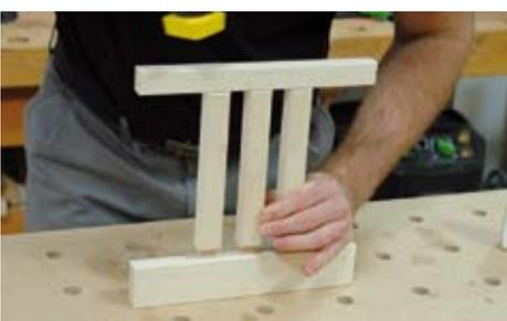
**3** Geben Sie Leim in den Dominolöchern der Sprossen an und schlagen Sie die Dominodübel ein. Dann auch in den Gegenlöchern Leim angeben und die Teile zusammenstecken. Setzen Sie an den beiden Sprossenfeldern Zwingen an und lassen Sie den Leim trocknen. Kleben Sie nach dem Trocknen Dominodübel in die Querstücke ein und verleimen Sie diese mit den
