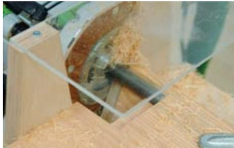
Gesamttiefe ein. Die beiden längeren Schrauben werden für die beiden anderen Fräsgänge benutzt. Um Ausrisse auf der Oberseite zu vermeiden, wird beim letzten Fräsgang zunächst auf der Oberseite einmal komplett quer zur Faser das Holz abgefräst. Markieren Sie nach dem Fräsen jeweils die Außenkante der Sitzfläche auf der Schablone und legen Sie auf der Gegenseite
