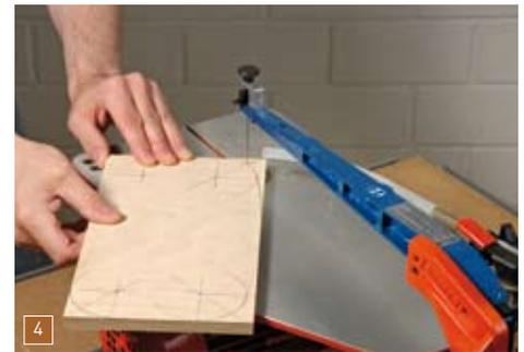
Sägen Sie die drei Kanten möglichst präzise aus. Feilen und schleifen Sie Unebenheiten sehr sorgfältig heraus, damit der Rollladen später eine perfekte und gleichmäßige Führung hat.
