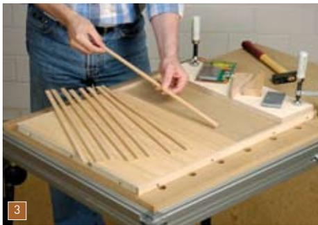
Stellen Sie sich aus einer ca. 12 - 16 mm dicken Spanplatte (440 x 600 mm) eine Schablone her, in die die Stäbe genau in der Länge reinpassen. An den Kanten überstehende Leisten anschrauben.
