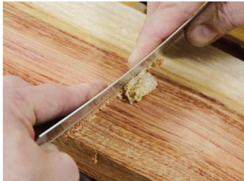
Kleine Ausrisse und alte Lackschichten werden mit der Ziehklinge besonders fein abgezogen.
