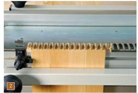
... in die Vorrichtung gespannt werden. Deswegen wurde die Schubkastenhöhe auch auf 42 mm festgelegt (7 x 6 mm). Wenn ihr Gerät nur 10 mm Zinken zulässt, dann sollte die Höhe 50 mm sein.
