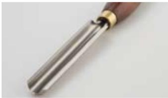
Die Schruppröhre. Sie ist das Werkzeug fürs ‚Grobe‘. Sie wird in erster Linie eingesetzt, um Rohlinge (Kanteln, Stamm- oder Astabschnitte) rund zu dreheln oder für große Profile. Setzen Sie sie nur im Langholz ein. Im Querholz sind die exponierten Ecken hinderlich. Die 19 mm Schruppröhre hat die optimale Größe für kleine und große Dimensionen.
