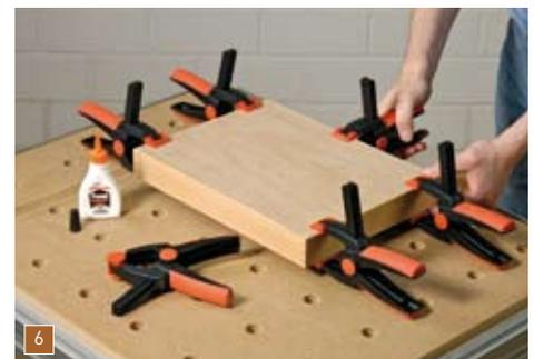
Mit ein paar einfachen Federzwingen fixieren Sie den Boden im Falz, bis der Leim abgebunden hat. Der Pressdruck der Federzwingen reicht für diese Aufgabe völlig aus!
