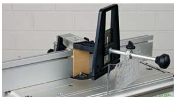
Einen Anschlag lösen und das Brett von oben einschieben, danach den Anschlag ans Brett schieben und festziehen. Auch die Andruckvorrichtung kann problemlos weiter benutzt werden.
