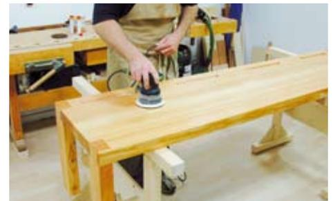
Schleifen Sie jetzt abschließend alle Flächen mit Körnung P180. Die erste Ölschicht können Sie mit Schleifvlief Körnung A280 einschleifen. Dadurch entfällt der Zwischenschleif, Sie müssen aber den Schleifstaub danach umgehend mit einem Lappen von der Fläche entfernen. Nach ca. einer Stunde mit einem Lappen die zweite Ölschicht dünn auftragen.
