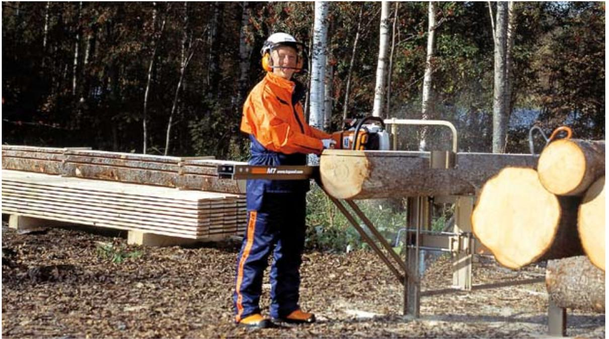
Beim Arbeiten mit der Kettensäge muss immer eine passende Schutzausrüstung getragen werden
