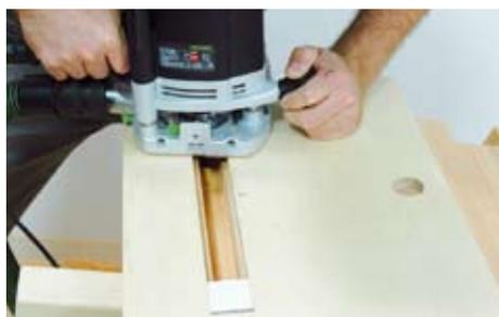
begrenzt werden. Dadurch können Sie die Schablone für verschiedene Lehnenbreiten verwenden. Unter den Schlitz wird ein um 12 Grad angeschrägtes Brett festgeschraubt, das auf beiden Seiten über die Sperrholzplatte übersteht, um diese auf der Sitzfläche festspannen zu können. Unten an die Sperrholzplatte kommt ein Anschlag, an die die Schablone genau an der
