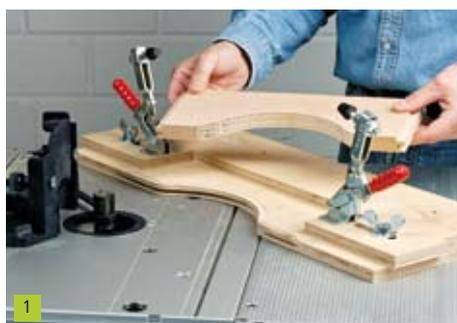
Stellen sie die beiden verschiebbaren Anschläge auf die Rahmenlänge ein, legen Sie das grob mit der Stichsäge ausgeschnittene Rahmenquerstück in die Schablone und fixieren Sie es mit den ...
