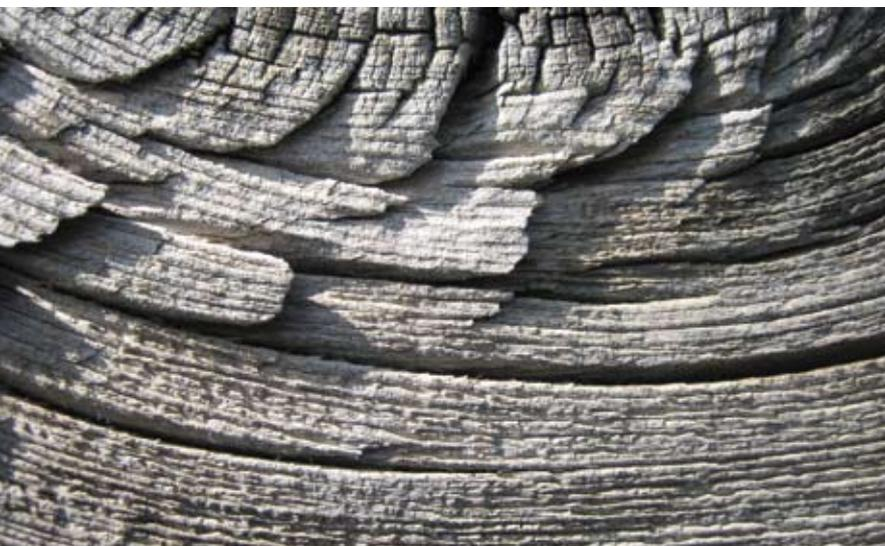
Detailaufnahme in den Alpen: Die UV-Strahlung hat die oberen Zellschichten zerstört und es ist zu einer Vergrauung gekommen. Das Holz ist aufgerissen.
