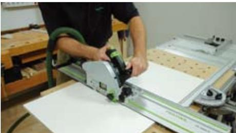
**1.** Auf einer Tischkreissäge oder dem Multifunktionsstisch können die langen Plattenstreifen auf die fertige Länge gesägt werden. Der MFT eignet sich besonders gut, da die großen Werkstücke plan auf dem Tisch aufliegen und bequem mit der Tauchsäge abgelängt werden können.
