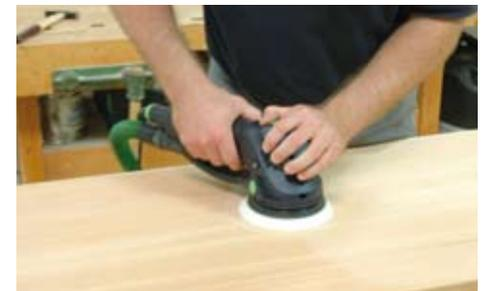
Hobelmaschine besitzen, wird die Fläche jetzt mit einem Exzentrerschleifer plan geschliffen, Körnung P80. Wenn die Platte auf die endgültige Dicke gehobelt oder geschliffen ist, wird die Sitzfläche (Pos. 1) auf die gewünschte Länge zugesägt. Auch die Rückenlehnen (Pos. 2) werden auf die gleiche Art und Weise aus einzelnen Streifen miteinander verleimt.
