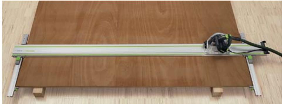
„Vorportionierung“ in handlichere Formate. Sie können dazu beispielsweise den neuen Parallelanschlag für die Festool-Führungsschiene benutzen. Legen Sie die Platte einfach auf Kantenhölzern auf den Boden und „besäumen“
