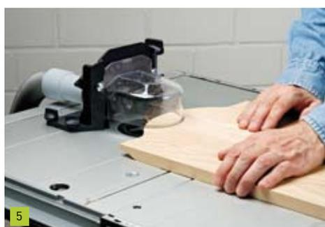
... darauf, dass Sie die Füllung immer schön nach vorne schieben und keinesfalls zurück ziehen. Fräsen Sie zügig, aber nicht zu schnell und vermeiden Sie jegliches Stocken, denn an diesen ...
