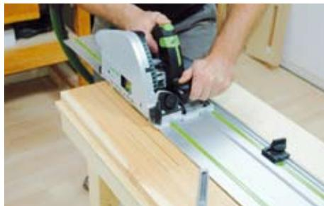
mit der Tauchsäge mittig auf der Linie schneiden. Als Endanschlag können Sie einen Rückschlagstopp verwenden. Schleifen Sie alle Kanten und Flächen mit einem Exzenterschleifer mit Körnung P120. An Stellen, an denen mehr Material abgetragen werden muss, zunächst mit Körnung P80 vorschleifen. Fasen Sie dann alle Kanten mit einer Oberfräse und schleifen Sie die Fasen mit einem Handschleifklotz.
