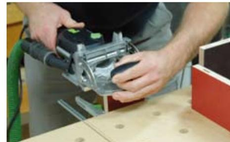
Einzelteile des Briefkastens. Bei der Verwendung von Runddübeln werden zunächst die Löcher in die Seiten (Pos. 2) und in den Boden (Pos. 3) gefräst. Die Position der Löcher wird dann am einfachsten mit Dübelspitzen auf die anderen Teile übertragen.
