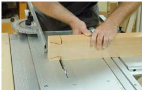
Wenn alle vier Beine geschnitten sind, wird die so genannte Brüstung des Schwalbenschwanzes geschnitten. Dafür werden die Beine am zurückgezogenen Parallelanschlag entlang geschoben, so dass das abfallende Reststück sich nicht zwischen Anschlag und Sägeblatt verklemmen kann. Die Feinarbeiten am Schwalbenschwanz werden mit einer Handsäge oder einem scharfen
