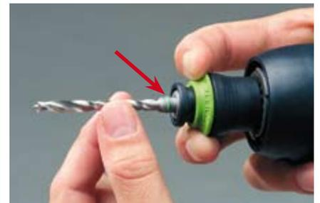
Anschließend den grünen Ring nach hinten schieben und den Bohrer oder Bithalter bis zur grünen Markierung (Pfeil) einstecken.
