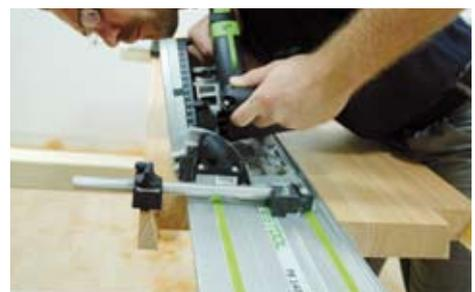
Kante angelegt werden kann. Fräsen Sie auch hier wieder die Tiefe in drei Schritten heraus. Alternativ können die Schlitz auch mit der Tauchsäge mit Führungsschiene gesägt werden. Zeichnen Sie dazu die Schlitz an, richten Sie die Schiene passend aus und spannen Sie sie auf der Sitzfläche fest. Die Tauchsäge wird um 12 Grad geneigt.
