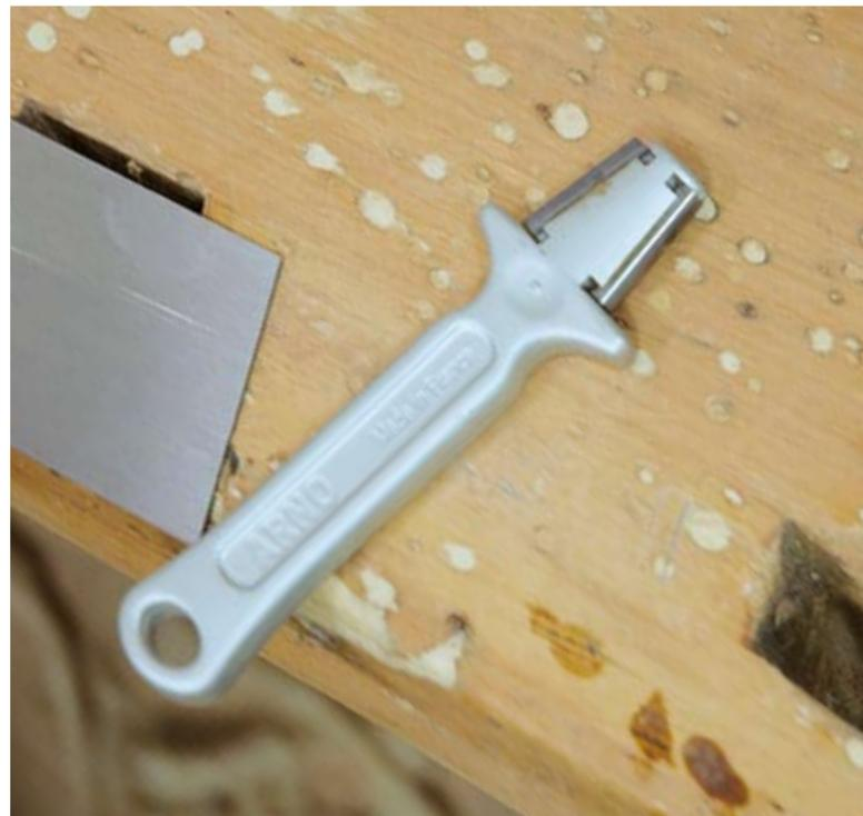
Ziehklingenstahl zum Verdichten und Abziehen mit rundem und dreieckigem Stahl in einem Werkzeug vereint.
