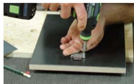
Bohren Sie das Loch für das Schloss mit einem Forstnerbohrer. Schneiden Sie die passende Länge vom Stangenscharnier ab und entgraten Sie auch hier die Enden mit einer Feile. Schloss und Scharnier werden dann von innen an die Tür geschraubt.
