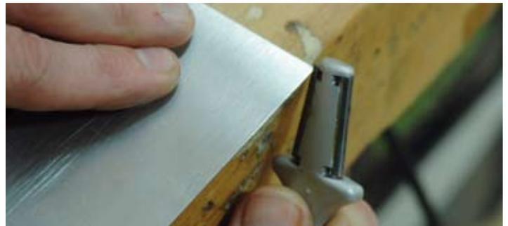
in der passenden Schräge entlang gezogen. Beim „Carbur 2“ sind Rundstahl und dreieckiger Stahl an einem Griff. Beide sind schon in der passenden Schräge am Griff montiert, so kann das Werkzeug an der Ziehklinge entlang gezogen werden, wobei es beim Verdichten horizontal, und beim Herstellen des Grates vertikal gehalten werden muss.
