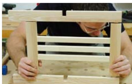
Beinen. Achten Sie darauf, dass die beiden Rahmen auch nach dem Ansetzen der Zwingen noch rechtwinklig sind. Leimreste werden nach dem Trocknen mit einem scharfen Stemmeisen entfernt. Schleifen Sie die beiden Rahmen an den Kanten mit einem Schleifklotz und auf den Flächen mit einem Exzentschleifer.
