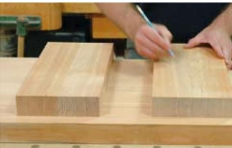
**2** Vor dem Verleimen werden die Streifen zusammenggelegt und die schönste Optik ausgewählt. Kennzeichnen Sie sich die Positionen mit einem Schreinerdreieck. Legen Sie vor dem Verleimen eine ausreichende Zwingenanzahl bereit. Auf den Schmalflächen wird mit einem Pinsel gleichmäßig Leim aufgetragen. Legen Sie dann die Einzelteile zusammen und sichern Sie
