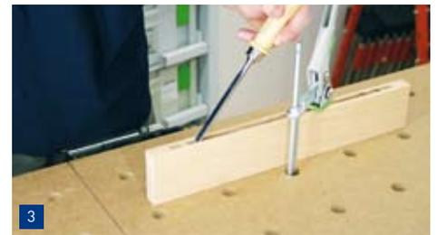
**3.** Die Maße der Füllung ergeben sich aus den Dimensionen des zuvor eingesetzten Scheibennutfräasers. Dieser ist mit einem Anlaufring ausgestattet, so dass sich die Nuttiefe zu 12 mm ergibt. Die Ecken der Füllung müssen vor dem Einsetzen also abgerundet werden, bzw. bei Verwendung von Gläsern als Füllung muss entsprechend die Ecke im Rahmen von Hand nachgearbeitet werden.
