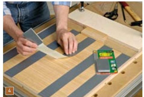
Arretieren Sie die Stäbe mit zwei Keilen und kleben Sie mindestens fünf Lagen (besser komplett bekleben) des hochfesten Gewebeklebebands auf die Rückseite der Rollladenstäbe.
