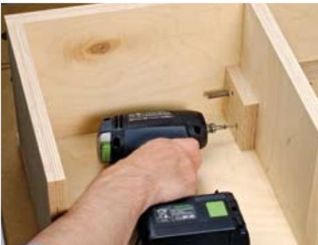
Der T12+3 ist gerade mal 16 cm lang, wenn der Bit direkt in die vordere Aufnahme gesteckt wird. Ideal, wenn es mal ganz eng wird.
