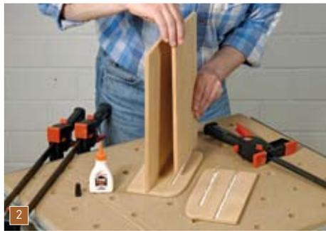
Zuerst werden die Seiten auf dem Frästisch für die beiden Böden genutet. Danach werden sie mit Leim eingesteckt und das Ganze mit Zwingen fixiert, bis der Leim abgebunden hat.
