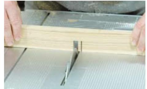
nun auf den zweiten Schnitt so einstellen, dass die Füße stramm zusammengehen. Schneiden Sie das Holz zwischen den beiden Schnitten heraus und kontrollieren Sie dann, ob sich der Fuß auf die anderen aufstecken lässt. Falls die Verbindung zu fest sitzt, den Anschlagreiter nachstellen und den Schnitt korrigieren.
