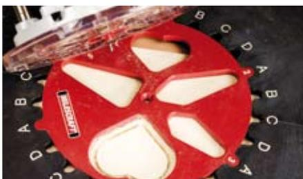
Danach wird die kleinere 11,1 mm Hülse eingesetzt und aus einem dünnen Sperrholz das Einlegestück heraus gefräst.
