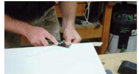
**3.** Arbeiten Sie die Überstände der Schmelzkleberkanten am besten mit einem scharfen Stecheisen bei. Verwenden Sie dazu nach Möglichkeit ein sehr breites Stecheisen (26 mm und breiter) oder Hobeisen, damit Sie es flach über die Platte schieben können und eine große Auflagefläche haben.
