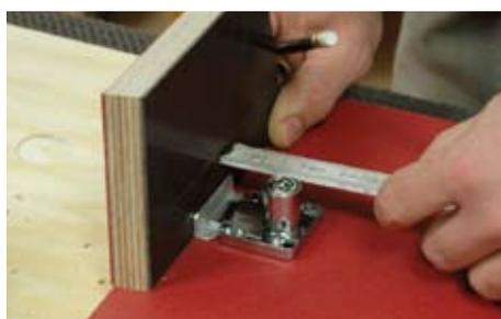
Außenkante können Sie dadurch ermitteln, dass Sie ein Reststück außen bündig auf die Tür stellen und das Schloss dagegen schieben. Die einfachste Variante zum Schließen ist ein Winkel, der von innen an die Seite geschraubt wird. Die Ecken des Winkels werden großzügig mit einer Feile gerundet, um Verletzungen auszuschließen.
