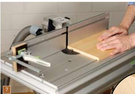
Die Nuten für den Boden und das Rückteil werden mit einem 14 mm Nutfräser auf dem Frästisch hergestellt. Damit Sie nicht zu weit fräsen ...
