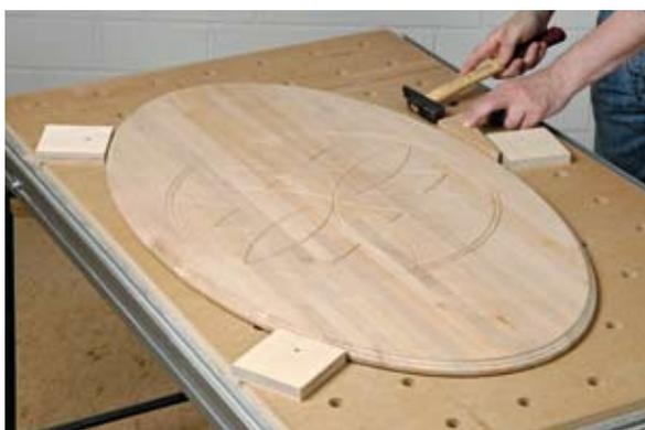
Stecken Sie die Quadrate mit den Rundstäben in die Löcher des MFT. Mit einem Keil, den Sie zwischen eines der Quadrate und der Holz kante einstecken, wird das Werkstück fixiert.
