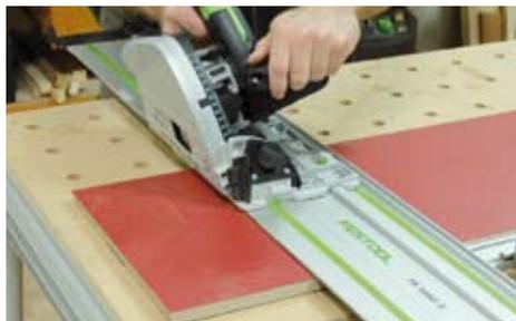
**1** Sägen Sie zunächst die einzelnen Platten auf die in der Materialliste angegebenen Maße ab. Die Rückwand (Pos. 1), der Deckel (Pos. 7) und die obere Blende (Pos. 6) werden schräg abgesägt. Dazu wird die Säge auf 15 Grad geneigt. Die beiden Seiten (Pos. 2) werden am schräg gestellten Anschlag mit geradem Schnitt
