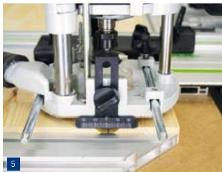
sogar wieder ein Stück Richtung Werkstückmitte zurück, um keine Verletzung der ersten Fräsung zu riskieren. Fixieren Sie die Führungsbegrenzer und nutzen Sie mit gleicher Frästiefe wie zuvor.
