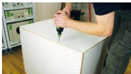
**5.** Eine Rückennut brauchen Sie bei dieser Bauweise auch nicht vorzusehen, da gerade im Küchenbau die Korpusse durch Verblendungen aus hochwertigeren Materialien, passend zur Front verkleidet sind. Sie können daher den Rücken im Nachhinein von hinten ebenfalls stumpf auf den Korpus aufschrauben.
