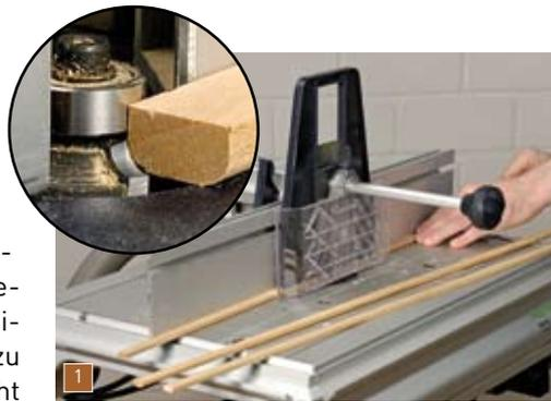
Die Rollladenstäbe werden mit einem 3 mm Abrundfräser an zwei Kanten auf dem Frästisch gerundet. Bei dem geringen Querschnitt der dünnen Leisten nur mit Andruckvorrichtung fräsen!
