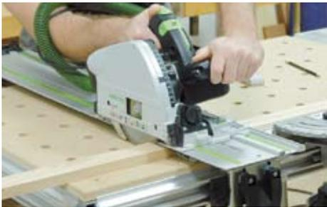
**1** Sägen Sie die zuvor gehobelten Leisten auf die angegebene Länge ab. Die Positionen der Einzelteile in den Baugruppen werden mit einem Schreinerdreieck und Nummern gekennzeichnet. Die genaue Position der Steckverbindung wird nicht mit einem Meterstab ausgemessen, sondern durch Zusammenlegen einer kurzen
