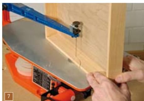
Passend zum ellipsenförmigen Griff am Rollladen, erhält auch der Schubkasten im vorderen Bereich ein entsprechend geformtes Griffloch.
