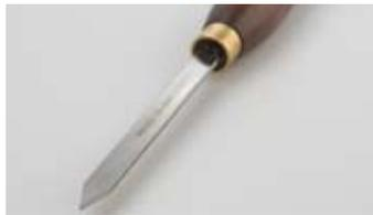
Der Abstechstahl (Abstecher), 3 mm. Er wird zum Andrehen von Zapfen und Platten verwendet. Mit ihm kann auch Raum für nachfolgende Profilierungen geschaffen werden und mit ihm werden Teile vom restlichen Holz abgetrennt. Der Abstecher hinterlässt eine schlechte Oberfläche, daher ist das Nacharbeiten mit einem schneidenden Werkzeug unerlässlich, wenn die Oberfläche später sichtbar bleiben soll.
