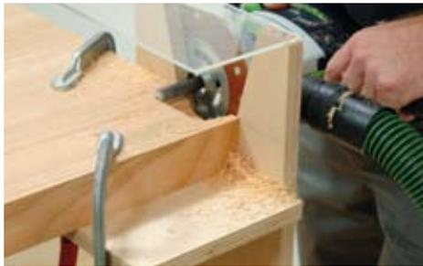
**4** Zeichnen Sie die Position der Schablone an den vier Ecken an und spannen Sie sie fest. Zum Fräsen wird ein 16 mm Fräser mit einer Nutzlänge von 60 mm und einer Gesamtlänge von 100 mm benutzt (Festool Best. Nr. 491091). Das Loch für den Schwalbenschwanz wird in drei Schritten ausgefräst. Stellen Sie zunächst an der unteren Schraube der Tiefeneinstellung die
