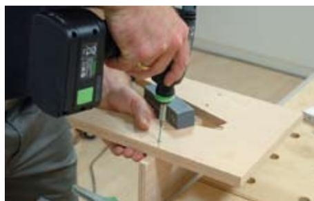
wird dann auf jeder Seite mit der Tischkreissäge ausgesägt. Das zweite Brett wird im rechten Winkel am ersten festgeschraubt. Mit ihm kann die Schablone später am Werkstück befestigt werden und gleichzeitig dient es noch als Splitterschutz. Beim Arbeiten mit der Kopierhülse reduziert sich die Breite der Fräsung im Vergleich zum Ausschnitt in der Schablone um
