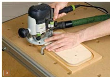
Befestigen Sie die Schablone genau mittig mit zwei Schrauben auf den Seitenteilen und fahren Sie die Kontur gegen den Uhrzeigersinn mit einer 17er Kopierhülse und einem 8 mm Nutfräser ab.
