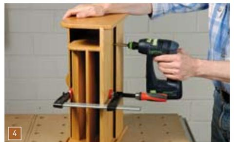
Legen Sie zum Schluss die Innenbox ein und sichern Sie das Ganze vom Boden aus einfach mit zwei Schrauben. Aber vorbohren und senken nicht vergessen.
