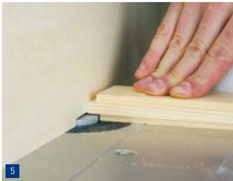
**5.** Wenn Sie wie in unserem Beispiel auf der Vorderseite eine Schattenfuge zwischen den einzelnen Riegeln erhalten möchten, so führen Sie die Arbeitsgänge aus Schritt 3 und 4 zunächst nur auf der Rückseite der Riegel durch. Für die Vorderseite stellen Sie im Anschluss eine größere Frästiefe ein.
