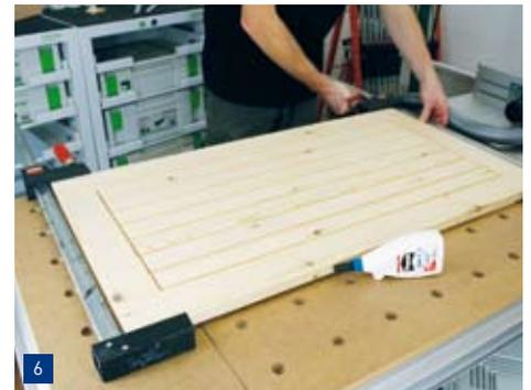
**6.** Alle Kanten werden jetzt gefast oder mit einer leichten Hohlkehle versehen. Da an manchen Werkstücken Zapfen bzw. Federn angefräst wurden, muss der Fräser mehrfach eingestellt werden. Nach Schleifarbeiten und entsprechender Oberflächengestaltung kann die Front verleimt werden. Verleimen Sie nur die Nutzapfenverbindung, die Verbretterung wird lediglich ineinander gesteckt, damit sie ggfs. noch arbeiten kann.
