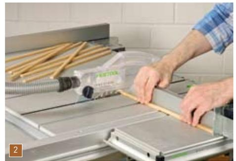
Danach sägen Sie die Stäbe ca. 11 mm länger auf 440 mm zu. Dann können Sie später noch den gesamten Rollladen genau auf Breite zuschneiden.
