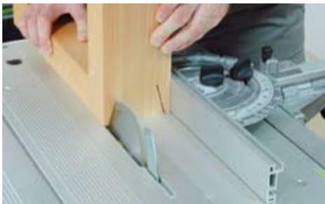
**5** Stellen Sie die passende Schräge und die Höhe an der Tischkreissäge ein. Sie sollten auf jeden Fall an einem Reststück einen Probeschwalbenschwanz sägen und die Einstellung des Parallelanschlages so lange korrigieren, bis die Verbindung genau passt. Beim Schneiden wird das Werkstück mit einem Nachschiebehölz am Anschlag entlang geschoben.
