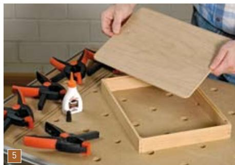
Runden Sie die Ecken des Bodens passend zu den Falzecken ab. Geben Sie anschließend etwas Leim in den Falz und legen Sie den Sperrholzboden ein.
