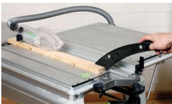
Der konventionelle Schiebestock hält das Werkstück nur im hinteren Bereich auf dem Säge Tisch, vorne muss die Spannhilfe dafür sorgen, dass das Werkstück nicht abhebt.
