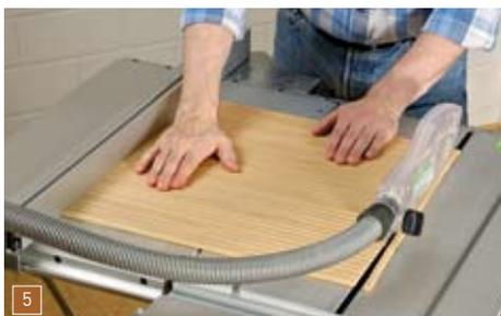
Die Rollladenbreite sollte max. 1,5 mm geringer sein als die Länge von Boden und Rückteil. So können Sie sicher sein, dass der Rollladen weder zu stramm noch zu locker sitzt.
