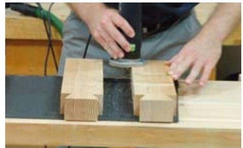
Stemmeisen durchgeführt. Vor dem Verleimen die Innenkanten der Beine abrunden und alle Innenflächen schleifen. Im Bereich der Verbindungen wird wenig geschliffen, sonst kann es passieren, dass der Schwalbenschwanz zu locker sitzt.
