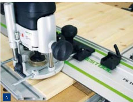
**4.** Die Fräsungen quer zur Faserrichtung des Holzes müssen natürlich begrenzt werden, damit das Profil nicht über die bereits gefrästen Nuten hinausgeht. Dazu nutzen Sie die Führungsbegrenzer an der Führungsschiene des MFT's.
