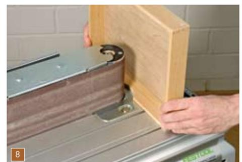
Zum Schluss wird die Rundung noch gründlich geschliffen und alle Kanten des Schubkastens mit dem Schleifklotz gebrochen.
