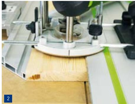
**3.a/b** Stellen Sie die Frästiefe ein, so dass der Radius des Fräasers genau in die Platte übergeht und fräsen Sie zunächst nur die beiden „Nuten“ in Längsrichtung des Holzes. Diese müssen nicht begrenzt werden.
