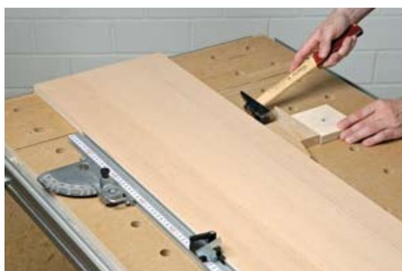
Passt der Lochabstand des MFT und der Quadrate einmal nicht zur Werkstückgröße, können Sie durch zwei entgegengesetzt eingeschlagene Keile den Druckabstand einfach ausgleichen.
