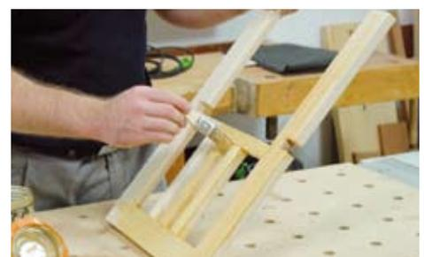
Die Flächen werden mit einem Pinsel geölt. Nach der Einwirkzeit wird überschüssiges Öl mit einem Lappen von der Fläche abgenommen. Nachdem das Öl getrocknet ist, mit einem Schleifvlies oder feinem Schleifpapier die Flächen zwischenschleifen und mit einem Lappen ein zweites Mal dünn Öl auftragen.
