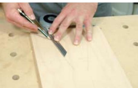
**3** Die Schwalbenschwanzverbindung kann entweder traditionell von Hand oder mit der Oberfräse und einer passenden Schablone hergestellt werden. Zum Bau dieser Schablone benötigen Sie zwei 18 mm dicke Furniersperrholzplatten. Auf der ersten Platte wird mit einem Winkelmesser oder Geodreieck die passende Schräge (15 Grad) angezeichnet. Diese Schräge
