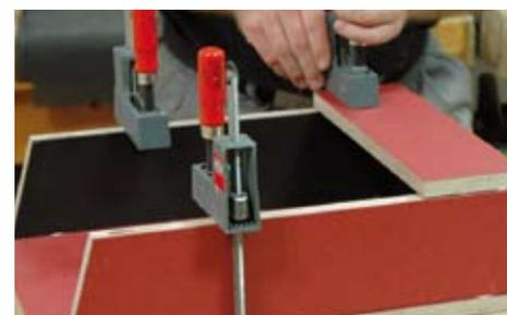
Geben Sie dann in den Gegenlöchern Leim an und stecken Sie alles zusammen. Verspannen Sie den Kasten mit ausreichend Zwingen. Überschüssiger Leim wird nach dem Aushärten mit einem scharfen Stemmeisen entfernt.
