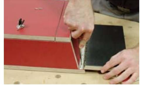
**4.** Um ein unberechtigtes Eingreifen in den Briefkasten zu verhindern, wird oben von beiden Seiten eine Leiste (Pos. 8) im Kasten angeschraubt. Diese Leisten sind oben abge- schrägt, um das Einwerfen der Post zu erleich- tern. Schrauben Sie die Leisten mit jeweils zwei Schrauben fest. Um die Tür beim Festschrauben besser positionieren zu können, sollten Sie die
