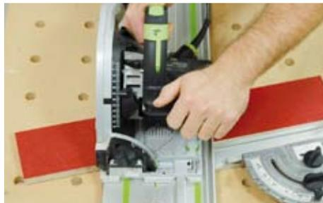
abgeschnitten. Die Verbindungen zwischen den Platten werden mit Domino- oder Runddübeln ausgeführt. Es ist wichtig, dass die Verbindner nicht aus Buche, sondern aus einem für den Außenbereich geeigneten Holz sind. Zeichnen Sie die Positionen der einzelnen Verbindner an und fräsen Sie die entsprechenden Löcher in die
