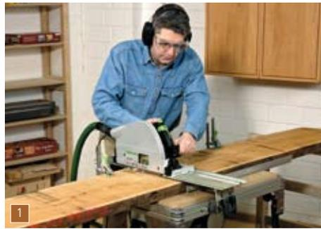
Zuerst werden die 52er Kirschbaumbohlen mit der Handkreissäge abgelängt (mit mindestens 50 mm Maßzugabe), anschließend besäumt und in 19 mm dicke Streifen gesägt.
