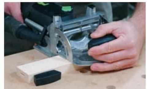
Sie sollten beim Fräsen immer darauf achten, dass ein Anschlag vorhanden ist, an den das Werkstück gedrückt wird. Das spart Kraft und macht das Arbeiten mit der Dominofräse noch einfacher. Runden oder fassen Sie mit einer Kantenfräse alle sichtbaren Kanten.
