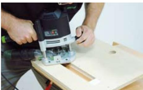
**6** Wenn Sie die Schlitz für die Rückenlehnen in die Platte fräsen möchten, müssen Sie sich eine weitere Schablone bauen. Diese besteht aus einer 15 mm dicken Furniersperrholzplatte mit einem 40 mm [Dicke der Rückenlehne + Kopierhülsendurchmesser – Fräserdurchmesser + 1 mm Luft] breiten Schlitz. Die Länge des Schlitzes kann mit einem eingelegten Holzklötz
