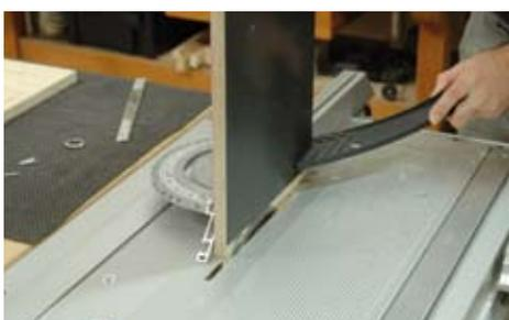
**3** In die Türe wird auf der Rückseite ein Falz geschnitten. Dieser muss genau so groß sein, dass das Stangenscharnier (Klavierband) genau hineinpasst. Das Scharnier soll weder seitlich noch innen an der Tür überstehen. Für das Schloss wird ein 20 mm Loch in die Tür gebohrt. Den passenden Abstand von der
