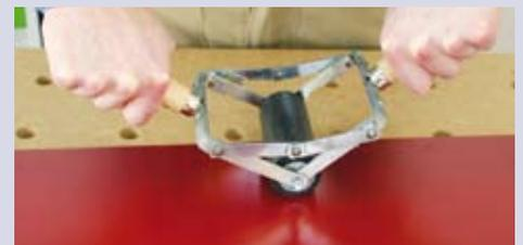
**3.** Pressen Sie die beiden Werkstücke mit Hilfe einer Andruckrolle zusammen. Sie können relativ schnell mit der Rolle über das Werkstück fahren, denn der Pressdruck ist für die Festigkeit entscheidend und nicht die Dauer. Das Werkstück kann unmittelbar nach der Klebung weiter bearbeitet werden.
