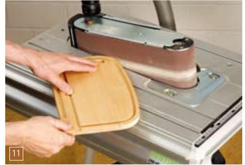
Anschließend wird die Kontur auf einem Bandschleifer oder Tellerschleifer bis zur Markierung fein geschliffen. Achten Sie dabei auf eine gleichmäßige Rundung ohne Dellen.
