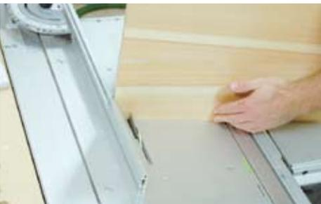
**8.** Die Rückenlehnen werden an den beiden Außenseiten schräg abgesetzt. Schneiden Sie dazu zunächst die Brüstung mit einer Tischkreissäge oder von Hand schräg ein und trennen Sie dann die Ecke vollständig heraus. In die Rückenlehnen können, um mehr Flexibilität zu erreichen, noch Schlitzze eingeschnitten werden. Zeichnen Sie sich die Mitte der Schlitzze an und legen Sie die Führungsschiene so an, dass Sie
