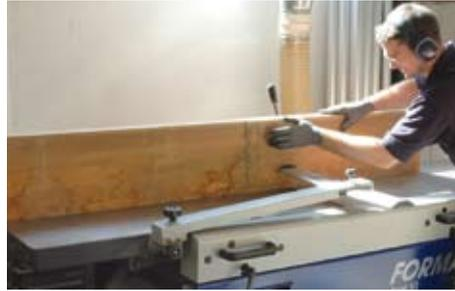
Nach dem groben Zuschnitt werden die einzelnen Streifen auf einer Fläche zunächst abgerichtet (plan gehobelt) und dann senkrecht am Anschlag des Hobels gefügt (im 90 Grad Winkel zur abgerichteten Fläche). Mit dieser gefügten Schmalfläche die Streifen später miteinander verleimen. Nach diesen beiden Arbeitsgängen werden die
