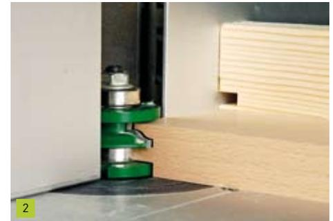
Die Holzstärke ist abhängig vom Fräser und liegt in der Regel zwischen 18 und 22 mm. Achten Sie darauf, dass der oben liegende Nutfräser nicht die Werkstückoberfläche berührt bzw. anfräst!
