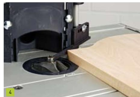
Damit am Anfang der Fräsung keine Rückschlaggefahr besteht, besitzt der Bogenfräsanschlag eine kleine Kunststoffleiste, die das Werkstück bis zum Kugellager führt. Achten Sie trotzdem ...
