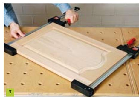
Stecken Sie die Füllung lose (ohne Leim!) in die Rahmennuten ein, damit sie ungehindert „arbeiten“ kann. Geben Sie nur Leim an die Stirnkanten der Querrahmenhölzer.
