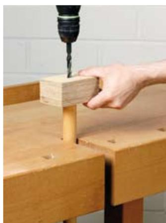
Zuerst auf dem Bohrständler ein Sackloch im Durchmesser des Rundstabs bohren. Danach mit dem passenden Dübelbohrer den Rest durchbohren (oben). Anschließend den Holzklötz auf den Rundstab stecken und das gewünschte Dübelloch bohren.
