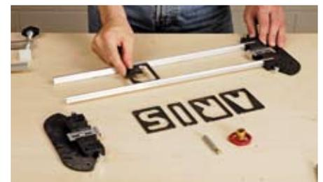
Der Aufbau ist kinderleicht. Aluschiene in die Aufnahmeträger stecken und anschließend die passenden Buchstaben einschieben.
