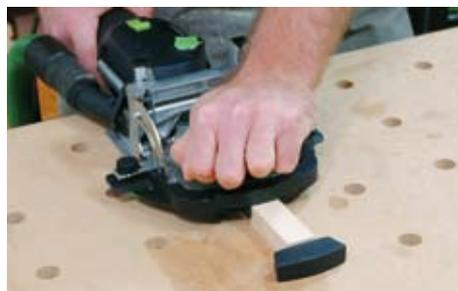
Fräsen Sie mit der Dominofräse und dem Leistenanschlag die Löcher in die Querstücke und Sprossen. Entfernen Sie dann den Leistenanschlag und fräsen Sie mit der Mittelmarkierung auf der Maschine an den Linien die restlichen Dominolöcher.
