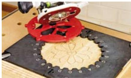
Wenn das Muster gefällt, wird es mit dem mitgelieferten V-Nutfräser und einer Oberfräse samt 17er Kopierhülse ins Holz gefräst.
