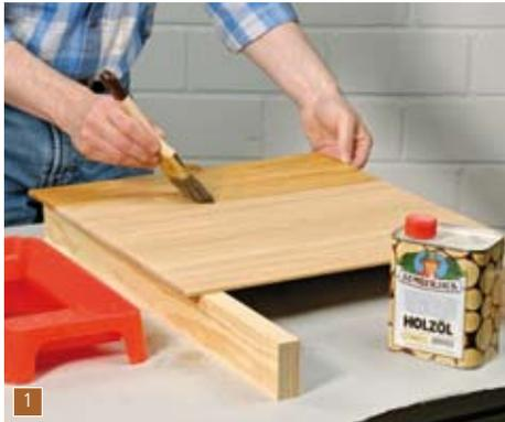
Zuerst müssen alle Teile der Schreibtischbox mindestens zweimal (besser dreimal) geölt werden. Erst nach der vollständigen Trocknung können die Seitenwände mit dem Boden und Rückteil verleimt werden. Dabei nicht vergessen den Rollladen in die Nut einzulegen!
