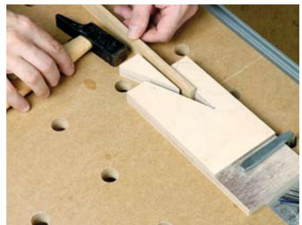
Legen Sie die Holzleiste in die Aussparung und fixieren Sie das Ganze mit dem herausgeschnittenen Keil (oben). Jetzt können Sie selbst schmale und dünne Leisten sicher hobeln (links).
