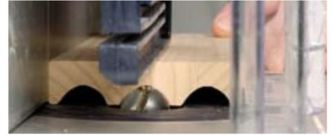
Die drei halbkreisförmigen Nuten für die Stiftschale werden auf dem Frästisch mit einem 19 mm großen Hohlkehlfräser in mehreren Fräsetappen herausgefräst.
