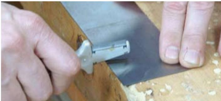
Die Ziehklinge wird jetzt flach auf eine gerade Fläche gelegt, um von beiden Seiten mit einem runden Stahl das Eisen zu verdichten. Dieses Verdichten erhöht die Standzeit des späteren Grates. Mit einem dreieckigen Stahl benötigt man wesentlich weniger Kraft, um den Grat zu erzeugen. Die Ziehklinge bleibt auf der Arbeitsfläche liegen, der Stahl wird jetzt senkrecht
