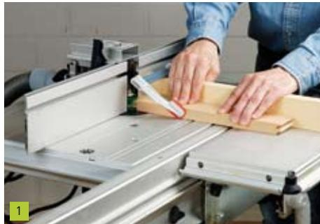
Benutzen Sie den Schiebeschleifen, um die kurzen Stirnkanten zu fräsen. Eine Holzleiste hinter dem Rahmenholz verhindert den Holzausriss und eine Zwinke hält das Werkstück sicher am Anschlag.
