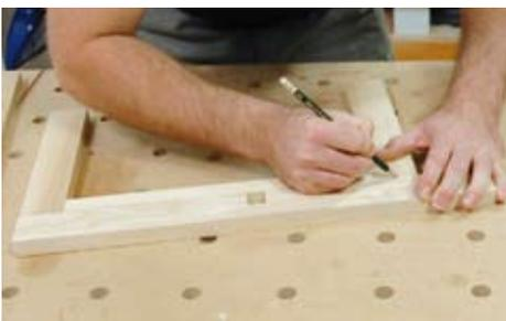
**2** Alle Dominolöcher werden mit der kleinsten Breitereinstellung gefräst. In die Querstücke und Sprossen wird jeweils mittig ein Dominoloch gefräst. Zeichnen Sie die Mitte auf den Querstücken an und übertragen Sie die Markierungen auf die Gegenstücke.
