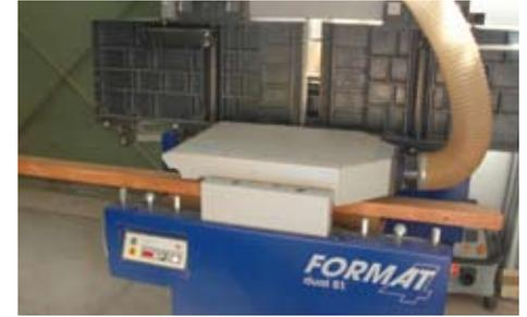
Bretter auf die passende Dicke und Breite gehobelt. Wenn die Hobelmaschine 500 mm oder breiter einstellbar ist, können Sie die einzelnen Streifen von Sitzfläche und Rückenlehnen zunächst dicker lassen und erst nach dem Verleimen auf die passende Dicke hobeln.
