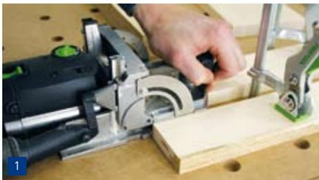
**1.** Stellen Sie zunächst mit der Domino Dübelfräse die Eckverbindungen her. Es genügt, einen Domino (hier: 8 x 50 mm) flach in beide Werkstücke einzufräsen, da die Belastungen auf diese Front nicht sehr hoch sein werden.
