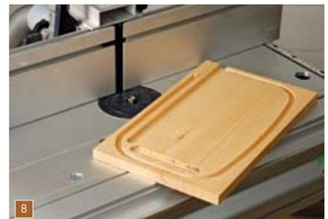
Achten Sie unbedingt darauf, dass die Nuten auf den beiden Seitenwänden spiegelbildlich sind, d. h. einmal Nuten für die linke und einmal für die rechte Seitenwand.
