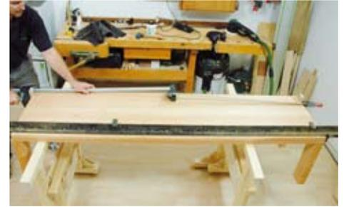
wirklich dicht zu bekommen, kann quer über die Verbindungen noch jeweils eine Zwinde auf jeder Seite angesetzt werden. Mit einem Winkel, der unter der Sitzfläche angelegt wird, jedes Bein kontrollieren, ob es rechtwinklig zur Sitzfläche sitzt. Durch Versetzen der Zwingen können Sie die Neigung der Beine beeinflussen.
