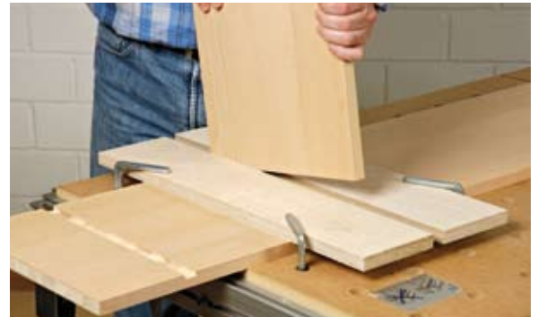
Den Abstand der beiden Führungsbretter stellen Sie mithilfe des Bodens ein, den Sie an dieser Stelle einnuten möchten. Dabei werden auch Dickentoleranzen automatisch berücksichtigt.
