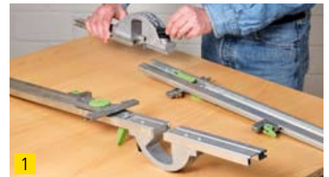
Die optional zum Parallelanschlag erhältliche Verlängerung, dient zum Zuschnitt schmaler Leisten und wird mit einer Schraube befestigt.
