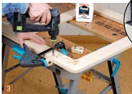
3 Scharnier mit Zwinde am Rahmen fixieren und mit einem 8 mm Bohrer ein Loch in den Rahmen bohren. Leim ins Loch geben und vorsichtig einen 8er Dübel einschlagen.
