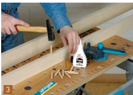
Anschließend geben Sie Leim in die Dübellöcher und schlagen die 8 x 50 mm Runddübel in die Löcher. Lassen Sie danach das Ganze mindestens eine halbe Stunde trocknen.
