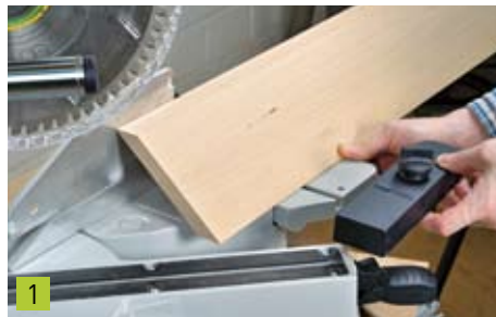
1 Mit der Winkelabstützung kann die gleiche Kranzleiste ohne die vertikale Schwenkung des Sägeblatts also in „original Wandlage“ zugeschnitten werden. Dazu wird das Sägeaggregat nur ...
