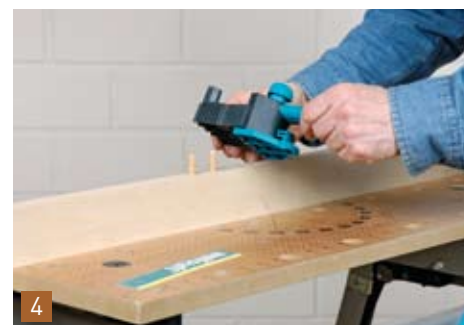
Erst mit den eingeleimten Dübeln lässt sich der Anschlag der Dübelhilfe einstellen. Dazu wird sie einfach auf die Dübel gesteckt und ihr Anschlag bis zur Rahmenseite geschoben und dort fixiert.
