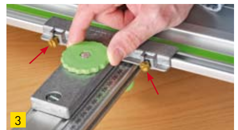
Ist die richtige Position auf der Schiene erreicht wird der Anschlag über ein Drehrad fest an die Schiene gezogen. Mit den beiden Einstellschrauben (Pfeile) kann der Anschlag genau im rechten Winkel zur Schiene justiert werden.
