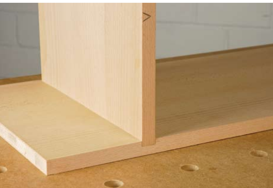
Der eingesetzte Bündigfräser muss über ein am Schaft laufendes Kugellager verfügen und im Durchmesser kleiner sein, als die Plattenstärke, die man einnuten möchte.
