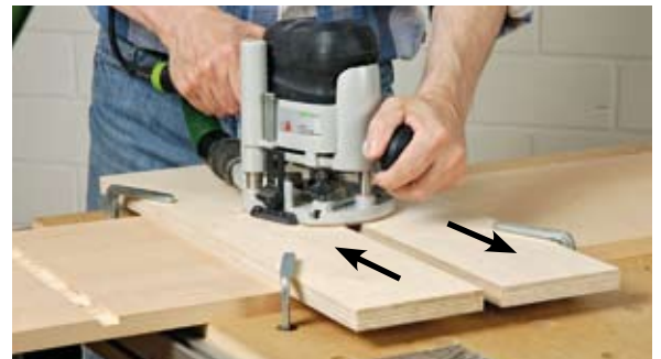
Zum Schluss müssen Sie nur noch die Fräse samt Kugellager einmal an der rechten und danach an der linken Brettkante anliegend vorbei schieben (s. Pfeile).
