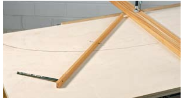
Ellipsenkonstruktion ohne langwierige Formelrechnerei: Die Bleistiftspitze bis zum Ende der Leiste ergibt den langen Radius der Ellipse. Von der Nagelspitze bis zur Bleistiftspitze wird der kleine Radius beschrieben.
