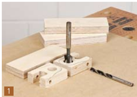
1 Zuerst werden in die 5 cm breiten und 15 cm langen Multiplexstücke 12 mm vom Ende je ein 8 mm Sackloch gebohrt und 45 mm vom Ende ein 20 mm großes Durchgangsloch. Danach den ...
