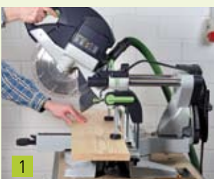
1 Säge auf den Führungsstangen bis ganz nach vorne ziehen.
