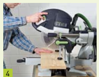
4 Sägeaggregat hochschwenken und erst danach ausschalten
