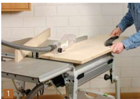
Schneiden Sie zunächst alle Bauteile genau nach der Materialliste zu. Wenn Sie keine Zuschnittmöglichkeit haben, dann lassen Sie sich das Material direkt im Baumarkt zuschneiden.
