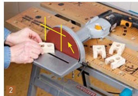
2 ... vorderen Schlitz aussägen und erst dann das Stück in der Mitte aufschneiden. Die eigentliche Kontur der Scharniere wird anschließend auf einem Tellerschleifer angeschliffen.
