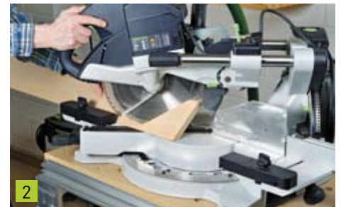
2 ... horizontal in den gewünschten Winkel geschwenkt. Dann das Sägeblatt nach vorne ziehen, einschalten und ins Werkstück eintauchen, danach das laufende Sägeblatt zurück schieben.
