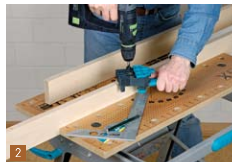
Zeichnen Sie sich auf alle aufrechten Rahmenhölzer die Positionen der Querrahmen und bohren Sie mit einer Dübelhilfe je zwei 8 mm Dübellöcher für die Querrahmen.
