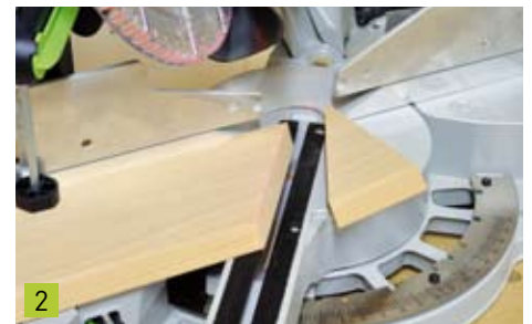
2 Wie präzise der Doppellinien-Laser den Schnittverlauf markiert, lässt sich auf diesem Bild sehr gut erkennen. Damit werden Fehlschnitte auf ein Minimum reduziert.
