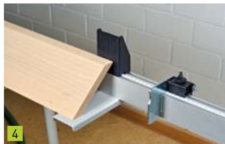
4 Die Kranzprofile können eine Breite von bis zu 168 mm aufweisen und werden auch bei langen Leisten über den optionalen Kappanschlag durch Auflageblech und Abstützung gesichert.
