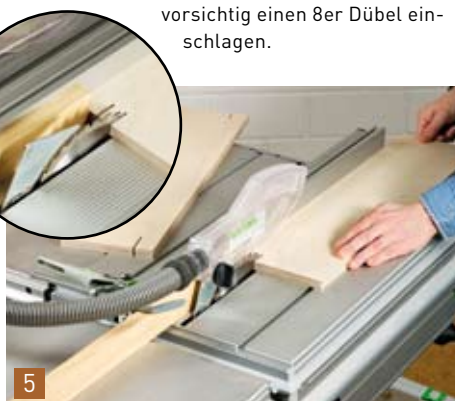
5 Die Böden in der Stärke der Rahmen 41 mm tief ausklinken. Dazu zwei Sägeschnitte mit dem Parallelanschlag machen. Eine Leiste als Anschlag sorgt für die richtige Schnittlänge.
