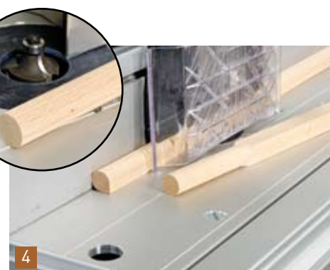
4 Die 19 mm Rundstäbe werden auf dem Frästisch mit einem 9,5 mm Abrundfräser aus 19 mm großen quadratischen Leisten herausgefräst. Dazu jede Kante einmal am Anschlag vorbei führen.
