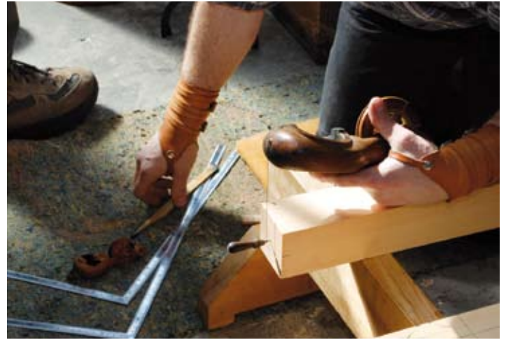
Anreißen des Mittelrisses mit der Tintenschlagschnur
