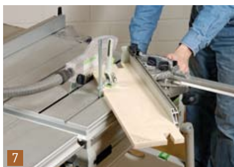
7 Alle vorderen Ecken der Böden müssen auf 45° abgeschragt werden, sonst stoßen die Ecken gegen die Regalböden der benachbarten Rahmenelemente.
