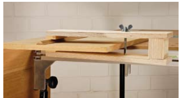
Bei minimalen Herstellungskosten und sehr einfacher Bauweise, erreicht unsere Selbstbaulösung völlig problemlos Spanntiefen von über 200 mm.
