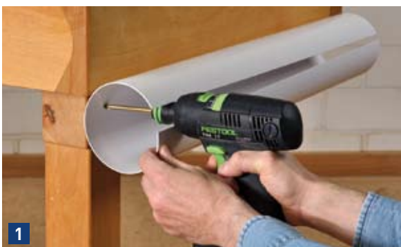
1 Das in der Länge aufgetrennte PVC Rohr wird einfach mit zwei Schrauben an der Hobelbankseite befestigt. Anschließend ...
