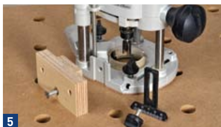
5 Mit einer 6 mm Senkkopfschraube wird das gesamte Verbindungsbrett (Halter) später an der Grundplatte der Oberfräse befestigt.
