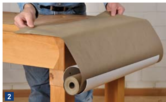
2 ... die Papierrolle ins Rohr einstecken und das Papierende durch den ca. 10 mm breiten Schlitz im Rohr über die Bank ziehen.
