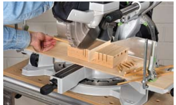
So einfach geht's: Dübelbox zum Sägeblattschlitz ausrichten und mit zwei Hebelzwingen befestigen. Schieber in den gewünschten Schlitz stecken und Dübel ablängen.
