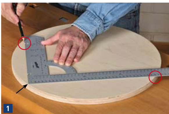
1 Winkel so auflegen, dass die Winkelecke (Pfeil) genau bündig zum Außenkreis liegt. Beide überstehenden „Winkelzungen“ mit Bleistift am Außenkreis markieren (rote Kreise).
