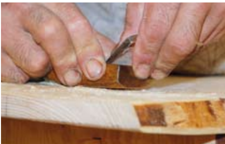
Sadatsugu Watanabe hobelt einen Zapfen bündig.
