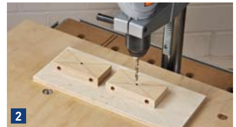
2 In die Fläche der Halter genau mittig ein 5 mm Loch für die Senkkopfschraube der Gleiter bohren.
