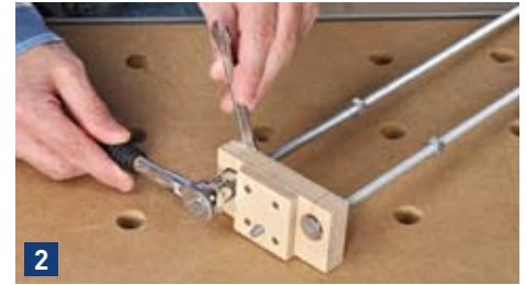
2 Gewindestangen mit zwei Muttern vor und hinter dem Oberfräsen-Halter festschrauben.
