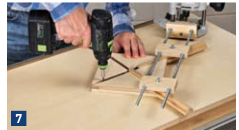
7 Das Laufkreuz genau mittig auf dem Werkstück mit zwei Schrauben oder doppelseitigem Klebeband befestigen.
