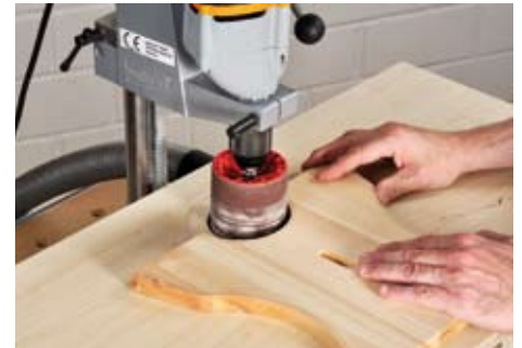
Schleifen: Mit runden Schleifhülsen wird der Bohrständer im Nu zur stationären Schleifmaschine – ideal für geschweifte Werkstücke.
