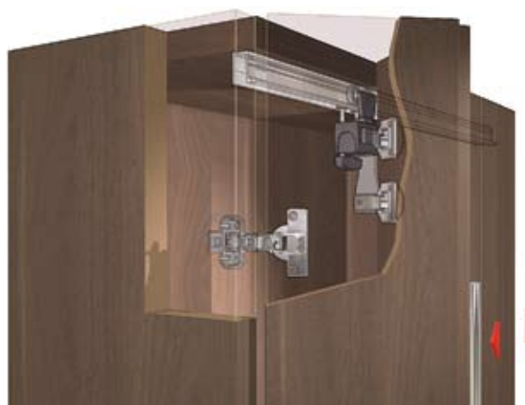
Illustrationen der Faltschiebetür-Technik am Beispiel des Beschlags Wing Line 770 von Hettich.
