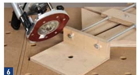
6 Als Alternative können Sie auch die Fräse samt Kopierhülse in ein 9 mm dickes Brettchen stecken, das unter den Halter geschraubt wird.
