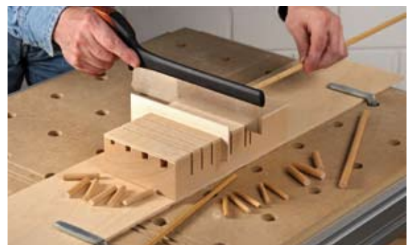
Wenn Sie keine Kapp-/Zugsäge besitzen oder wenn Sie nur wenige Dübel benötigen, können Sie die Dübelbox auch schnell und einfach mit einer normalen Handsäge benutzen.
