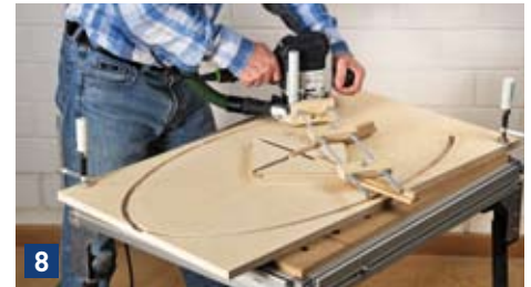
8 In zwei bis drei Etappen die Ellipse ausfräsen. Fräsen Sie aber nicht durch, sondern lassen Sie 2 - 3 mm stehen. Den Rest sägen Sie einfach ...
