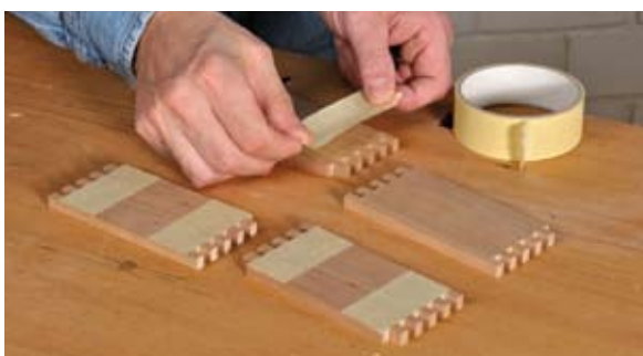
Die beste Methode bei engen Kästchen oder Zwischenräumen ist immer noch das vorherige Abkleben mit Krepp-Klebeband. Die zwei Minuten Mehrarbeit vor dem Verleimen machen ...
