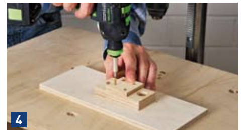
4 Ein kleines 9 mm dickes Zusatzbrettchen sorgt für den nötigen Abstand zur Oberfräsengrundplatte.
