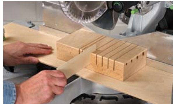
Unter die Box schrauben Sie ein langes Sperrholzbrett, damit Sie das Ganze mit Zwingen auf dem Säge Tisch befestigen können. Die Dübellänge wird durch ein dünnes Holzbrettchen festgelegt, das in den passenden Schlitz geschoben wird.
