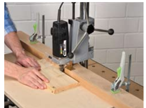
Fräsen: Mit einem Fräsmotor mit Eurohalsaufnahme wird der Bohrständer sogar zur stationären Tischfräse mit unbeschränkter Sicht auf Fräser und Werkstück.
