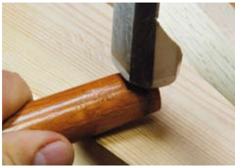
Mit Hammerschlägen wird die Holzfaser gestaucht.
