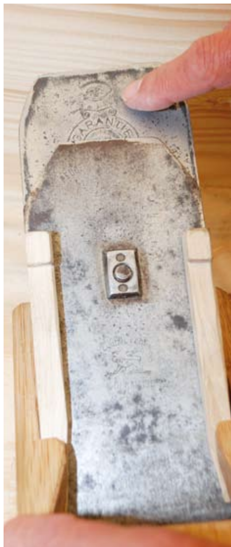
Ungewöhnliche Eigenkonstruktion eines Hobels nach japanischem Vorbild mit altem europäischem Eisen.
