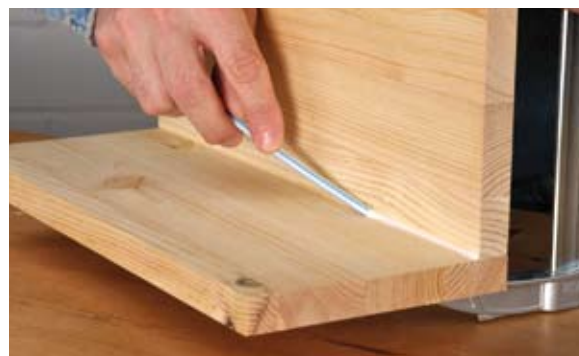
Man muss es ausprobieren, bevor man es wirklich glaubt, aber ein ganz normaler großer Strohalm passt sich genau der Ecke an und nimmt den überschüssigen Leim im Halm auf.
