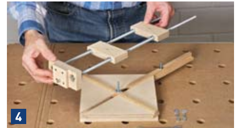
4 Den gesamten Zirkelarm auf die Gleiter stecken und mit je zwei Muttern sichern (nicht zu fest!).
