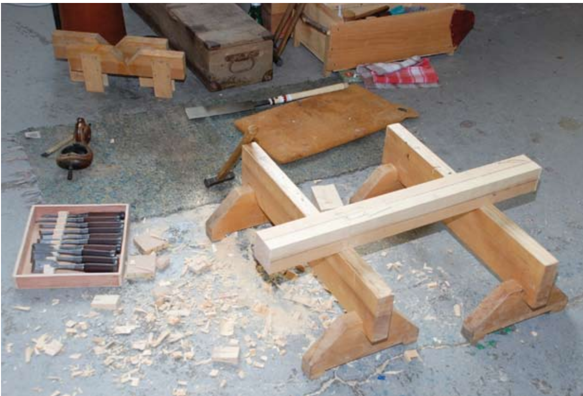
Typischer Arbeitsplatz eines japanischen Schreiners auf zwei niedrigen Böcken.
