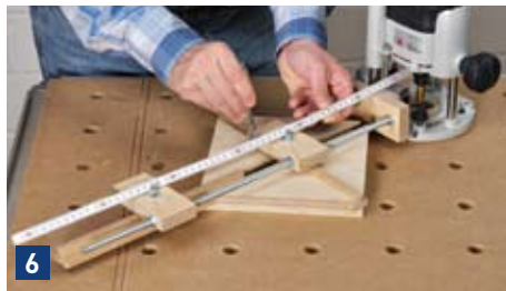
6 Mit einem Meterstab die Stangenhalter auf das gewünschte Ellipsenmaß einstellen.
