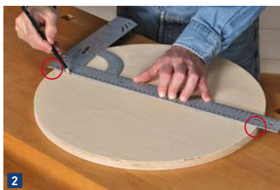
2 Diese Markierungen (rote Kreise) einfach mit einem langen Strich verbinden. Damit haben Sie den Kreis schon einmal genau in der Hälfte geteilt.
