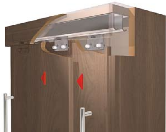
Illustrationen eines oben laufenden Schiebetürsystems am Beispiel des Beschlags Top Line 25/27.
