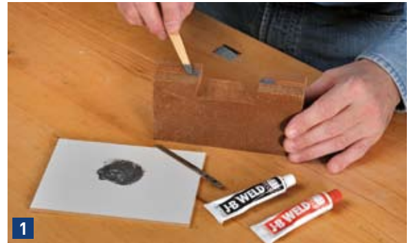
1 Das Stichsägeblatt wird mithilfe von Epoxidharzkleber in die eingefräste Nut eingeklebt. Diese Zweikomponenten-Kleber sind ideal für hochfeste Verklebungen von Metall auf Holz.
