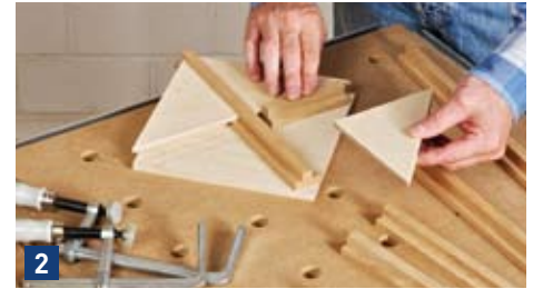
2 Den langen Gleiter unstecken und mit einem kurzen Gleiter das dritte Dreieck positionieren.
