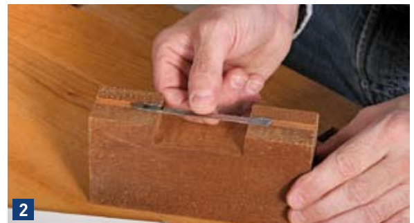
2 Anschließend das Sägeblatt fest in den noch weichen Kleber eindrücken (aber nicht verbiegen!) und danach auch von oben und an den Enden des Sägeblatts noch Kleber auftragen.
