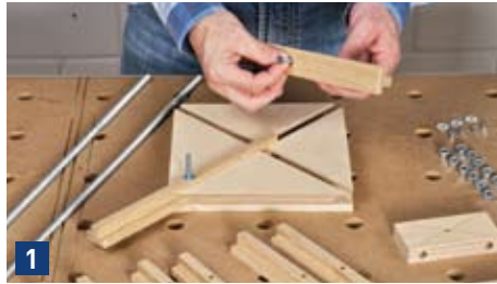
1 Zuerst die Senkkopfschraube in den Gleiter stecken und beides ins Laufkreuz schieben.
