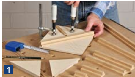
1 Mit den Gleitern zwei Dreiecke auf der Grundplatte ausrichten und von unten festschrauben.
