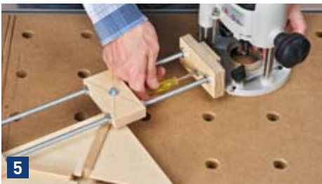
5 Oberfräse mithilfe einer M 6er Senkkopfschraube am Halter festschrauben.
