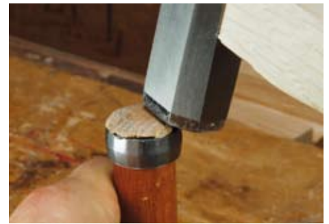
Abschließend wird das Holz am Griffende über dem Stahlring zu einer pilzförmigen Kappe vertrieben.
