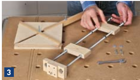
3 Zwei weitere Stangenhalter aufschieben. Vor und hinter jedem Halter muss eine Mutter sein.
