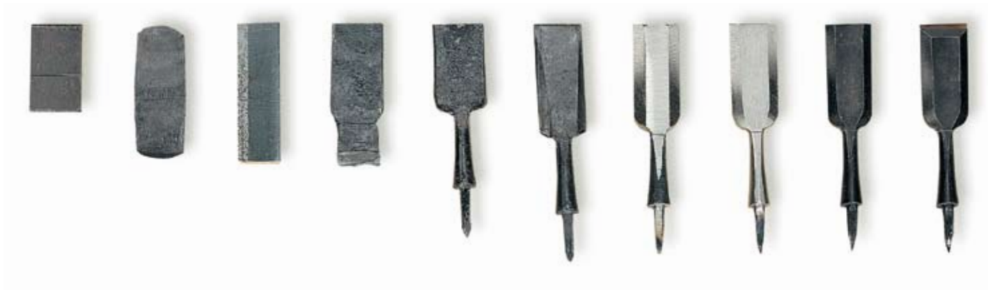
Von links nach rechts sind einzelne Stationen abgebildet, die ein japanisches Stemmeisen bei der Produktion durchläuft.
