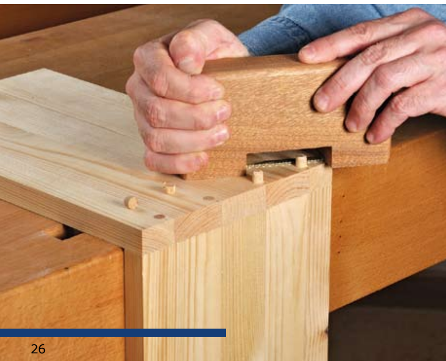
3 Nach Trocknung des Klebers (ca. 24 Std.) kann der Überstand bequem mit einem scharfen Stechbeitel entfernt werden. Zum Schluss werden alle Holzseiten noch gut abgerundet.
