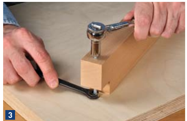
3 Sitzt die Gewindemuffe ausreichend tief im Holz, wird mit einem Maulschlüssel die Kontermutter wieder gelöst und die M6er Schraube aus der Muffe herausgedreht.
