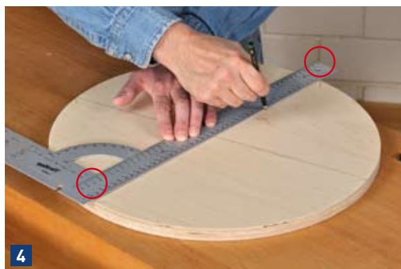
4 Auch diese beiden Markierungen wieder mit einem langen Bleistiftstrich verbinden, wobei der Schnittpunkt beider Linien genau den Kreismittelpunkt ergibt.
