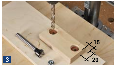
3 Das Verbindungsbrett zur Oberfräse zuerst mit einem 20 mm großen und 8 mm tiefen Sackloch versehen. Danach mit 8 mm durchbohren.
