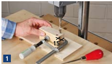
1 Zwei Stangenhalter zusammenspannen und mit einem 8 mm Holzbohrer 15 mm von außen je ein Loch bohren (Bohrpunkte vorstechen!).
