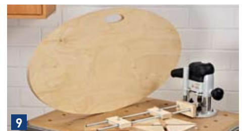
9 ... grob mit der Stichsäge aus und den restlichen Überstand fräsen Sie anschließend mit einem Bündigfräser bis zur Kante ab.
