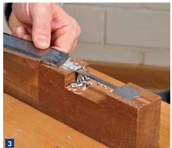
3 Nach Trocknung des Klebers (ca. 24 Std.) kann der Überstand bequem mit einem scharfen Stechbeitel entfernt werden. Zum Schluss werden alle Holzseiten noch gut abgerundet.
