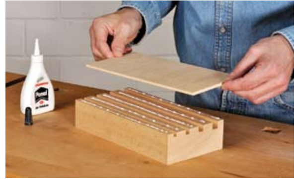
Nach dem Nuten wird ein 5 mm dickes Sperrholzbrettchen aufgeleimt. Geben Sie dabei nur einen schmalen Leimfaden neben die Nuten. Es darf kein Leim in die Nuten gelangen.
