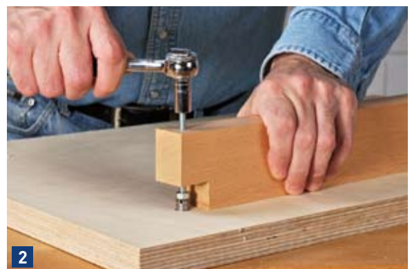
2 Leiste mit der Muffe genau über der Bohrung platzieren und mit einer Ratsche – mit etwas Druck von oben – die Gewindemuffe in die Platte eindrehen.
