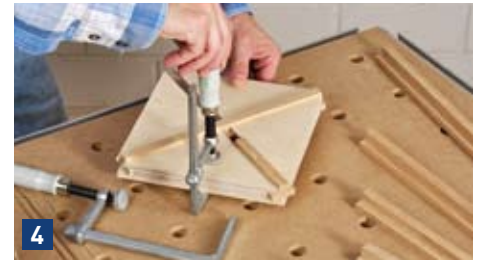
4 ... Dreieck in Position bringen, festzwingen und von unten mit drei Schrauben befestigen.
