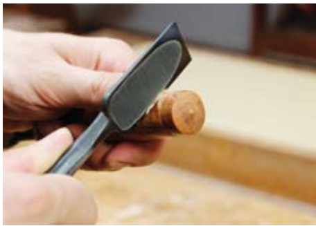
Das Abschaben der Holzfaser ist die letzte Lösung und kommt nur dann in Frage, wenn man durch Stauchen alleine nicht zum Ziel kommt.
