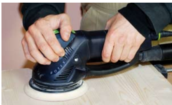
Der beim Schleifen mit Handschleifmaschinen entstehende Staub sollte abgesaugt werden. Die Holzberufsgenossenschaft empfiehlt hierfür Industriestaubsauger der Klasse M.
