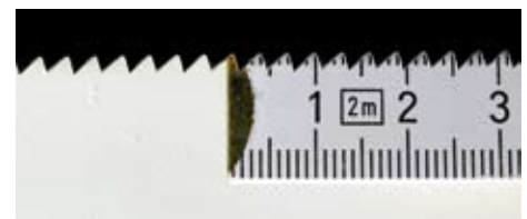
Europäische Absetzsäge: Blattstärke 0,7 mm, Blattlänge 600 mm, Zahnweite (Abstand zwischen den Zahnsitzen) 3 mm, Breite der Sägefuge 1,5 mm
