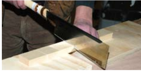
Je größer der Winkel zur Holzoberfläche ist, desto leichter lässt sich sägen.
