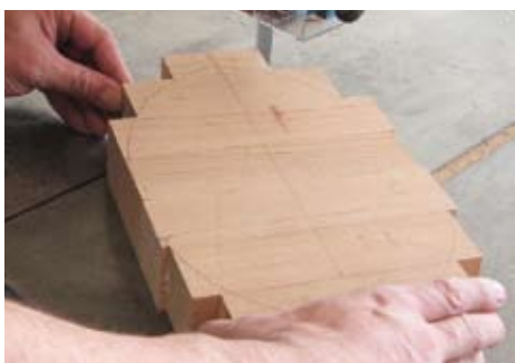
Zuschneiden der Kontur der verleimten Herzscheiben.
