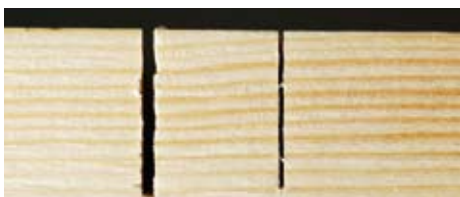
Die rechte Sägefuge stammt von einer Dozuki, während die linke Sägefuge von einer europäischen Absetzsäge stammt.
