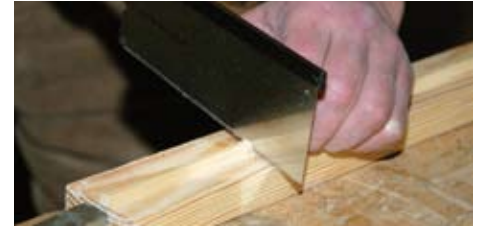
Je kleiner der Winkel zur Holzoberfläche ist, desto mehr Kontrolle hat man über die Säge.
