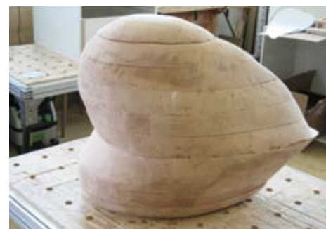
Nach dem Schleifen ist die Form deutlich erkennbar.
