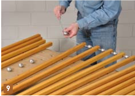
Die Hollywoodschaukel ist im Prinzip nur aus Holzleisten und Holzkugeln aufgebaut, die immer im Wechsel auf ein 5 mm dickes, kunststoffummanteltes Stahlseil aufgesteckt werden. Vor der Montage sollten Sie aber alle Holzteile mit einer Schutzlasur versehen.
