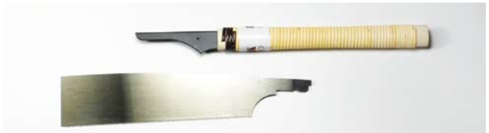
Die Sägeblätter moderner japanischer Sägen werden einfach ausgetauscht, wenn sie stumpf sind.
