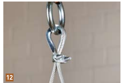
Auch ein Stahlseil kann sich mit der Zeit im Schaukelhaken abnutzen, deshalb werden zum Schutz so genannte Kauschen zwischen Haken und Seil befestigt und wieder mit Seilklemmen gesichert (Bild 12 oben).
