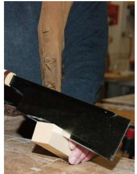
Richtig: Das Werkstück sollte in einer Hobelbank fest eingespannt sein und zwar möglichst nah an der Stelle, an der gesägt wird. So lassen sich Vibrationen effektiv reduzieren.
