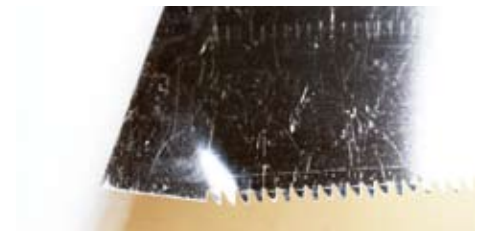
Die Spitze des Sägeblatts ist umgelenkt und verbogen.
