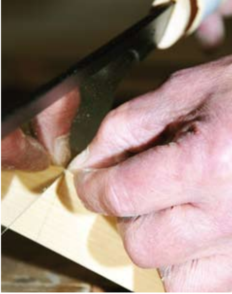
Der Daumnagel dient als Führung beim Ansägen.
