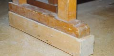
Mit Hilfe von untergelegten Kanthölzern wurde die Arbeitsfläche dieser Hobelbank angehoben.
