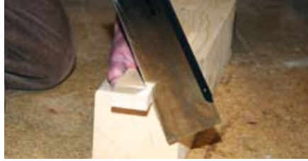
Je größer der Winkel zur Holzoberfläche ist, desto leichter lässt sich sägen.
