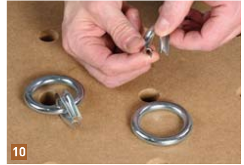
Biegen Sie die Kauschen seitlich etwas auf, bis Sie die Seilringe einstecken können. Danach werden die Kauschen einfach wieder zurück gebogen.
