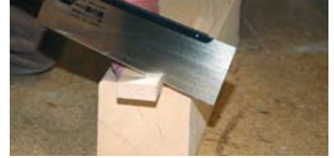
Je kleiner der Winkel zur Holzoberfläche ist, desto mehr Kontrolle hat man über die Säge.
