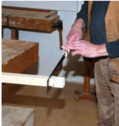
Falsch eingespannt: Durch den großen Abstand zur Bankzange vibriert das Holz während des Sägens.
