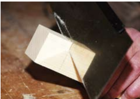
Falsch eingespannt: Durch den großen Abstand zur Bankzange vibriert das Holz während des Sägens.
