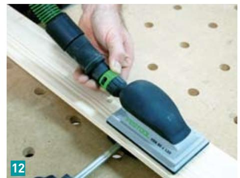
licht (**Bild 12**). Dieser Adapter aus flexiblem Kunststoff gibt dem Schleifklotz die nötige Bewegungsfreiheit. Um den Schleifklotz ohne die Absaugung zu verwenden, kann der Adapter abgenommen werden.
