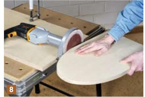
8 Den ellipsenförmigen Teil der Rückenlehne schleifen Sie anschließend einfach mit einem Tellerschleifer. Dabei müssen Sie nur darauf achten, nicht die gesägte Kante anzuschleifen!
