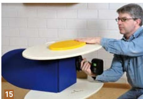
15 Zu guter Letzt werden noch die ellipsenförmigen Aufdopplungen mit den Seitenteilen verschraubt. Dazu werden einfach unterhalb der Sitze zwei Löcher vorgebohrt und die Aufdopplung mit dem Akkuschrauber befestigt. Anschließend die Schraubenköpfe mit farblich passendem Wachsitt verschließen.
