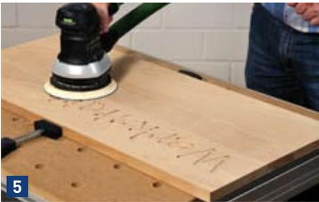
5 Nach dem Fräsen aller Buchstaben wird die Holzfläche sauber geschliffen. Die Kanten der Hohlkehlen dürfen Sie dabei nicht schleifen bzw. „brechen“. Ungleichmäßig gebrochene Kanten ...
