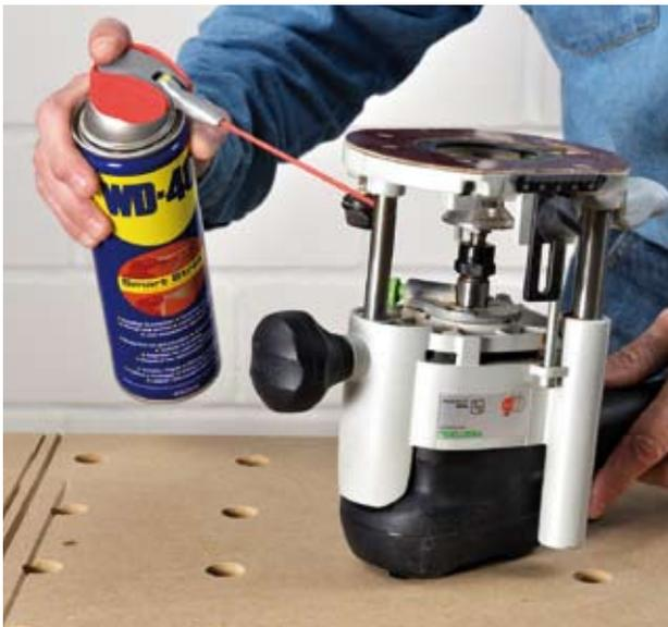
Da sich die Maschine beim Router Carver ständig über die Hubsäulen leicht auf und ab bewegt, sollten Sie die Führungssäulen vor dem Fräsen mit einem geeigneten Schmiermittel (z. B. WD 40) einsprühen. Die Grundplatte dabei mehrmals auf und ab bewegen, damit sich das Mittel in den Hülsen der Hubsäulen gleichmäßig verteilen kann. Achten Sie auch auf einen leichten Lauf des Kugellagers am Gravurfräser.
