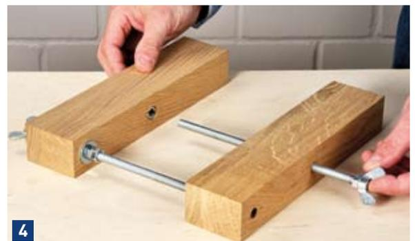
Jetzt das Gegenkantholz (mit der Einschraubmutter am Ende) mit dem gekonterten Gewindestab verbinden. Zum Schluss den Gewindestab mit Flügelmutter in das mittlere Loch stecken und in die gegenüber liegende Einschraubmutter eindrehen.
