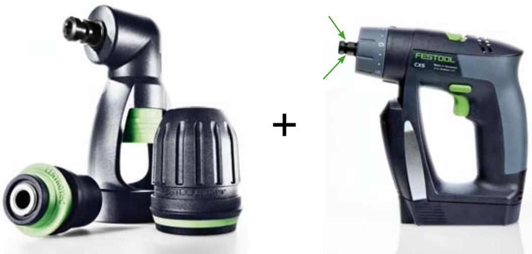
Auch der neue CXS verfügt über eine FastFix-Schnittstelle (grüne Pfeile) für noch mehr Flexibilität beim Schrauben und Bohren. In diese Aufnahme können Sie nicht nur die Bits direkt einstecken, sondern in Sekundenschnelle auch das mitgelieferte Standardbohrfutter und das kompakte und präzise Centrotec-Werkzeugfutter. Und wenn es ganz eng wird, lässt sich dort auch genauso schnell der
