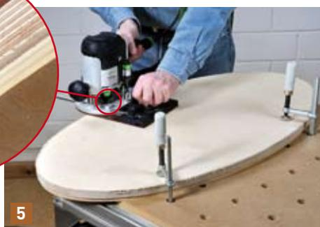
5 Den Überstand der Multiplexplatte können Sie jetzt präzise mit einem Bündigfräser (kl. Foto) passend bis zur Schablonenkante abräsen. Das Kugellager muss dabei genau an der ...
