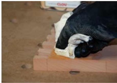
...und geölt, damit sich der Leimüberschuss, der beim Verleimen nach innen herausgedrückt wird, leichter entfernen lässt. Dabei sollte man darauf achten, dass der Bereich der Verbindung nicht mit Öl in Berührung kommt, damit die verleimte Fläche nicht verkleinert wird.
