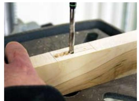
**1** Der Zapfen entspricht bei dieser Verbindung exakt dem einer einfachen Schlitz- und Zapfenverbindung und wird daher wie zuvor hergestellt. Das Zapfenloch reißen Sie mit dem Streichmaß von der Werkzeichenseite aus an, so dass es genau  $\frac{1}{3}$  der Materialstärke entspricht. Begrenzen Sie es mit dem Winkel entsprechend der Rahmenbreite.
