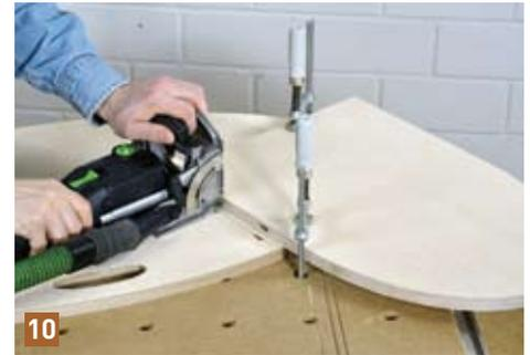
10 Jetzt wird die Maschine flach auf das Seitenteil gelegt und die Gegenschlitzte in die Kante der Rückenlehne gefräst. Genauso verfahren Sie anschließend auch mit der Sitzfläche.
