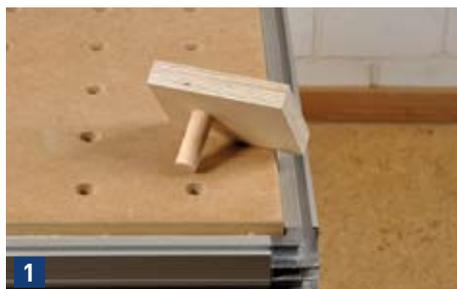
Ein 40 - 50 mm langer Rundstab ( $\varnothing$  20 mm) unter dem Multiplexbrett macht es möglich, die Lampe an jeder Lochposition des MFT (Multifunktionsstisch) einzustecken.
