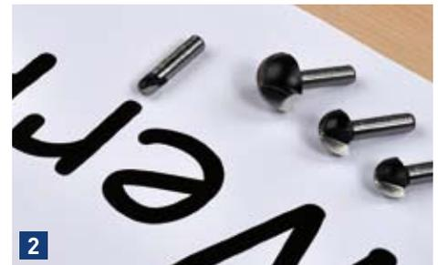
Wählen Sie einen Hohlkehlfräser aus, der in etwa so breit ist wie die Strichstärke der Schrift, damit Sie die Schriftform in einem Arbeitsgang einfräsen können.
