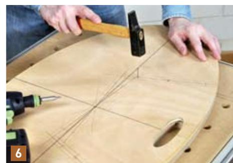
6 ... Schablonenkante anliegen. Bevor Sie dann die Schablone wieder losschrauben, werden zuerst noch die Markierungspunkte für Sitz- und Rückenlehne mit einem Nagel angekörrt.
