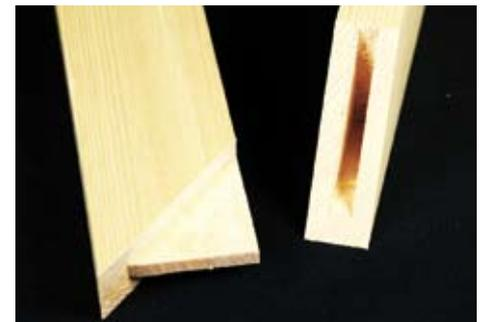
Die voll verdeckte Schlitz- und Zapfenverbindung wird bevorzugt im Rahmenbau verwendet.
