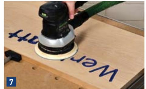
7 ... jedoch nicht zu empfehlen. Farbe würde in die Poren laufen und die Holzoberfläche muss dann bis auf diese Porenebene komplett abgeschliffen oder besser noch abgehobelt werden.
