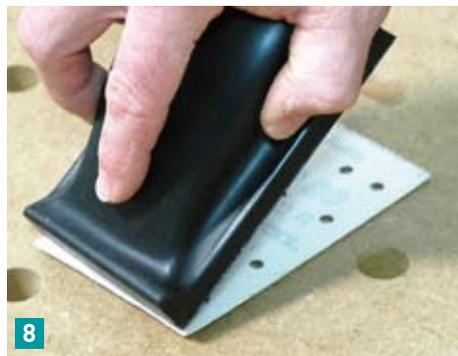
Alternativ gibt es auch eckige Schleifklötze für die Schleifpapiergröße 130 mm x 80 mm (Festool RTS 400). Auch hier hält der Klett das Schleifpapier unter dem Klotz (**Bild 8**). Die kleinere Form und der ergonomische Griff machen diesen Schleifklotz handlicher.
