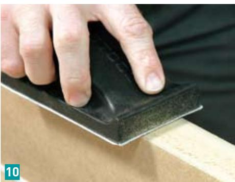
Im direkten Vergleich mit einem Modell ohne Absaugung wird der Vorteil aber schnell sichtbar. Auf der geschliffenen Fläche bleibt kein Staub zurück. Alles wird vollständig abgesaugt (**Bild 10/11**). Die Absaugung verzögert auch
