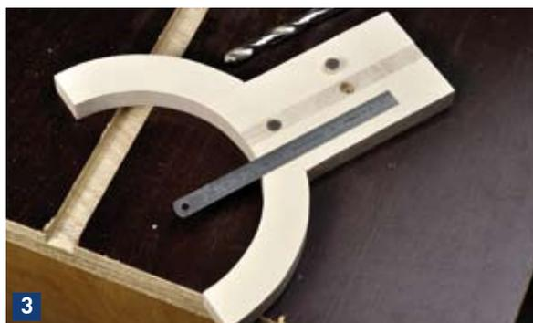
3 Bohren Sie die beiden 10 mm Rundmagnete mithilfe eines Bohrständers in die Nut. Achten Sie darauf, dass Sie die Magnete nicht zu tief einbohren, sie dürfen aber auch nicht vorstehen.
