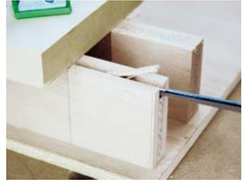
**3** Bearbeiten Sie zunächst nur die Rahmen-aufrechten und schneiden Sie den schraffi-erten Bereich zur Herstellung des Schlitzes mit zwei Längsschnitten ein. Sägen Sie dabei mög-lichst präzise den halben Riss.
