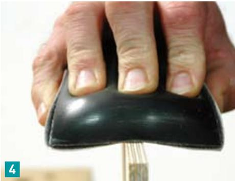
Die weiche Ausführung des Schleifklotzes eignet sich, um einer Kontur zu folgen oder Flächen zu schleifen. Wird er auf einer Schmalfläche eingesetzt, tritt der Effekt ein, der mit überhöhtem Druck auf **Bild 4** angedeutet wird.
