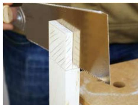
**1** Zeichnen Sie den Längsrisse und den Absetzrisse wie zuvor erläutert auf der Vorderseite (Werkzeichenseite) Ihrer Rahmenstücke an. Der Absetzrisse wird mittels Winkel auch auf die Schmalflächen des Rahmens und beim aufrechten Rahmenteil auf die Rückseite wegen der späteren Ausarbeitung übertragen.
