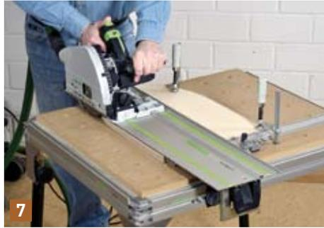
7 Die Rückenlehne ist nur im oberen Bereich ab 250 mm ellipsenförmig gerundet. Die unteren 250 mm müssen gerade und parallel auf 330 mm Breite zugeschnitten werden.
