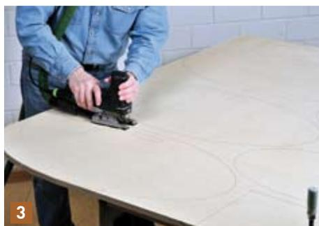
3 Dann werden alle Holzteile entsprechend des Zuschnittplans aufgezeichnet und mit einer Stichsäge samt Kurvensägeblatt ausgesägt. Bleiben Sie dabei etwa 3 mm vom Strich weg, ...
