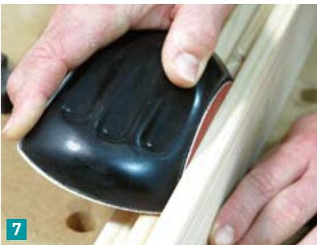
Ein Falz wird zunächst waagrecht mit der Fläche des Schleifklotzes geschliffen, dann wird der Klotz leicht geneigt und das an den Flanken hochgeklappte Schleifpapier schleift die senkrechte Fläche (**Bild 7**).
