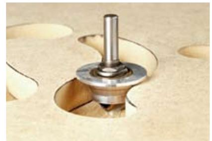
Das schräge Kugellager macht's möglich: Je nach Konturbreite der Schablone taucht der Fräser mehr oder weniger tief ins Holz ein und erzeugt so einen einzigartigen, dreidimensionalen Schnitzeffekt.
