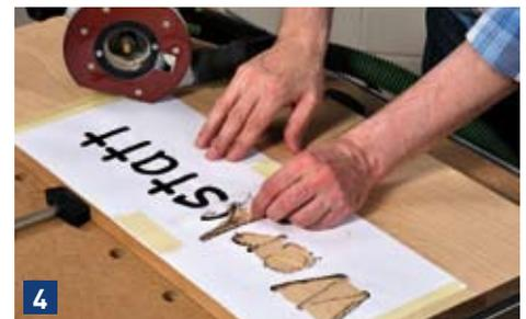
... Sie die laufende Maschine wieder genau so aus der Schrift heraus und schalten dann erst die Fräse aus. Nach jedem Buchstaben die störenden Papierschnipsel entfernen.
