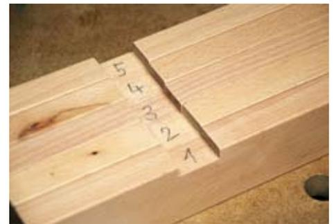
...erleichtert das Schleifen der Innenrundung der Leisten. Wichtig: Bevor die Kreuzüberblattungen hergestellt werden, müssen sowohl die Leisten als auch die Korpusseiten möglichst fertig geschliffen werden. Alles, was später im Bereich der Kreuzüberblattung geschliffen wird, führt zu offenen Fugen im Verbindungsbereich.
