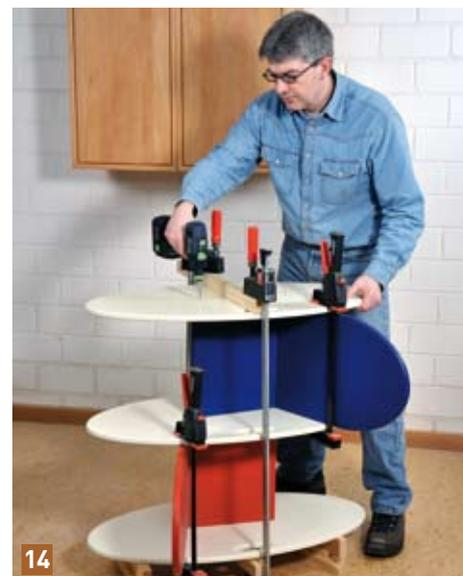
14 Ist der Lack gut durchgetrocknet, kann mit dem Verleimen begonnen werden. Dazu geben Sie in alle Schlitze ausreichend Leim und stecken die Dominos ein. Zuerst sollte nur ein Stuhlelement mit Sitz und Lehne verleimt werden. Nach dem Trocknen des Leims können Sie dann die weiteren Holzteile verleimen. Zusätzlich befestigen Sie das Seitenteil im Bereich der Sitzfläche mit einigen Holzschrauben. Die Schraubenlöcher werden später von den Aufdopplungen verdeckt.
