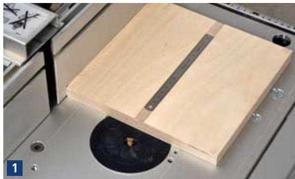
1 Fräsen Sie zuerst eine Nut in die Mitte des Multiplexbretts, die genau der Breite und Dicke des Stahlmaßstabs entspricht. Der Stab sollte sich darin spielfrei verschieben lassen.
