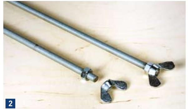
Damit Sie die Gewindestangen bequem drehen können, drehen Sie zuerst eine M 8er Mutter auf und anschließend eine M 8er Flügelmutter. Ziehen Sie beide Muttern gegeneinander fest (kontern).
