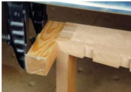
An der Schmalseite lässt man ein stabiles Kantholz überstehen. So können auf der gesamten Breite Zwingen angesetzt werden und es entsteht gleichmäßiger Druck.
