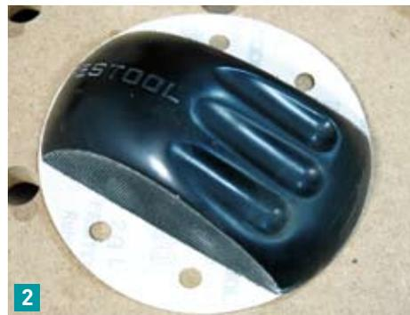
Der Klotz wird auf der Mitte der Schleifscheibe angedrückt (**Bild 2**). Durch Hochklappen der Seiten und Andrücken auf den Klett sitzt das Schleifpapier fest. Die Kanten der Klötze sind in einem Winkel, spitzer als 90 Grad, abgeschrägt.
