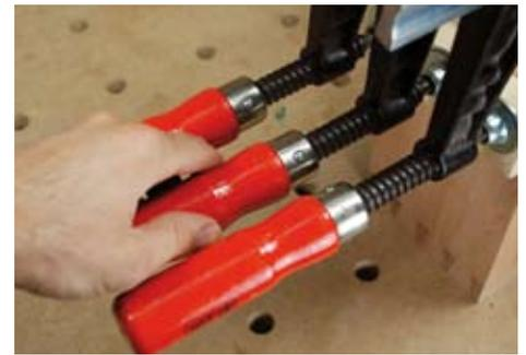
Setzt man alle drei Zwingen von einer Seite an ist der Zwischenraum zwischen den Griffen zu gering, um den Griff der mittleren Zwinge voll zu umfassen.
