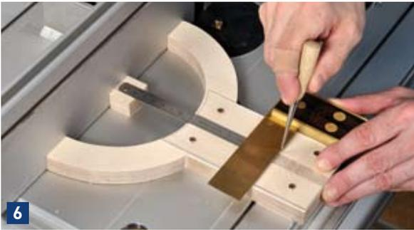
Zum Anritzen der Haarlinie legen Sie die Messlehre flach auf den Frästisch gegen den Fräsanschlag. Der Messfühler muss dabei genau am Anschlag anliegen. Jetzt ritzen Sie mithilfe eines Winkels und einer scharfen Anreißnadel eine Haarlinie in das Acrylglas, die sich genau über dem Nullpunkt des Stahlmaßstabs befindet.
