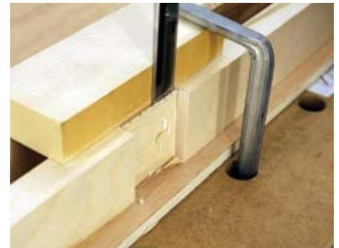
**1** Reißen Sie jeweils von der Werkzeichenseite aus die halbe Materialstärke an und begrenzen Sie die Überblattung auf beiden Werkstücken durch zwei Absetzrisse. Ob das senkrechte oder das quere Rahmenholz auf der Sichtseite „durchläuft“, entscheiden Sie hierbei nach optischen Gesichtspunkten.
