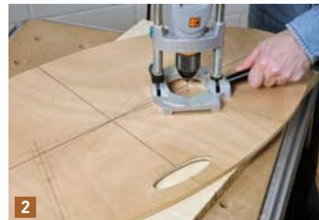
2 Bohren Sie mit einem dünnen Bohrer (1,5 - 2 mm) genau senkrecht Markierungslöcher, um die Positionen mit einem Nagel zu übertragen.
