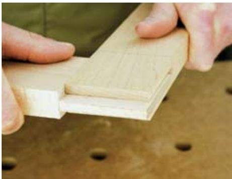
**7** Prüfen Sie die Verbindung hinsichtlich ihrer Passgenauigkeit und arbeiten Sie falls nötig mit einem Stecheisen nach.
