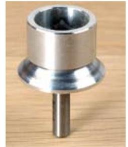
Wie weit der V-Nutfräser aus dem Kugellager herausstehen sollte, können Sie mit dem Metallring genau feststellen. Stecken Sie ihn dazu einfach auf das Kugellager und prüfen Sie, ob die Fräterspitze genau bis zum Ringende reicht. Falls nicht, wird die Mutter am Schaft gelockert und das Kugellager über ein Gewinde neu eingestellt.
