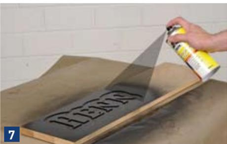
7 Am besten gelingt der Farbauftrag mit einer Sprühdose. Dabei werden selbst kleinste Ecken und Konturen vom Sprühnebel erfasst. Nach dem Trocknen die obere Fläche wieder schleifen.
