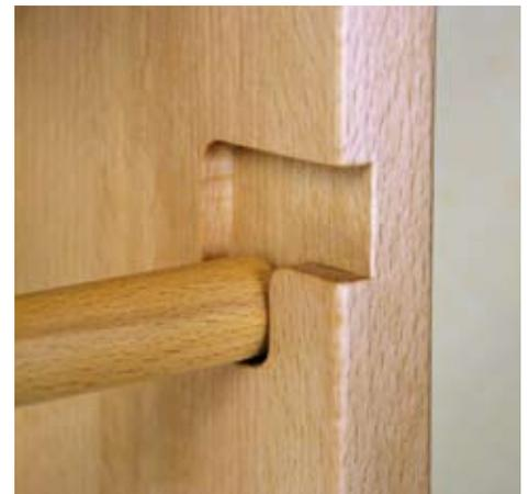
Die Halte-Nut in L-Form für den Rundstab wurde mit Hilfe einer Frässhablone hergestellt.
