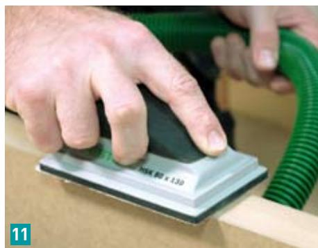
das Zusetzen des Schleifpapiers. Luft gekühlt wird. Um das Festsaugen auf Flächen zu reduzieren, kann im Adapter zwischen Schlauch und Schleifklotz ein Schlitz geöffnet werden, der das Einströmen zusätzlicher Luft ermög-
