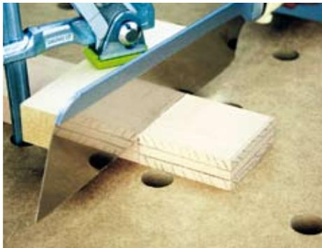
**6** Die Zapfen werden bewusst erst nach dem Herstellen der Schlitzte ausgearbeitet, denn falls ein Schlitz zu eng oder zu weit geraten ist, kann der Zapfen nun noch angepasst werden. Sägen Sie zunächst wieder die Längsschnitte in Faserrichtung ein.
