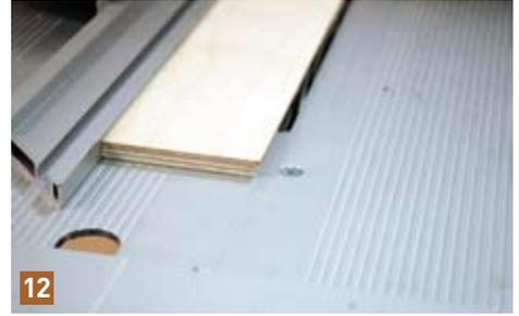
Bei manchen Werkzeugen benötigen Sie auch Langlöcher. Diese können Sie mit der DOMINO Dübelfräse fräsen oder zwischen zwei Löchern mit der Stichsäge ausschneiden. Für den Winkel wird ein Schlitz mit der Tischkreissäge geschnitten. Wenn Sie den im Bild verwendeten Akku-Bohrschrauber (Festool CXS) integrieren möchten, müssen Sie in den oberen Zwischenboden
