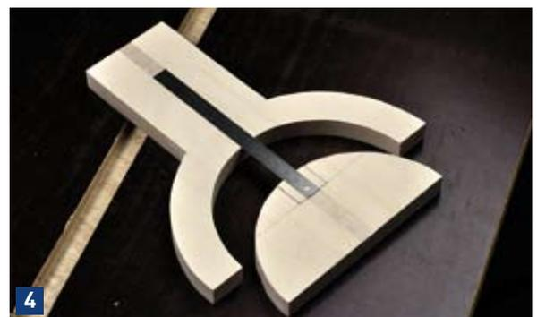
4 Aus dem Abfallstück mit der Nut sägen Sie sich den „Messfühler“ zurecht, der anschließend an das Ende des Stahlmaßstabs geschraubt wird.
