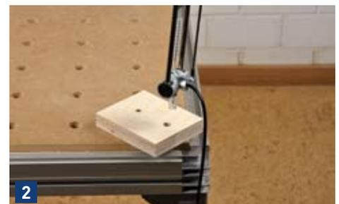
Anschließend muss nur noch der Stiftsockel der Lampe in die passende Bohrung auf der Oberseite des Bretts eingesteckt werden und schon ergibt sich eine perfekt ausgeleuchtete Arbeitsfläche.
