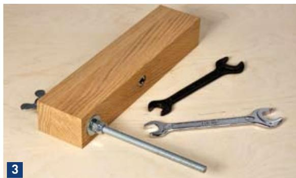
Stecken Sie eine Gewindestange in das hintere 8 mm Loch ein und stecken Sie anschließend eine Unterlegscheibe und zwei Muttern auf. Beide Muttern so miteinander kontern, dass sich der Stab mithilfe der Flügelmutter noch leicht drehen lässt.
