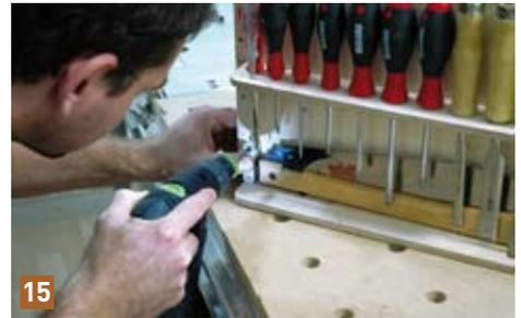
Die Schubkasten Teile (12 + 13) werden nun auf Gehrung zugeschnitten. Verleimt werden Sie mit Hilfe von Klebeband. Kleben Sie den Schubkastenboden von unten ein und spannen Sie ihn mit Zwingen. Bohren Sie in die beiden Griffseiten (Pos. 14) ein 15 mm Loch, in das der Rundstab (Pos. 15) eingesteckt werden kann.
