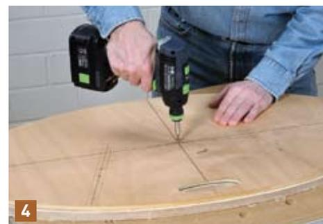
4 ... um den Rest mit der Oberfräse und der Schablone genau auszufräsen. Befestigen Sie anschließend die Schablone mit drei Schrauben auf dem Seitenteil.
