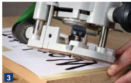
Stellen Sie die Frästiefe auf maximal 3 mm ein und schwenken Sie die laufende Maschine über die Grundplatte in die Schrift. Wenn der erste Buchstabe ausgefräst haben, schwenken ...
