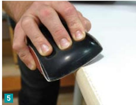
Die Fläche wird im Außenbereich mehr abgeschliffen als in der Mitte. Beim Schleifen von Rundungen wird dieser Biegeeffekt positiv genutzt (**Bild 5**).
