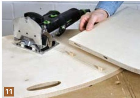
11 Danach werden die Zwingen entfernt und zur Probe ein paar DOMINO Dübel ohne Leim eingesteckt um die Passgenauigkeit zu überprüfen. Einfacher geht es wirklich nicht mehr und wer einmal mit diesen Dübeln gearbeitet hat, wird schnell die Vorzüge zu schätzen wissen und den Runddübel wahrscheinlich nicht mehr einsetzen.
