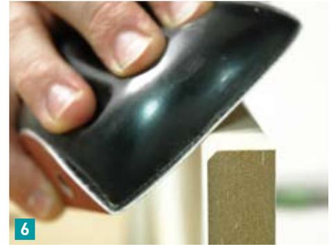
Mit der harten Ausführung lassen sich auch schmale Kanten ohne Verformung schleifen. Beim Schleifen von Fasen ist der Effekt der gleiche und das zuvor gefräste Profil bleibt unversehrt (**Bild 6**).
