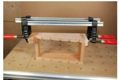
Drei Qualitätszwingen pro Seite sorgen für ausreichend Druck, um die Hartholzverbindung zu verleimen. Ziel ist immer, dass alle Fugen dicht werden.
