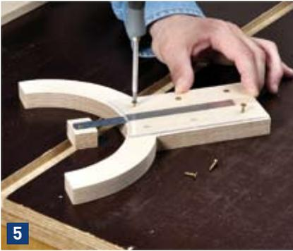
Zum Schluss schrauben Sie eine 2 mm dicke Acrylglascheibe über den Stahlmaßstab. Drehen Sie die Schrauben am besten von Hand ein, damit das Acrylglas nicht bricht.
