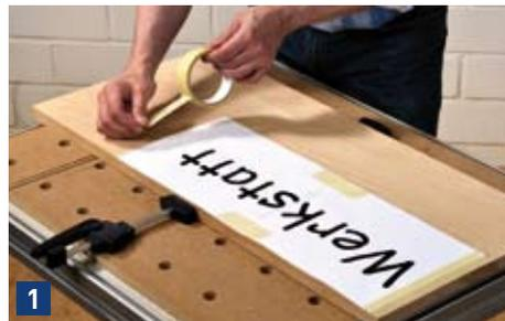
Erstellen Sie die Schrift in der gewünschten Größe auf dem PC und drucken Sie sie auf Papier aus. Befestigen Sie anschließend das Papier mit Klebeband auf der Holzplatte.
