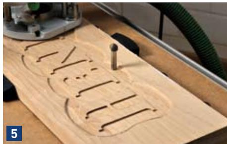
5 ... Sie den Namen mit einer geschwungen Außenkontur umfließen. Diese Kante wird dann zum Schluss noch mit einem Hohlkehlfäser bearbeitet.
