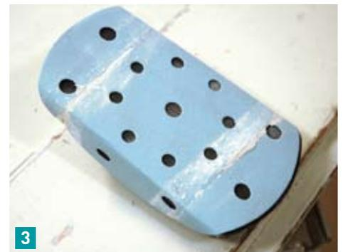
Das vermindert das unbeabsichtigte Schleifen an angrenzenden Flächen. Beim Schleifen von Lacken in Falzen kommt es schnell zu Ablagerungen am Knickpunkt des Schleifpapiers. Durch die runde Form kann man die Scheibe einfach weiterdrehen (**Bild 3**).
