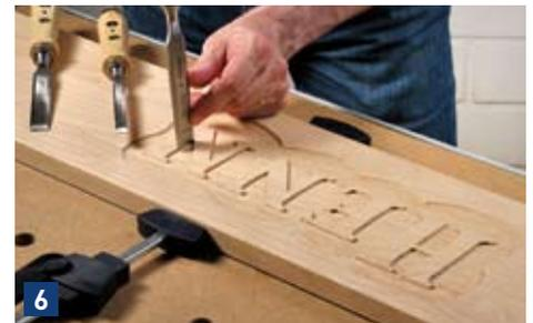
6 Mit dem Stechbeitel stechen Sie die geraden Linien der Schrift etwas nach, um die unvermeidlichen kleinen Ruckler beim Fräsen zu entfernen. Auch scharfkantige Ecken im Schriftbild müssen so nachgearbeitet werden.
