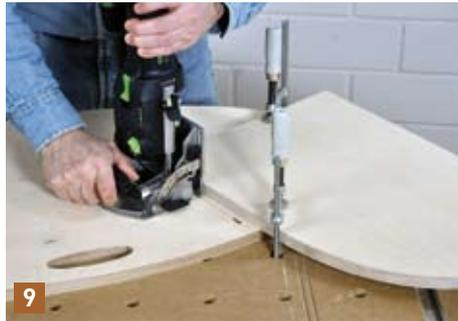
9 Befestigen Sie die Rückenlehne mit Zwingen auf dem Seitenteil und fräsen Sie zuerst mit der DOMINO Dübelfräse jeweils zwei Schlitzte für 5 x 30er DOMINO Dübel in das Seitenteil.
