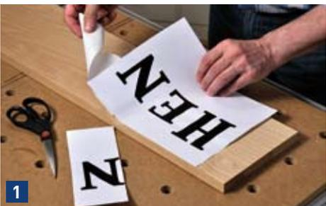
1 Drucken Sie die Schrift auf selbstklebendes Papier, ziehen Sie die rückseitige Folie ab und kleben Sie es vollflächig auf. Klebeband eignet sich für diese Methode nicht und Sprühkleber hinterlässt Kleberückstände auf dem Holz.
