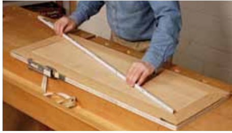
Sofort nachdem der Spanngurt angezogen wurde, sollten Sie unbedingt mit einem Meterstab die Rechtwinkligkeit des Rahmens überprüfen, indem Sie beide Diagonalen nachmessen.
