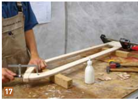
17 das ganze Traggerüst zusammen. Beim ersten Schritt kann das Loch für das spätere Zugseil ideal als Haltepunkt für die Festool-Schraubzwingen eignen sich für alle anderen Verleimaufgaben. Hilfreich ist bei der Verleimung der schrägen Seitenteile
