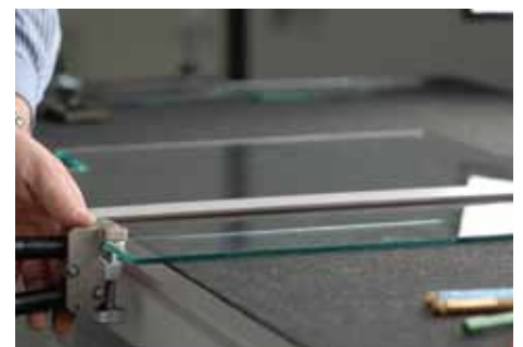
Schnittlaufzange (BO 704.0) für Glasstärken von 6 – 15. Bild Fa. Bohle
