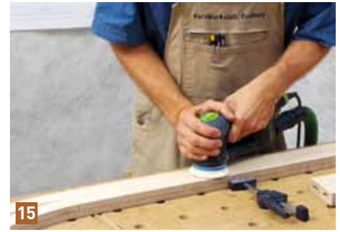
15 schmalen Flächen und Kanten ideal mit dem Getriebeexzentrerschleifer ROTEK RO 90 erledigen. Mit der Verwendung des Interface-Pads lassen sich sogar Innenrundungen schleifen. Die Flächen werden mit hartem Schleifteller und Körnung P120 glatt geschliffen.
