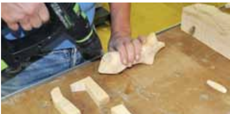
Bohren der Löcher zum Anbringen der Glieder
