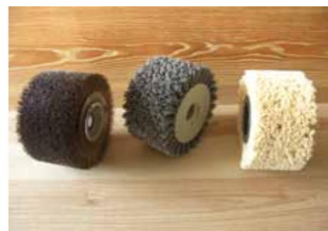
Links die Rustilonbürste LD 85 aus Litzenstahldraht zum Bearbeiten von Hartholz oder für einen hohen Abtrag in Weichholz. In der Mitte KB 80 zum Bearbeiten von Weichholz oder zum Zwischenschliff mit eingebettetem Schleifkorn K 80. Rechts BG 85 zum Glätten und Reinigen mit Sisalborsten.
