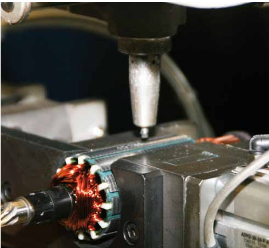
Motorenfertigung in Neidlingen. Hier wird die Ankerwelle ausgewuchtet
