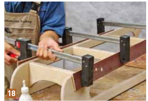
18 mit den Querträgern ein mit Schleifpapier verleimtes Unterlagbrett. Das verhindert ein Abrutschen und Beschädigungen durch Druckstellen.
