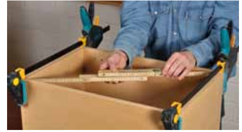
Befinden sich die Zwingen bereits am Korpus, können Sie das Stichmaß bzw. die beiden Diagonalen am besten mit zwei Meterstäben nachmessen.
