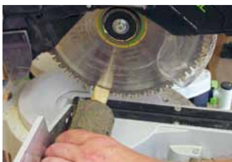
Mit der KAPEX die Flamme auf eine Länge von 70 mm zuschneiden.
