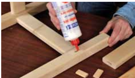
Bei Dübel und Dominos geben Sie mit der Dosierspitze nur Leim in die Bohrungen und Fräsungen. Sie müssen nicht zusätzlich noch Leim auf Dübel oder Dominos geben.
