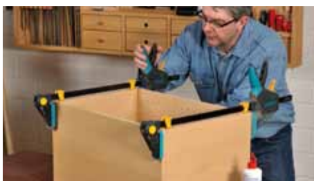
Richtige Position: Die Schiene läuft mittig über Deckel und Bodenkante und die gesamte Spannfläche der Backen ist ausgenutzt.
