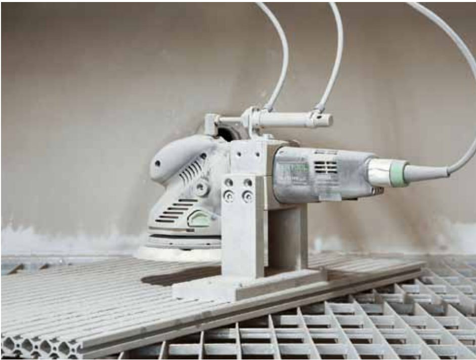
Stundenlange Tests der Maschinen in der Staubkammer mit dem besonders aggressiven Arizona-Staub
