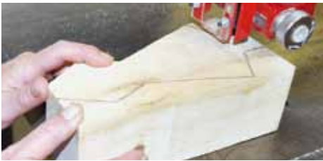
Sägen des Korpus mit der Bandsäge
