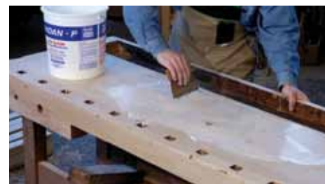
Bei großen Flächen verteilt man den Leim am besten gleichmäßig mit einem Zahnspachtel. Am einfachsten klappt das mit Leim direkt aus einer Dose oder einem Eimer.
