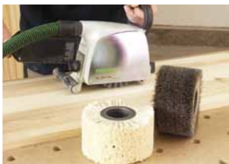
Mit dem RUSTOFIX lassen sich Flächen, Formteile aber auch Balken bei der Sanierung von Fachwerk einfach bearbeiten.
