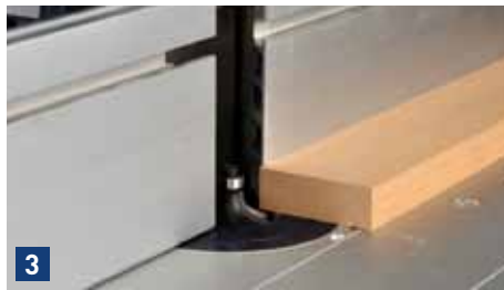
Weiterhin können Sie die Position des Profils beeinflussen, indem Sie die Lage der Leiste am Fräsanschlag verändern: flach auf der Tischfläche (Bild 3) oder hochkant am Fräsanschlag anliegend (Bild 4).
