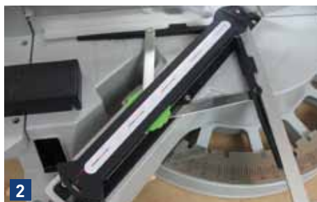
Beide Aluschenkel wieder zurück schieben und die arretierte Schmiege gegen den linken Anschlag legen. Zum Schluss Sägeblatt mithilfe des Lasers auf die gestrichelte Linie ausrichten.
