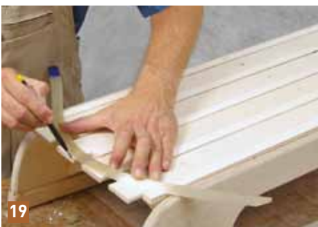
19 Die Verteilung der Sitzlatten (Pos. 5) kann mit Hilfe von Abstandsleisten vereinfacht werden. Im so aufgelegten Zustand lässt sich der Bogen der Sitzleisten anzeichnen, mit der Stichsäge aussä-
