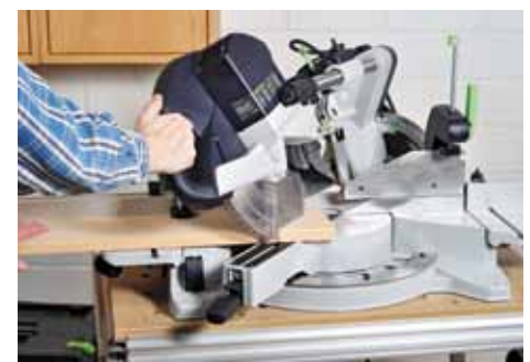
Auch Doppelgehrungen bzw. Schifterschnitte sind mit dem schwenk- und neigbaren Sägeblatt problemlos möglich und jede Einstellung lässt sich präzise an den Skalen ablesen.
