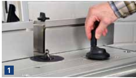
Wie tief und an welcher Stelle das Profil ins Holz gefräst wird, können Sie zum einen über die Fräserhöhe (Bild 1) und zum anderen über den Fräsanschlag (Bild 2) festlegen.
