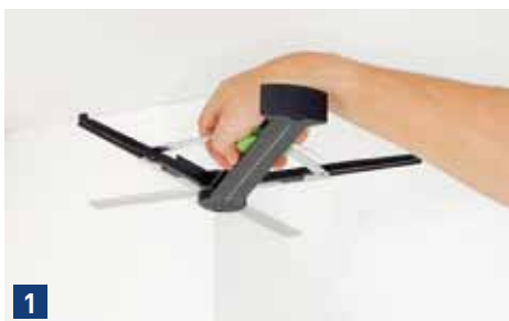
Aluschenkel nach vorne schieben und dicht an den Wandaußenecken anlegen. Dann mit dem grünen Rändelrad die Schenkelpositionen fest arretieren.
