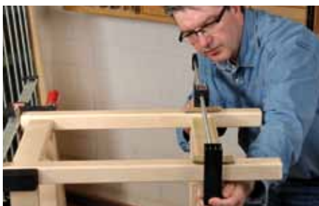
Achten Sie beim Ansetzen der Zwinde darauf, dass die Zwingenschiene immer parallel zum Bauteil verläuft. So vermeiden Sie schon im Vorfeld, dass die Zwinde das Werkstück aus dem rechten Winkel „zieht“. Zum Schutz vor Druckstellen durch die geriffelte Schiene sollten Sie zudem noch ein paar dicke Kartonstreifen unterlegen.
