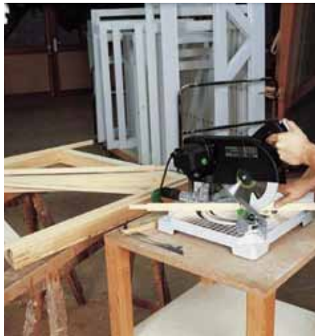
Auch beim Verglasen von Fenster, Türen oder Möbeln müssen die Glashalteleisten präzise auf Gehrung gesägt werden (links). Eine Massivholzkante, die auf eine Spanplatte aufgeleimt werden soll, sieht am besten aus, wenn sie an den Ecken genau auf Gehrung gearbeitet wurde (oben).
