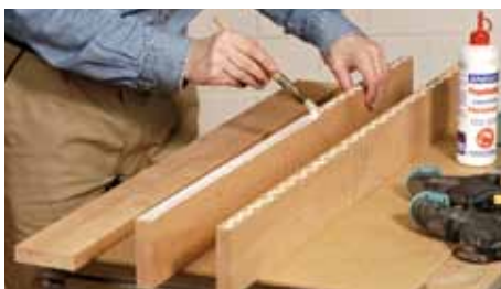
Bei der Leimholzherstellung wird zunächst mit der Dosierspitze Leim auf die Kante gespritzt und anschließend mit einem Leimpinsel gleichmäßig auf der Kante verteilt.
