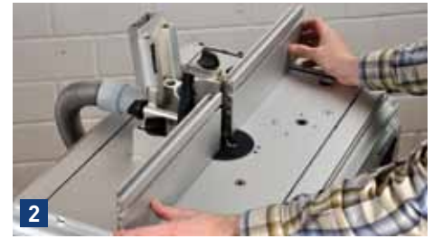
Wie tief und an welcher Stelle das Profil ins Holz gefräst wird, können Sie zum einen über die Fräserhöhe (Bild 1) und zum anderen über den Fräsanschlag (Bild 2) festlegen.
