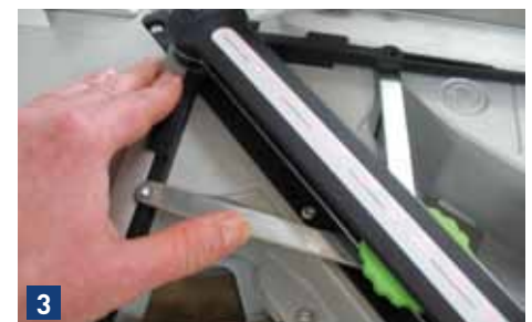
Für die gegenüberliegende Gehrung die Winkelschmiege gegen den rechten Anschlag legen und das Sägeblatt wieder nach rechts schwenken, bis der Laser auf die gestrichelte Linie zeigt.
