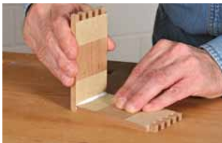
Die Innenecken eines Kästchens oder Korpus einfach mit Krepp-Klebeband abkleben. Dann nach dem Trocknen das Klebeband zusammen mit dem ausgetretenen Leim abziehen.
