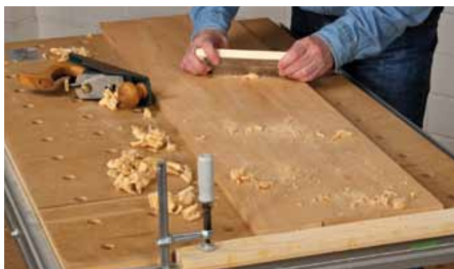
Den ausgehärteten Leim auf einer Leimholzplatte sollten Sie zuerst mit einer Zieh Klinge entfernen, bevor Sie zum Schluss die Fläche noch einmal „fein“ mit dem Putzhobel bearbeiten. Sie schonen auf diese Weise die mühsam geschärften Messer und die Sohle des Putzhobels.
