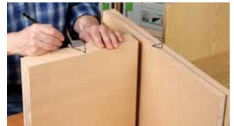
Das so genannte Schreinerdreieck, kann zusätzlich noch mit Zahlen kombiniert werden, um die Zuordnung und weitere Bearbeitung auf der Hobelmaschine zu vereinfachen.
