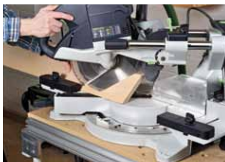
Die KAPEX bietet nicht nur eine größere Schnittkapazität, sondern auch Zubehörteile, wie z. B. diese Winkelabstützung, die das Einpassen von Kranzprofilen in „original Wandlage“ ermöglicht.
