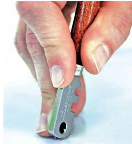
So wird der Glasschneider gehalten. Bild Fa. Bohle
