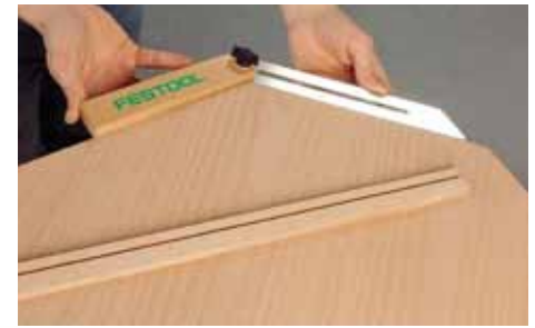
Auch beim Verglasen von Fenster, Türen oder Möbeln müssen die Glashalteleisten präzise auf Gehrung gesägt werden (links). Eine Massivholzkante, die auf eine Spanplatte aufgeleimt werden soll, sieht am besten aus, wenn sie an den Ecken genau auf Gehrung gearbeitet wurde (oben).
