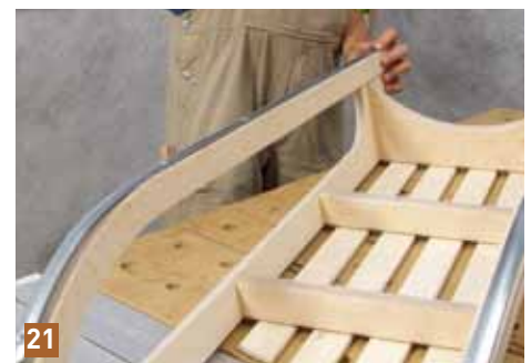
21 Kufenbeschläge aus Stahl (Pos. 10), womit die Fahrdynamik des Rodels optimiert wird.
