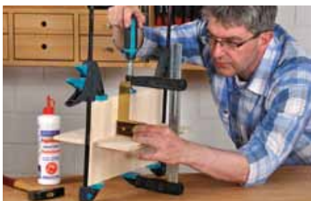
Die Rechtwinkligkeit kleinerer Bauteile können Sie auch gut mit einem hochwertigen Winkel kontrollieren. Indem Sie die Zwingenposition nur minimal auf der Kante verändern, lässt sich das Bauteil problemlos etwas nach rechts oder links verschieben, bis es dicht am Winkel anliegt.
