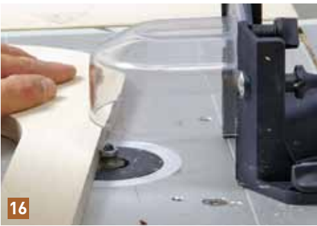
16 Ein Abrundfräser (R= 5 mm) in stationär eingebauter Oberfräse erledigt die Kantenrundung. Die folgende Verleimung erfolgt in drei Schritten: Zunächst werden in zwei Schritten jeweils Längsträger (Pos. 2) und Kufen (Pos. 1) verleimt, als letztes fassen dann die Querträger (Pos. 3 +4)
