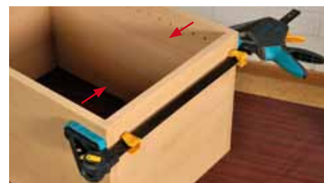
Falsche Position: So drücken die Backen die Seitenwände nach innen und es ergibt sich eine offene Fuge im Außenbereich des Bodens.
