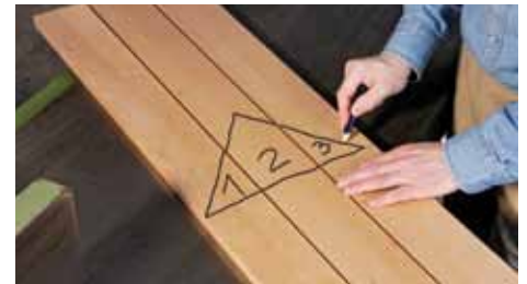
Das so genannte Schreinerdreieck, kann zusätzlich noch mit Zahlen kombiniert werden, um die Zuordnung und weitere Bearbeitung auf der Hobelmaschine zu vereinfachen.
