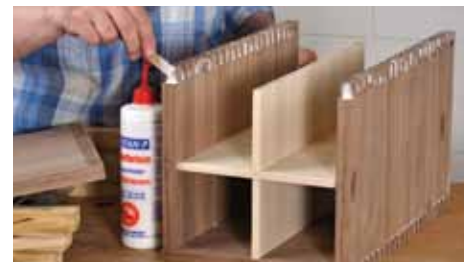
Bei Zinken- und Zapfenverbindungen geben Sie den Leim zunächst mit der Dosierspitze zwischen die Zinken und verteilen ihn dann mit einem dünnen Holzstreifen.
