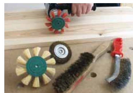
Das Arbeiten mit der Bohrmaschine ist auf großen Flächen nicht sehr effektiv, kann aber zum Testen oder für kleine Werkstücke eine Alternative sein.
