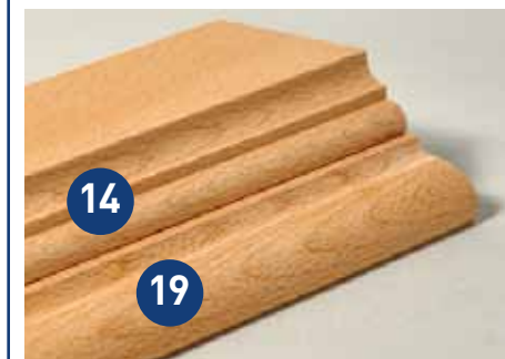
In dem Sie mehrere profilierte Bretter zusammenleimen oder notfalls auch schrauben, können Sie im Handumdrehen weit ausladende und groß dimensionierte Kranz- oder Sockelprofile herstellen. Das linke 40 mm hohe Profil wurde beispielsweise aus den beiden Profilen Nr. 14 und 19 zusammengesetzt. Das 60 mm hohe rechte Profil besteht aus drei 20 mm dicken profilierten Leisten.
