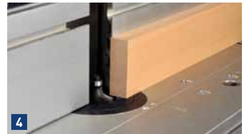
Weiterhin können Sie die Position des Profils beeinflussen, indem Sie die Lage der Leiste am Fräsanschlag verändern: flach auf der Tischfläche (Bild 3) oder hochkant am Fräsanschlag anliegend (Bild 4).
