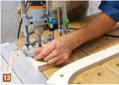
13 Bei Bohrungen mit Forstnerbohrern bewährt sich alternativ zu einer festen Bohrhilfe die Verwendung eines kleinen mobilen Bohrständers, der für die Rechtwinkligkeit und die Tiefeneinstellung genügend Führung bietet und durch sein geringes Gewicht sehr handlich
