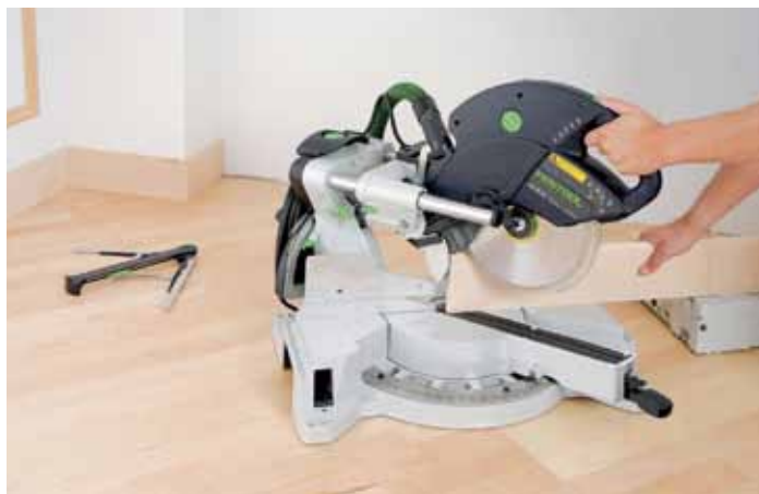
In Altbauten sind die Sockelleisten oft über 80 mm hoch, so dass eine SYMMETRIC nicht mehr eingesetzt werden kann. Aber auch bei der Kapp-Zugsäge KAPEX gelingt die korrekte Einstellung der Gehrung dank einer mitgelieferten Spezialschmiege auch ohne langwieriges Ausrechnen der Winkelhalbierenden.
