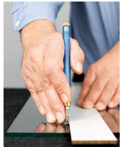
Schneiden mit Ölglasschneider BO 4001 Bild Fa. Bohle
