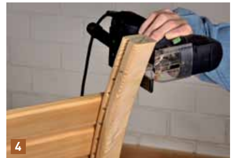
4 Markieren Sie sich die Position des obersten Rückenbretts und geben Sie noch 9 mm Zwischenraum dazu. Sägen Sie dann den oberen Teil der Rückenlehne mit der Stichsäge ab.
