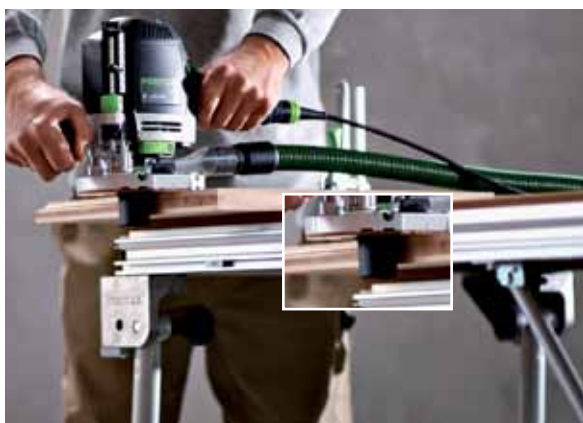
Beim Fräsen kann die Absaugung sehr nahe an der Einsatzstelle erfolgen, aber nicht direkt auf dem Werkstück. Die Kunststoffhülse vor dem Fräser hilft dabei.
