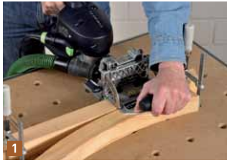
1 Damit der Anschlag der DOMINO Dübelfräse genügend Auflage hat, sollten Sie immer ein zweites Teil mit der gleichen Dicke als zusätzliche Unterlage lose dazu legen. Die Maschine wird dann ...
