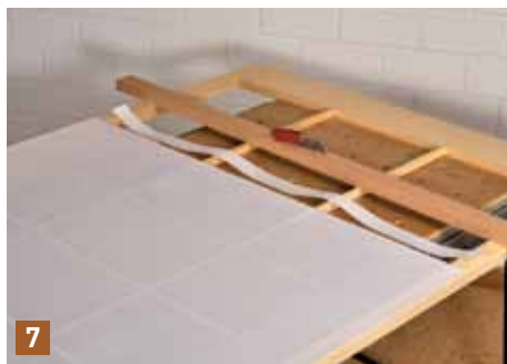
7 Das überstehende Papier wird anschließend mit dem Cuttermesser und einer geraden Hartholzleiste genau bündig zur Quersprosse abgeschnitten. Zum Schluss dann auch die letzten beiden Sprossenfelder auf die gleiche Weise mit dem MADOCA-Papier bekleben.
