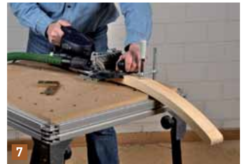
7 ... flach auf der Tischoberfläche und der Anschlag schwebt mit etwas Luft darüber. Er sorgt mit dem zusätzlichen Leistenanschlag nur dafür, dass die Maschine nicht verrutscht.
