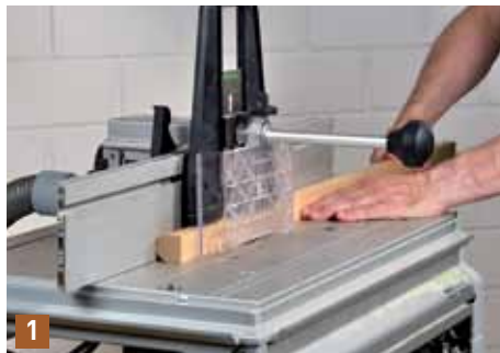
Wenn Sie einen Frästisch besitzen, können Sie die Rundstäbe auch mit einem Abrundfräser ganz leicht selbst herstellen. Dazu benötigen Sie vier quadratische Leisten mit 30 mm ...
