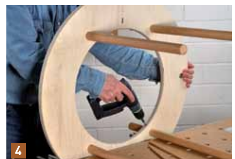
mit einer Dübelhilfe ein senkrecht Loch, das ungefähr mittig durch das 30er Loch verläuft. Dann den Rundstab einstecken und das Loch noch durch den Stab hindurch verlängern.
