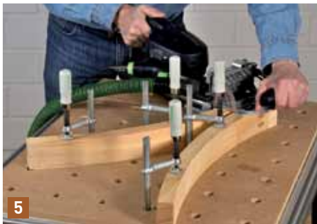
5 Da die Armlehnen breiter sind und seitlich jeweils 8 mm über den vorderen Fuß hinaus ragen, muss auch der Anschlag der Dübelfräse um 8 mm höher gesetzt werden.
