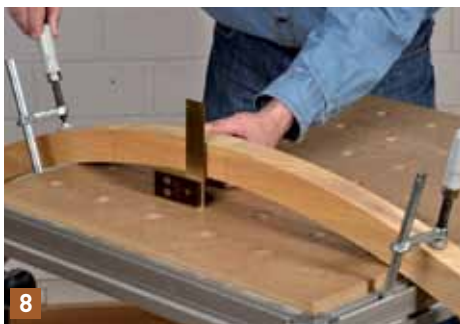
8 Für den Gegenschlitz legen Sie die Rückenlehne auf den Tisch und richten sie mit einem Winkel genau auf die zuvor gemachte Markierungslinie für den DOMINO Dübelschlitz aus.
