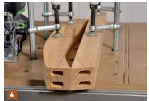
4 ... Skalenfenster an. Nach dem ersten Schlitz werden die Werkstücke immer gedreht und auch von der anderen Seite bearbeitet, so dass ein Doppelschlitz (Doppelzapfen) entsteht.
