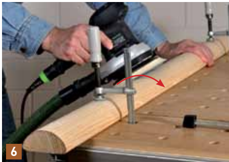
6 Die letzten Unebenheiten werden dann noch mit dem Exzentrerschleifer herausgeschliffen. Dabei die Kontur mit dem Exzentrerschleifer immer in Pfeilrichtung rund abfahren.
