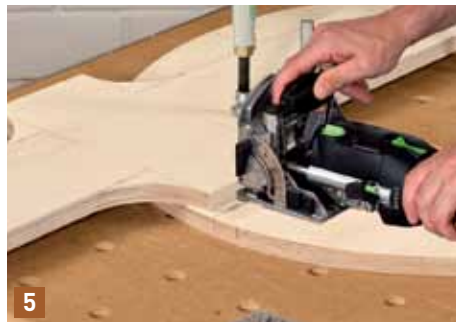
Dann legen Sie die Maschine flach auf das Rad und fräsen auch in die Stirnkante des Sitzbretts je zwei DOMINO Dübel ein, diesmal aber mit einer Frästiefe von 25 mm!
