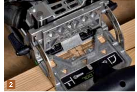
2 ... einfach über das Skalenfenster im Anschlag genau auf die zuvor gemachten Markierungslinien ausgerichtet (Schlitttiefe 25 mm für 50 mm lange Sipo-DOMINO Dübel).
