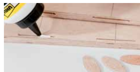
Beim Dübeln ist das Wasser im Leim nicht nur Lösemittel. Es lässt Flachdübel quellen und verstärkt damit die Verbindung.
