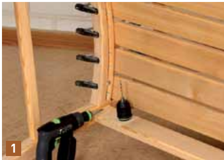
1 Fixieren Sie alle Sitzbretter mit Zwingen, bohren Sie dann zuerst mit einem 3,5 mm Bohrer vor (auch etwas in die Sitzbretter), versenken Sie die Löcher etwas und schrauben Sie zum ...
