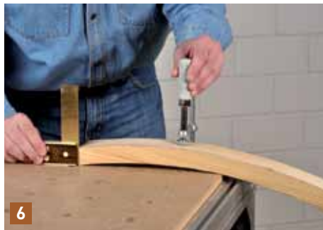
6 Das Ende der Armlehne mit einem Winkel genau auf 90 Grad zur Werkstischfläche ausrichten und in dieser Position mit einer Zwinde fixieren. Die Maschine liegt beim Fräsen ...
