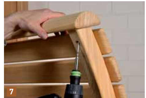
7 Die Abdeckung wird einfach mit je einer entsprechend langen Schraube befestigt. Auch hier unbedingt vorbohren und diesmal großzügig versenken.
