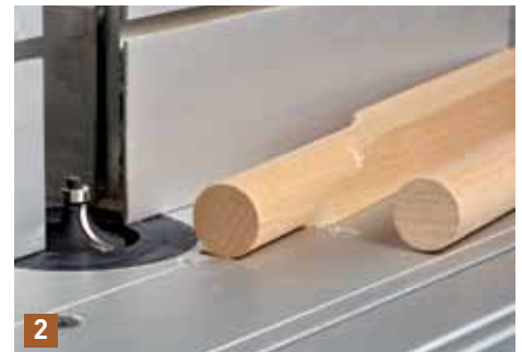
... und eine mit 20 mm Querschnitt, sowie einen Abrundfräser mit 15 und einen mit 10 mm Radius. Dann einfach nacheinander alle vier Kanten am Anschlag vorbei schieben.
