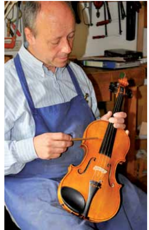
Klopfen und hören beim fertigen Instrument, um Missklänge zu lokalisieren
