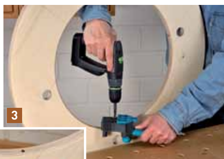
8 mm Dübel sichern die Rundstäbe gegen Verrutschen und stabilisieren die Räder miteinander. Dazu bohren Sie einfach ...
