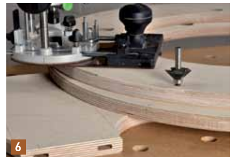
Abrunden oder Abfasen ist reine Geschmacksache, beides ist möglich und sorgt für „entschärfte Kanten“, die bei Kinderspielzeug Pflicht sind!
