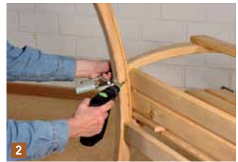
2 ... Schluss alle Bretter mit 4,5 mm dicken Schrauben in der passenden Länge fest. Legen Sie 9 mm dünne Holzstreifen zwischen jedes Brett, damit der Zwischenraum gleich bleibt.
