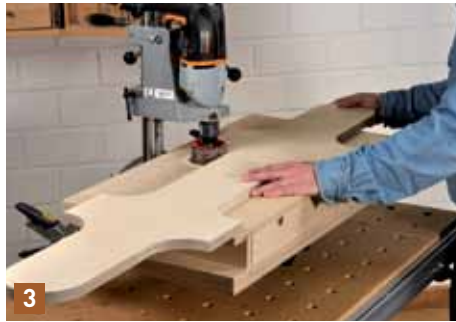
Den Sägeschnitt an den Sitzkanten glätten Sie am besten mit einer Schleifhülse, die Sie einfach in einer Bohrmaschine im Bohrständer betreiben.
