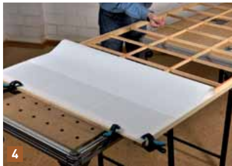
4 ... und fixieren Sie das Papier dann mit ein paar Federzwingen am oberen Querrahmen. Schlagen Sie das Papier zurück und ziehen Sie nur die Schutzschicht von der unteren Quersprosse ab.
