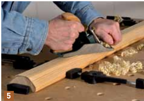
5 Die halbrunde Abdeckung wird zuerst auf einer Tischkreissäge an den Seiten auf 45° abgeschrägt. Der Rest wird dann mit einem Putzhobel gleichmäßig rund gehobelt.
