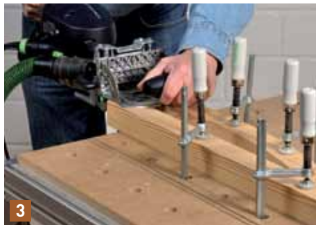
3 Auch für die Stirnfräsungen legen Sie einfach zwei Teile nebeneinander, damit Sie eine bessere Auflage erhalten und visieren die Markierungslinie wieder über das ...
