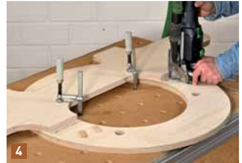
Zeichnen Sie die Position des Sitzbretts genau an und spannen Sie es auf dem Rad fest. Fräsen Sie danach erst senkrecht je zwei 6 x 40 mm DOMINO Dübel ins Rad (Frästiefe nur 15 mm!!!).
