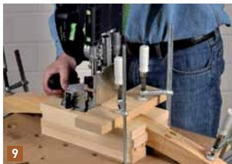
9 Seitlich neben die Rückenlehne legen Sie mehrere Leisten aufeinander bis die Höhe der Rückenlehne erreicht ist. Eine weitere Leiste wird quer und genau rechtwinklig darüber ...
