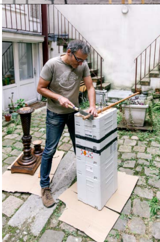
Bild: Festool_ParisCityMobility-05-Cichowicz.jpg Die Systainer erweisen sich gestapelt als geniale „Werkbank“. Das zu bearbeitende Rundholz kann Genty mit Schraubzwingen auf der gelochten MDF-Arbeitsfläche fixieren.
