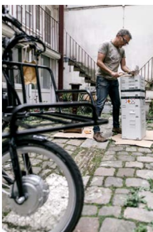
Bild: Festool_ParisCityMobility-06-Cichowicz.jpg Die Systainer erweisen sich gestapelt als geniale „Werkbank“. Das zu bearbeitende Rundholz kann Genty mit Schraubzwingen auf der gelochten MDF-Arbeitsfläche fixieren.
